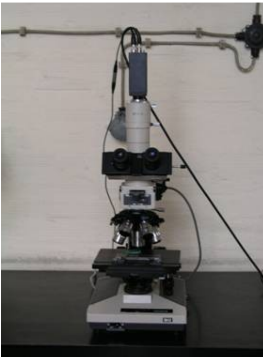
Slika 4.4.2.1 Olympus svjetlosni mikroskop sa CCD kamerom
