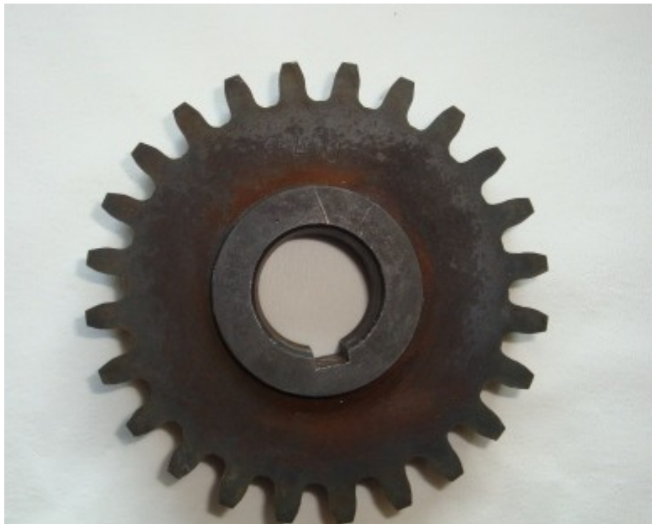
Slika 4.1.1.3. Izgled zupčanika nakon toplinske obrade
