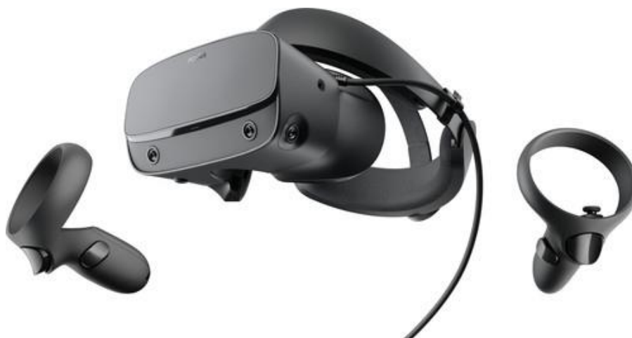
Slika 15. Oculus Rift S i njegovi kontroleri
