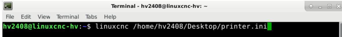
Slika 36 Naredba za pokretanje simulacije 3D tiskača
