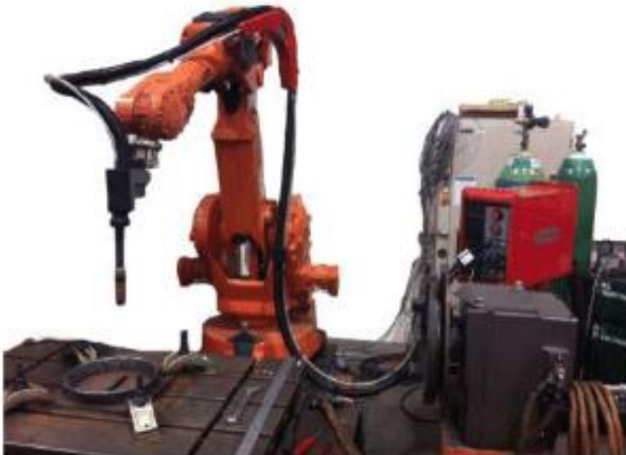
Slika 8. Robot za zavarivanje sa šest osi gibanja [6]
