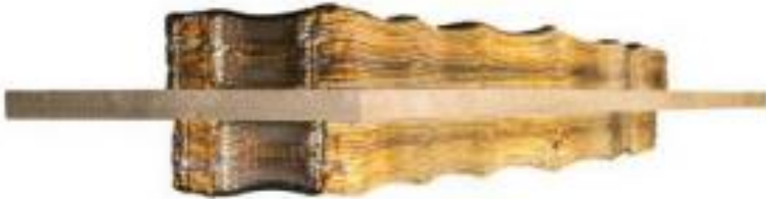
Slika 11. Back to back način WAAM postupka [6]
