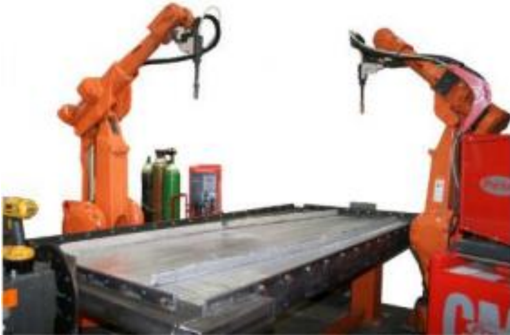
Slika 13. Izrada rebra za krilo [6]
