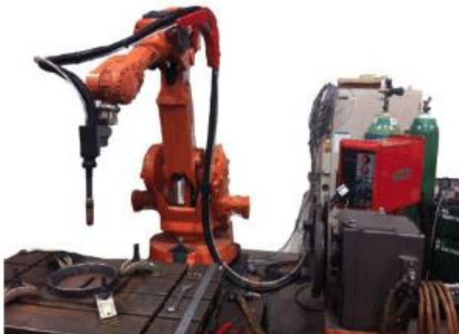
Slika 8. Robot za zavarivanje sa šest osi gibanja [6]
