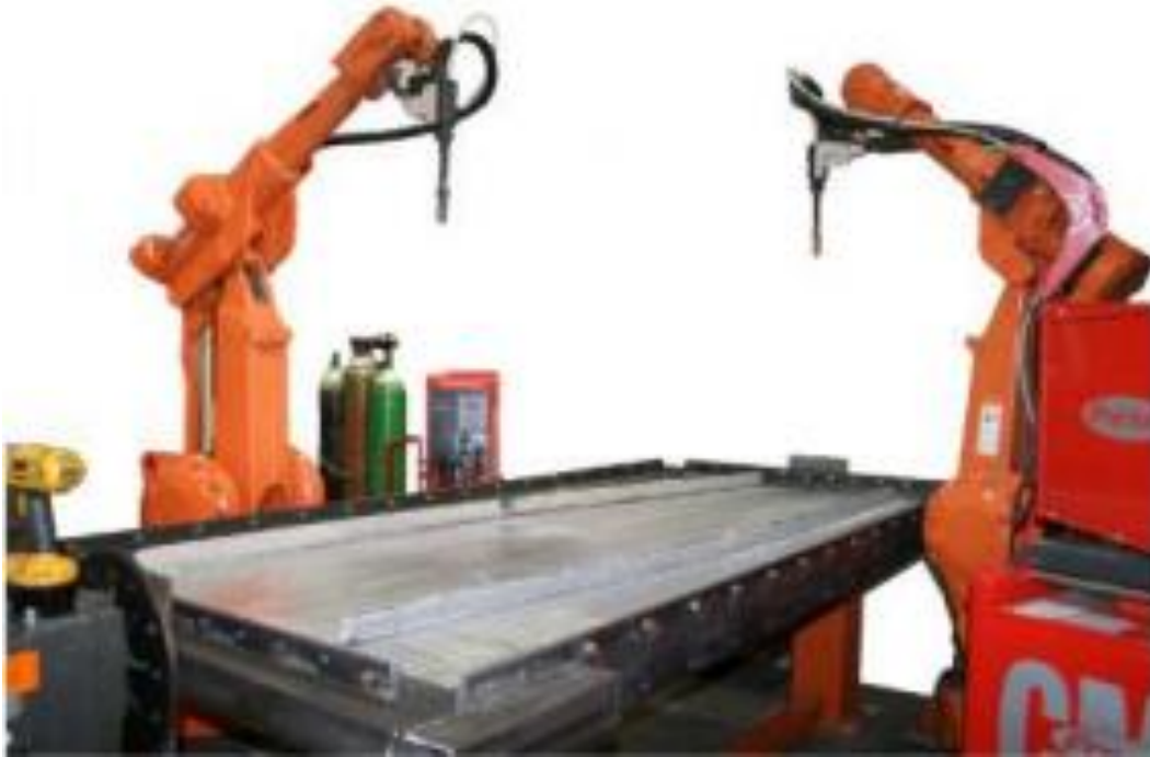
Slika 13. Izrada rebra za krilo [6]
