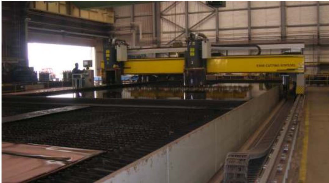
Slika 9. Stroj za rezanje limova plazmom
