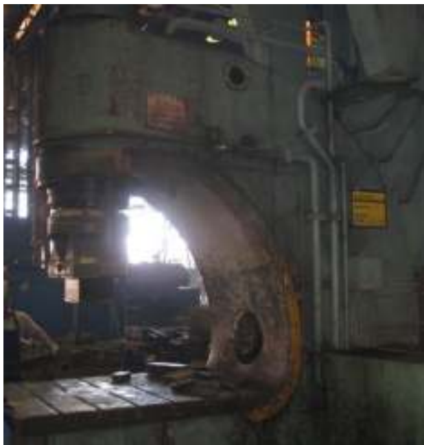
Slika 15. G preša za oblikovanje limova
