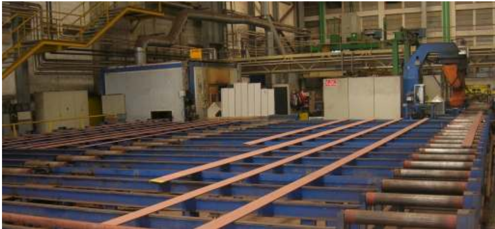
Slika 12. Robotska ruka za rezanje acetilenom i kisikom (oxy) desno i kućište plazma robotske ruke lijevo
