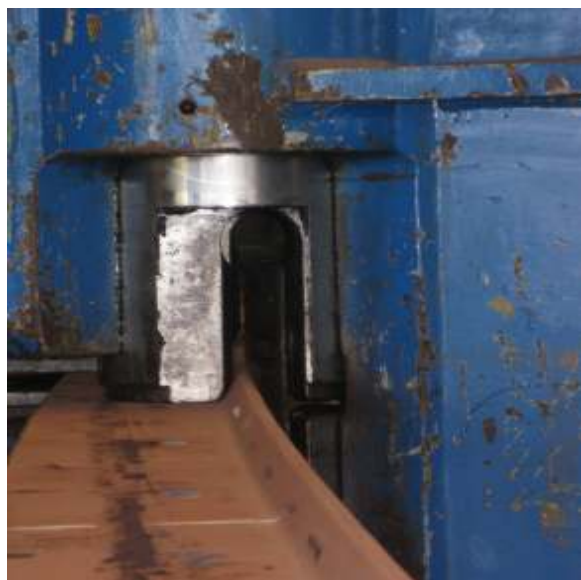
Slika 16. Preša za savijanje profila metodom uzdužnog pomaka
