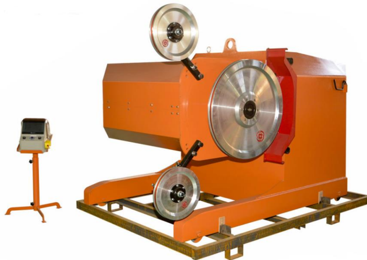
Slika 6. Stroj za eksploataciju kamena [5]
