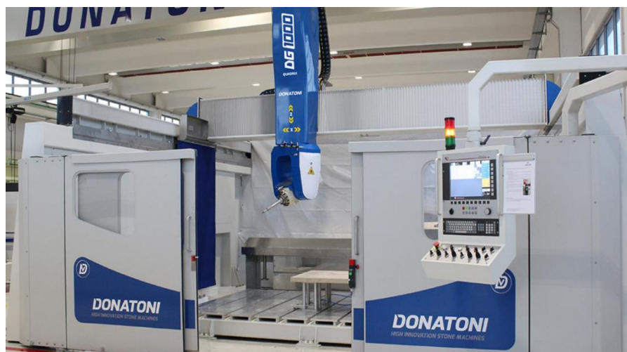
Slika 9. CNC glodaći obradni centar [9]
