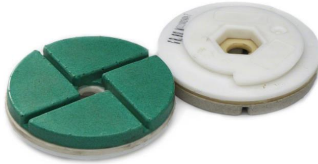
Slika 10. Alat za poliranje s polimernim prevlakama [11]
