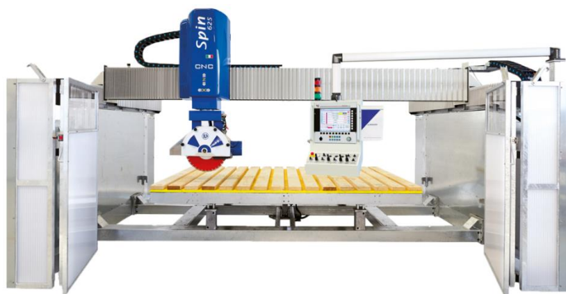
Slika 8. Portalni stroj za rezanje kamena [8]
