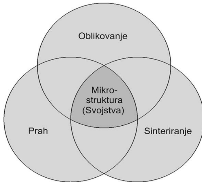
Slika 3.2. Faktori koji utječu na mikrostrukturu i svojstva keramičkih proizvoda [9]
