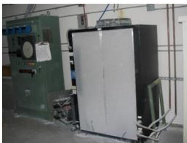
Slika 4.3. Uređaj za kontrolu temperature u peći
