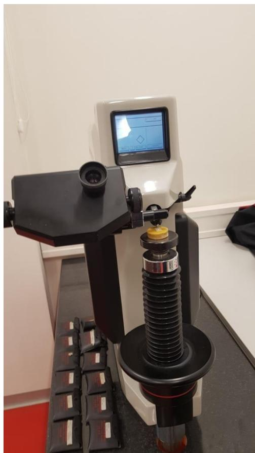
Slika 4.9. Mikrotvrdomjer *Indetec*
