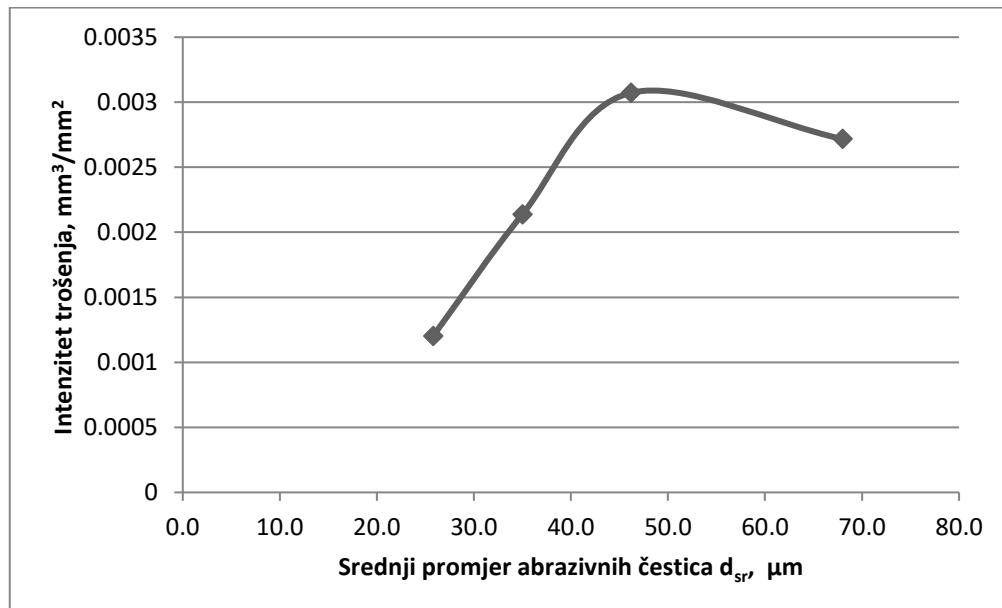
Slika 4.16. Ovisnost intenziteta trošenja o veličini abrazivnih čestica
