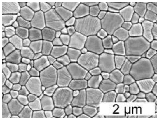
Slika 3.1. Mikrostruktura keramike na bazi aluminijevog oksida ( $\alpha\text{-Al}_2\text{O}_3$ ) [10]
