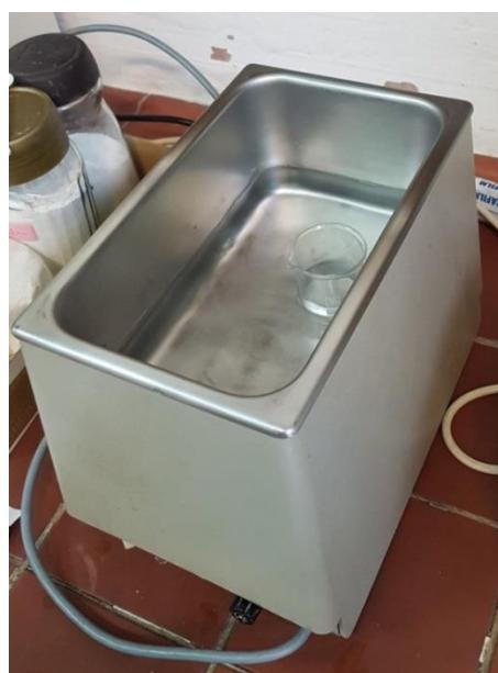
Slika 4.11. Ultrazvučna kupka
