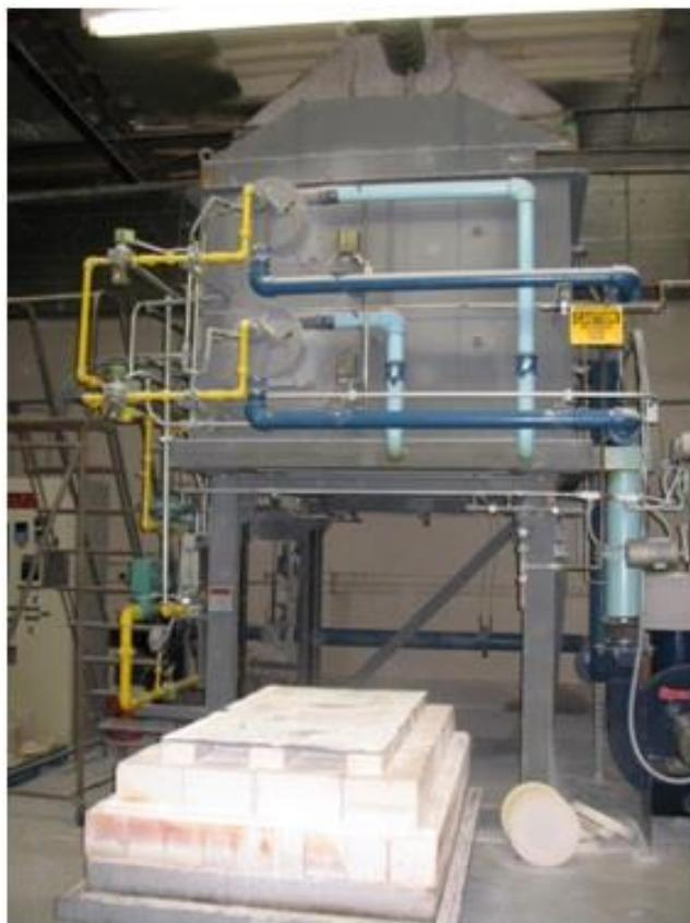
Slika 4.2. Peć za sinteriranje
