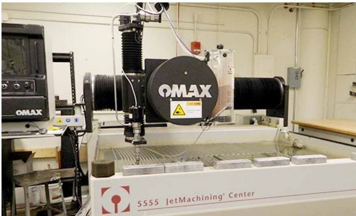
Slika 8. Sustav za obradu vodenim mlazom [13]
