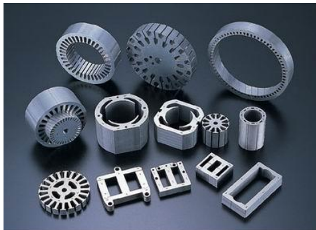
Slika 29. Dijelovi izrađeni primjenom WEDM postupka [30]
