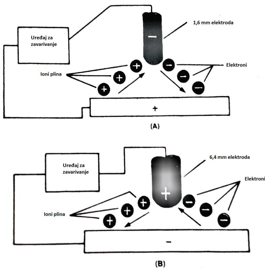
Slika 7. A) Negativni polaritet; B) Pozitivni polaritet [1]
