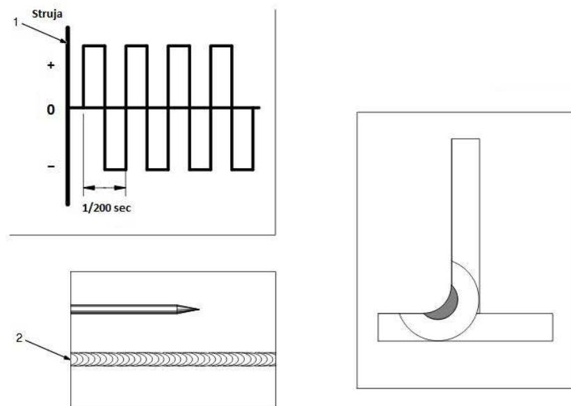
Slika 10. Zavar izveden sa  $f=200 \text{ Hz}$  [7]
