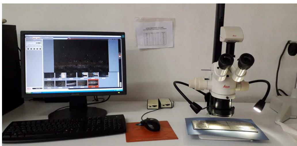
**Slika 34. Stereo mikroskop LEICA MZ6**
