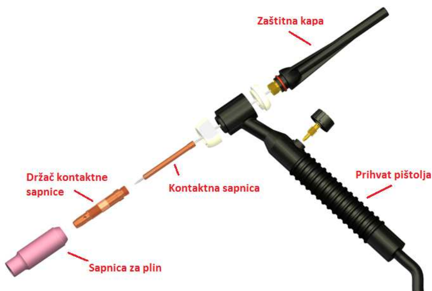
Slika 11. TIG pištolj sa pripadajućim dijelovima [9]
