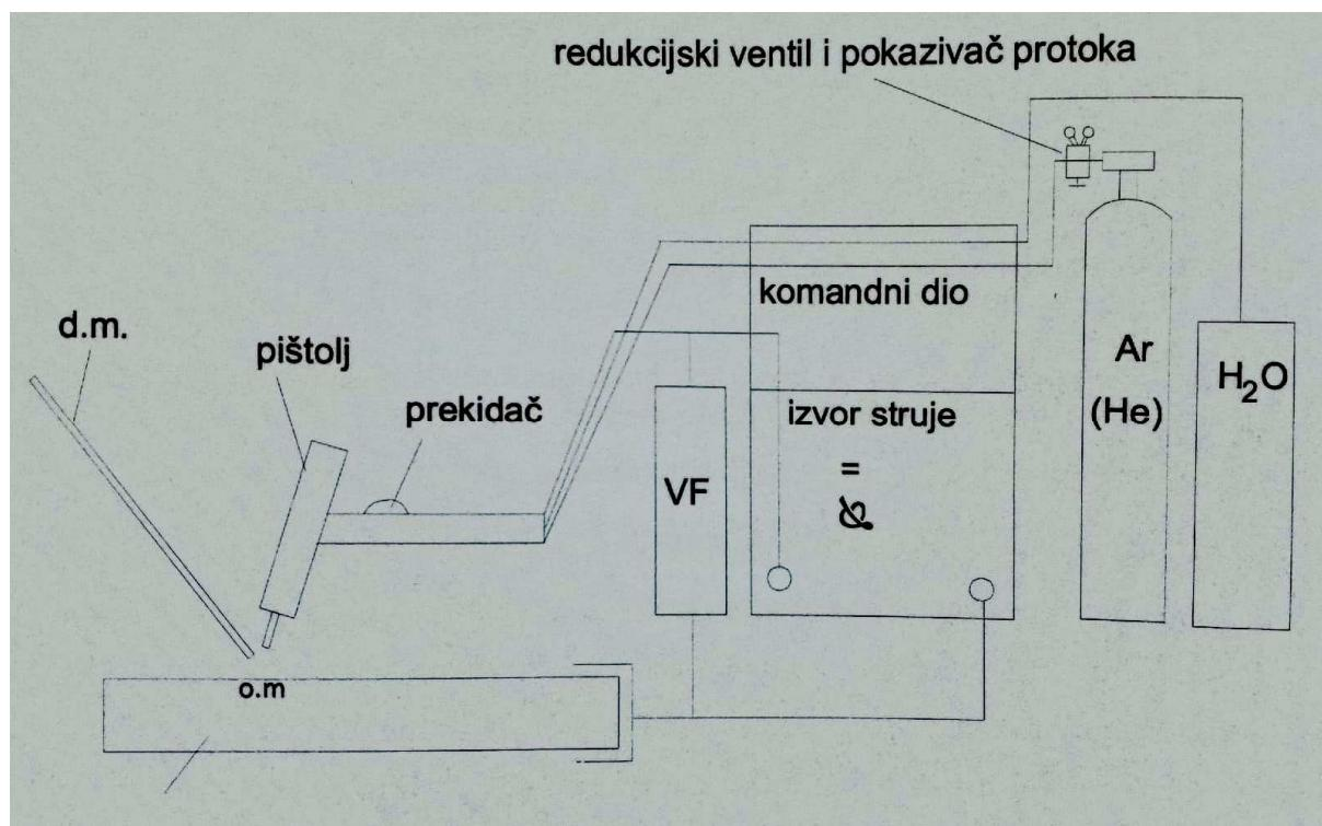
Slika 6. Shematski prikaz uređaja za TIG zavarivanje [4]
