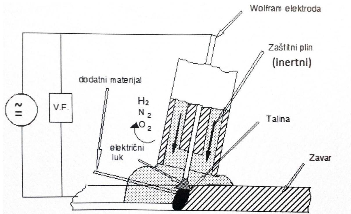
Slika 1. Shematski prikaz TIG postupka zavarivanja [4]
