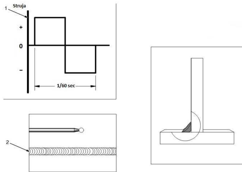
Slika 9. Zavar izveden sa  $f=60 \text{ Hz}$  [7]
