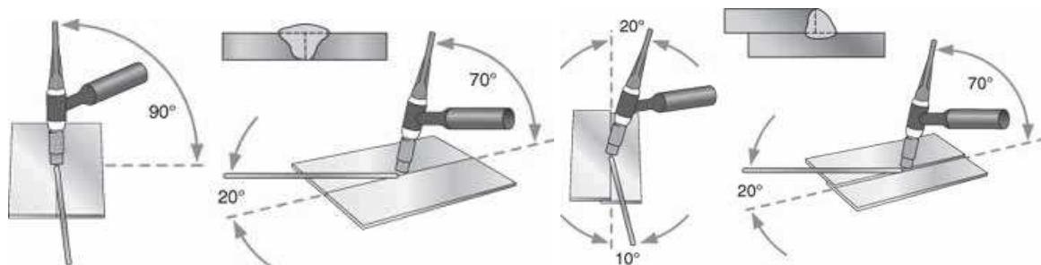
**Slika 4.** Izvođenje sučeonog (lijevo) i preklopnog spoja(desno) [6]
