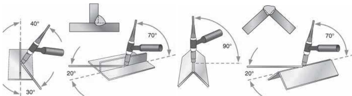
Slika 5. Izvođenje kutnog (lijevo) i rubnog spoja (desno) [6]
