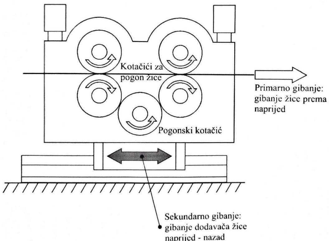
Slika 19. Shematski prikaz gibanja koje ostvaruje dodavač žice [13]
