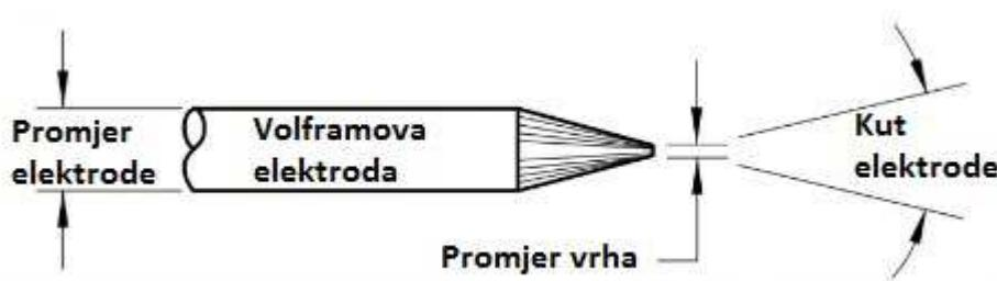
**Slika 13. Geometrija elektrode [12]**
