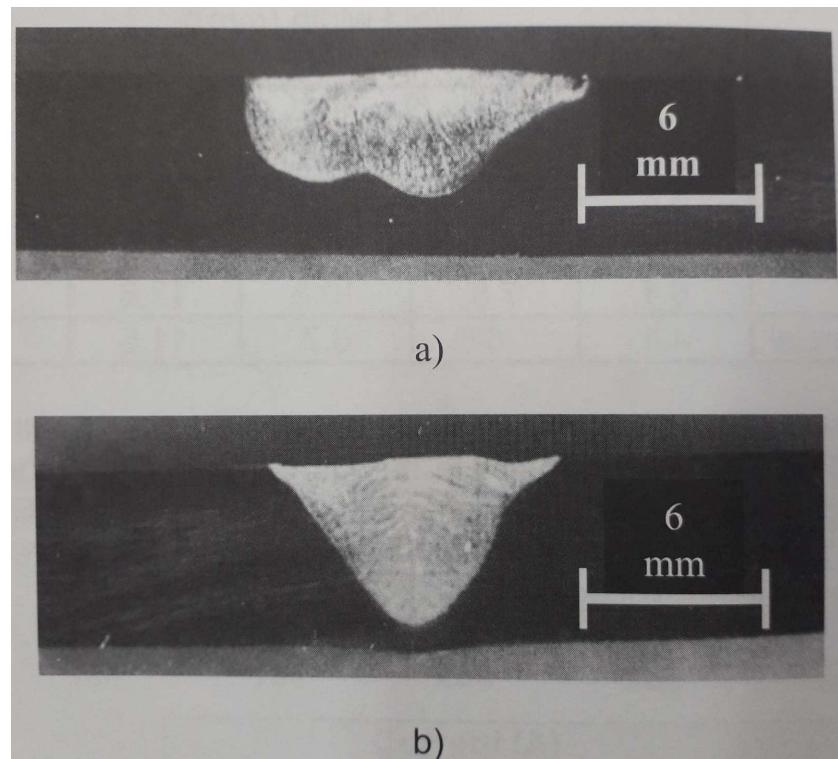
**Slika 21. Poprečni presjek zavara izvedenih strujom 300 A; a) bez premaza; b) sa  $\text{TiO}_2$  premazom [15]**
