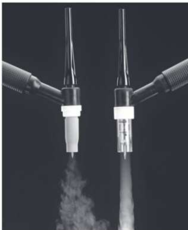
Slika 12. Plinska sapnica bez mrežice (lijevo) i sa mrežicom (desno) [10]
