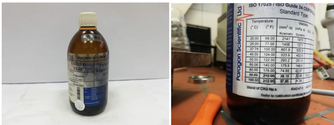
Slika 14. Kontrolni uzorak loživog ulja za kalibraciju
