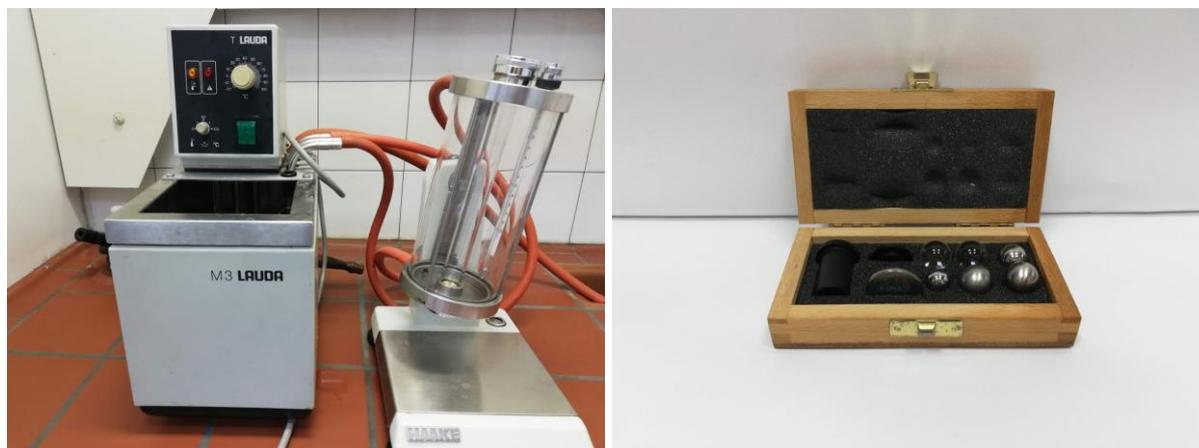
*Slika 17. Höpplerov viskozimetar s pripadajućim kuglicama*
