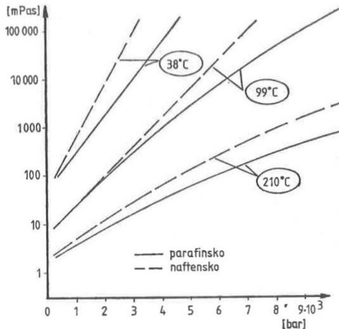
Slika 5. Ovisnost viskoznosti mineralnih ulja o tlaku [3]
