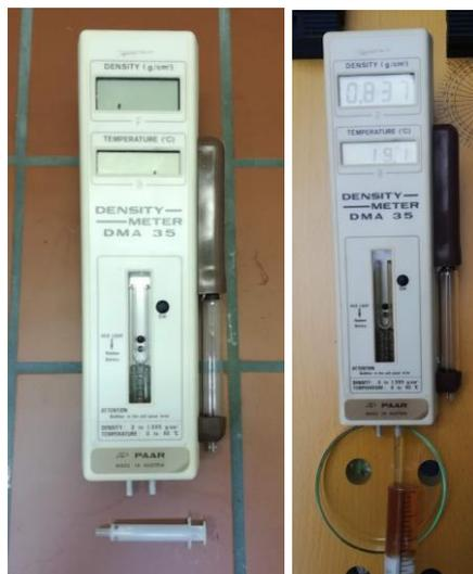
*Slika 18. Prijenosni mjerjač gustoće DMA 35 i postupak mjerenja*
