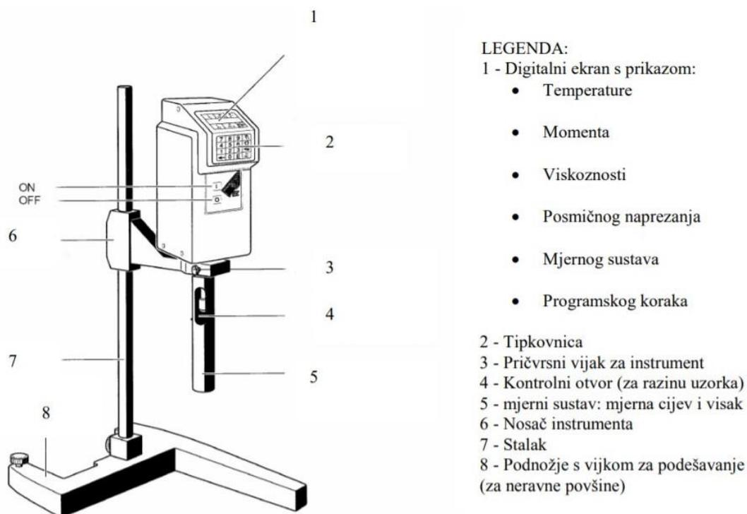
Slika 9. Rotacijski viskozimetar [5]
