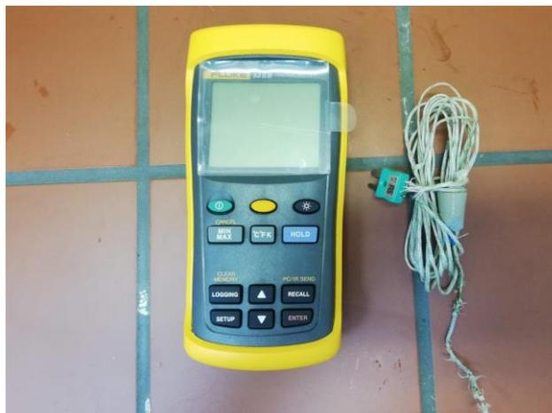
Slika 13. Fluke 53 II B termometar
