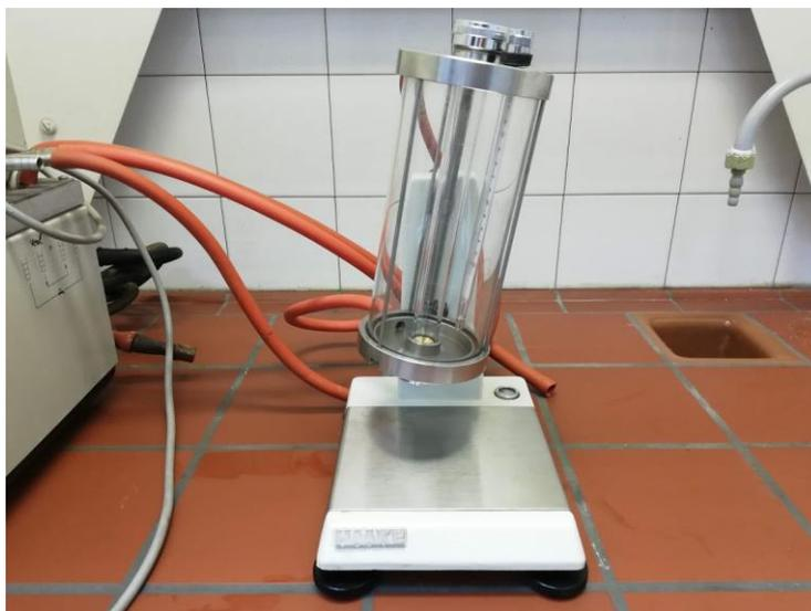
*Slika 8. Höpplerov viskozimetar*
