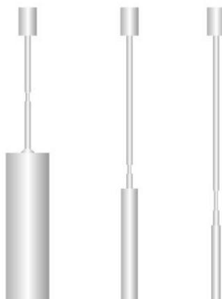
*Slika 11. Cilindrični visak [10]*
