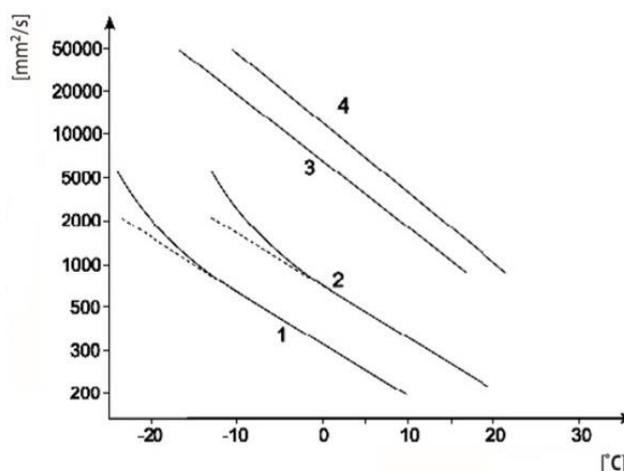
*Slika 4. Odstupanje viskoznosti parafinskih baznih ulja pri niskim temperaturama [1]*
