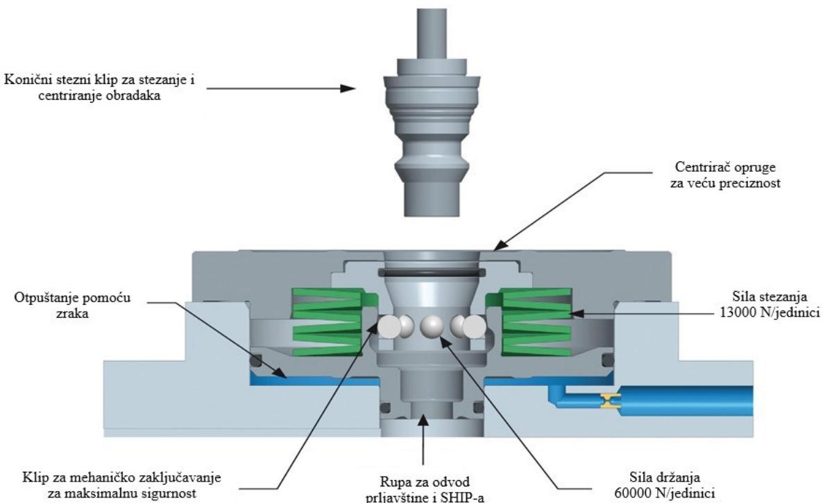
**Slika 10. Stezni mehanizam [12]**
