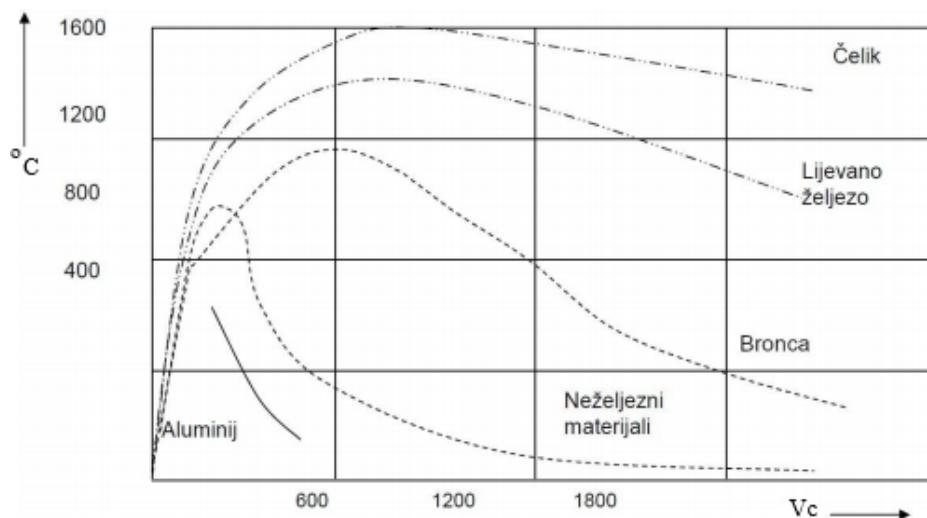
Slika 52. Dijagram ovisnosti temperature o brzini rezanja [27]
