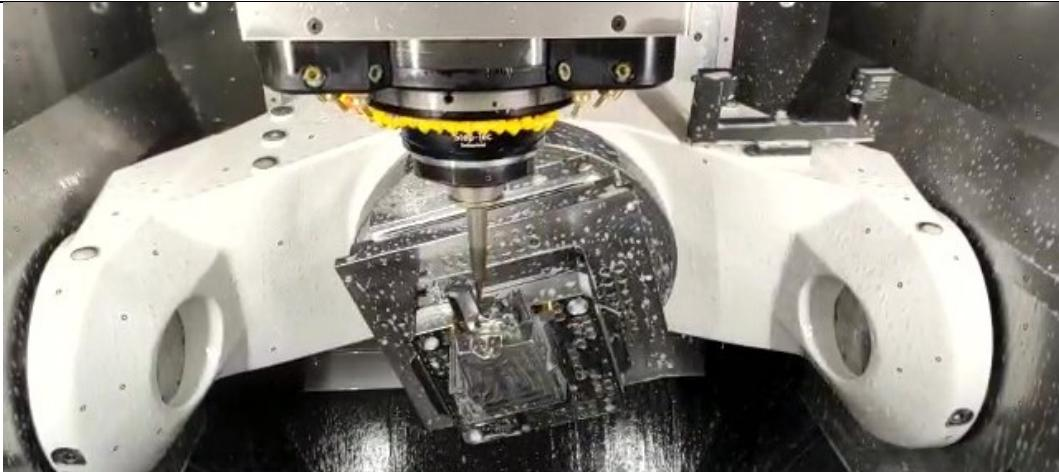
**Slika 45. Simultano kopirno glodanje na 5-osnom obradnom centru**
