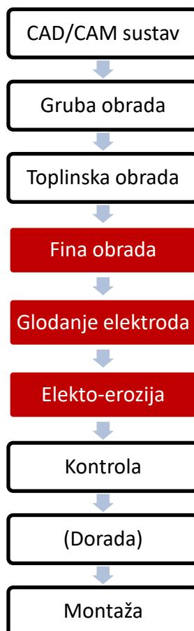
**Slika 64. Algoritam rada FMS-a na primjeru proizvodnje matrica**
