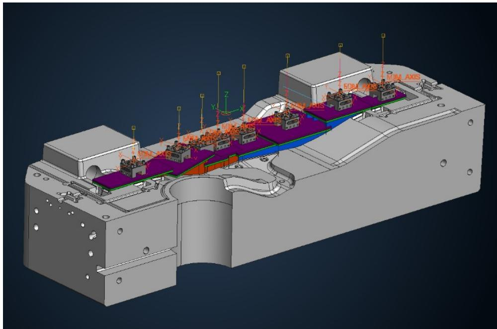
Slika 72. Primjer simulacije erodiranja i pozicije erodiranja
