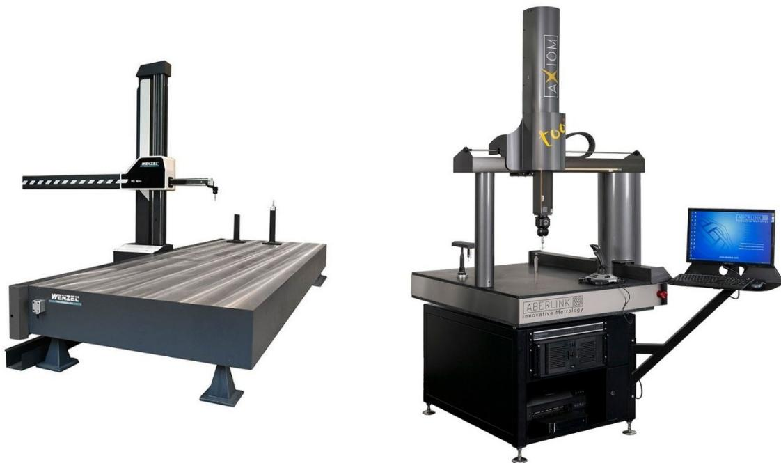
**Slika 33. Koordinatni merni uređaj: horizontalni (lijevo) i vertikalni (desno) [23],[24]**
