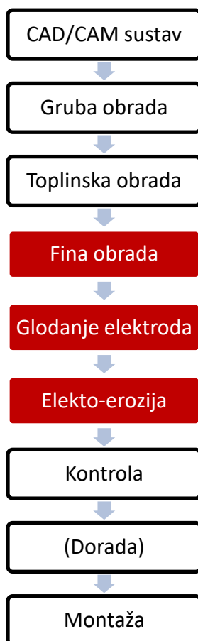
Slika 64. Algoritam rada FMS-a na primjeru proizvodnje matrica
