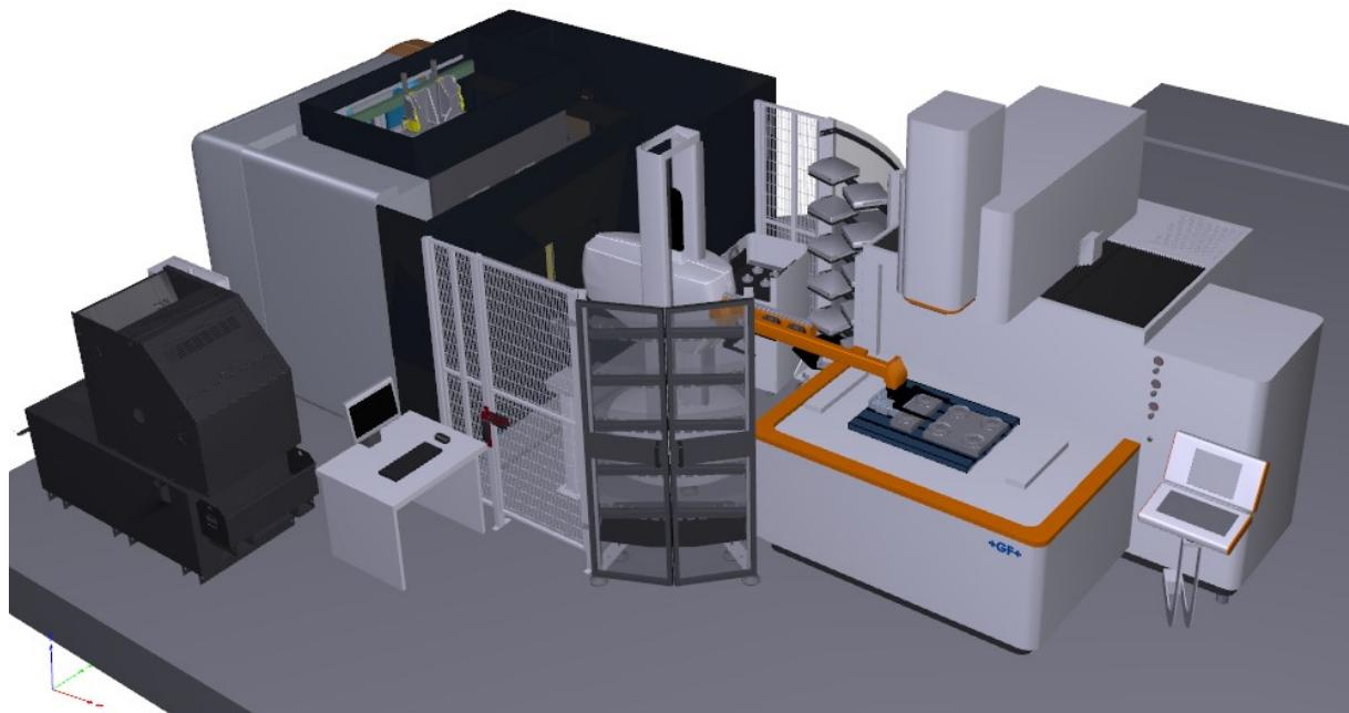
Slika 63. Fleksibilni proizvodni sustav za obradu elektro-erozijom
