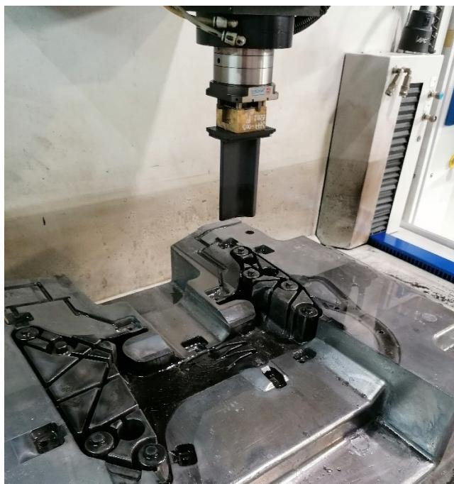
Slika 73. Primjer pozicioniranja prije erodiranja
