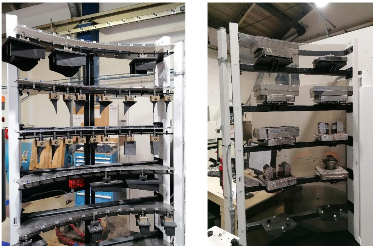
**Slika 71.** Spremiste alata (elektroda) i obradaka
