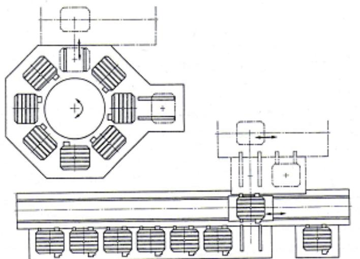
Slika 18. Primjer kružnog (ROTO) i linijskog magazina paleta [11]
