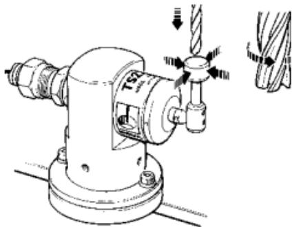
**Slika 30. Mjerenje alata s mirujućim i rotirajućim alatom [22]**
