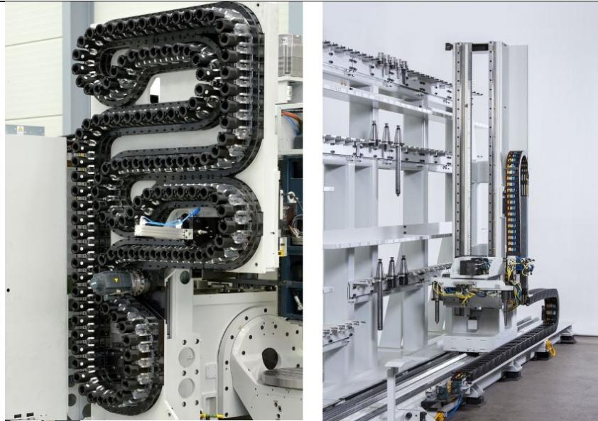
**Slika 28.** Primjeri magazina alata: lančani (lijevo), regalni (desno) [18]
