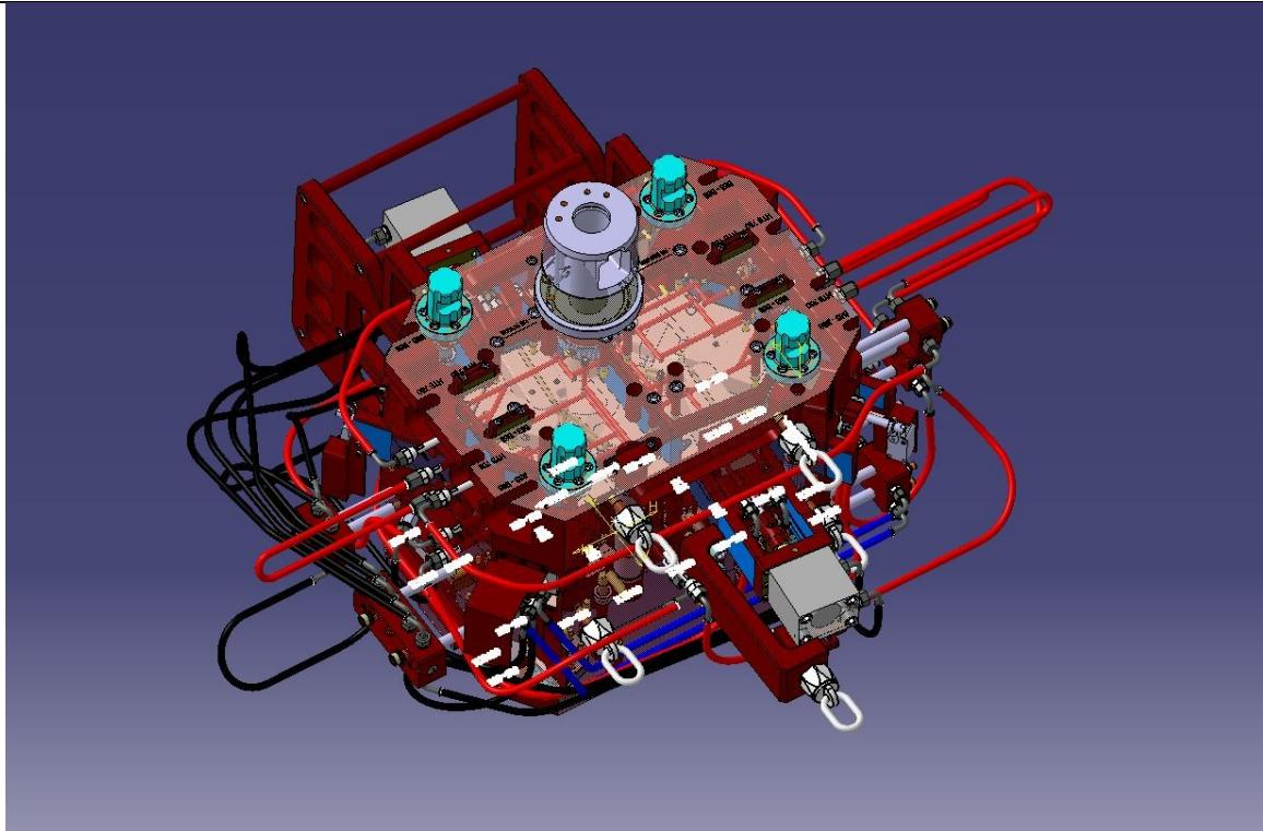
**Slika 41. Model sklopljenog alata za tlačni lijev aluminija**
