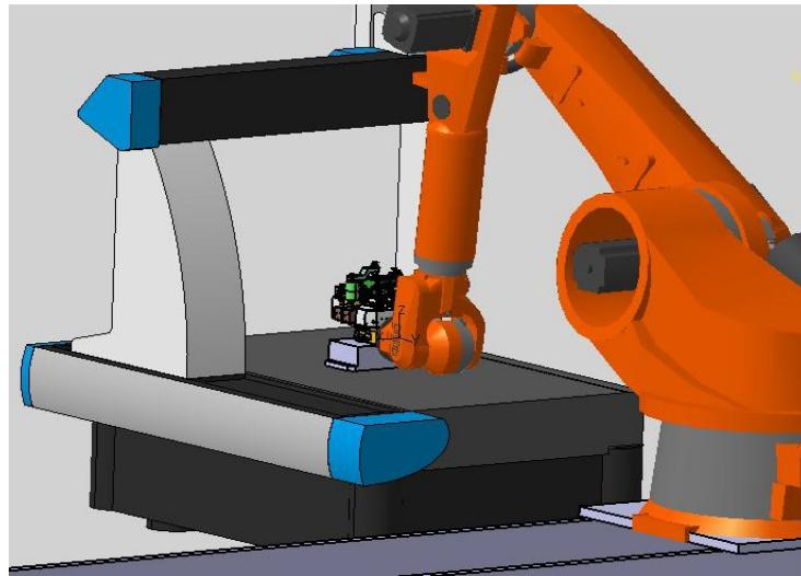
**Slika 36. Primjer postavljanja komada na CMM pomoću robota [1]**
