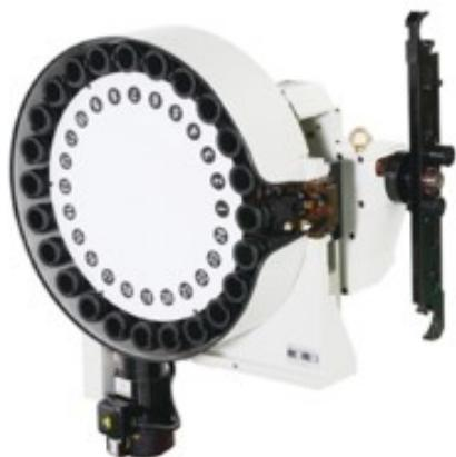
Slika 27. Primjer kružnog magazina alata s polugom [15]
