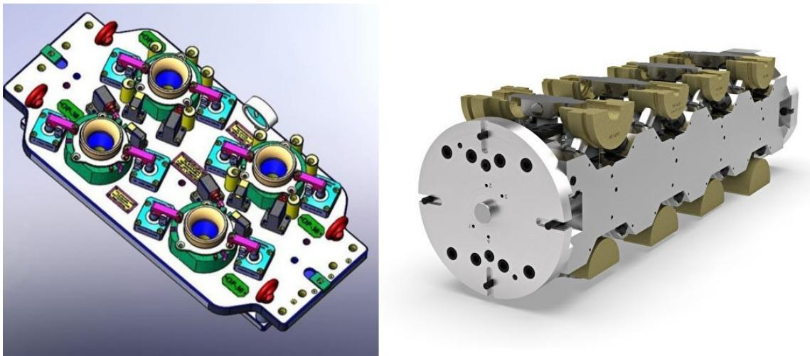
**Slika 6. Primjeri specijalnih steznih naprava [16], [17]**
