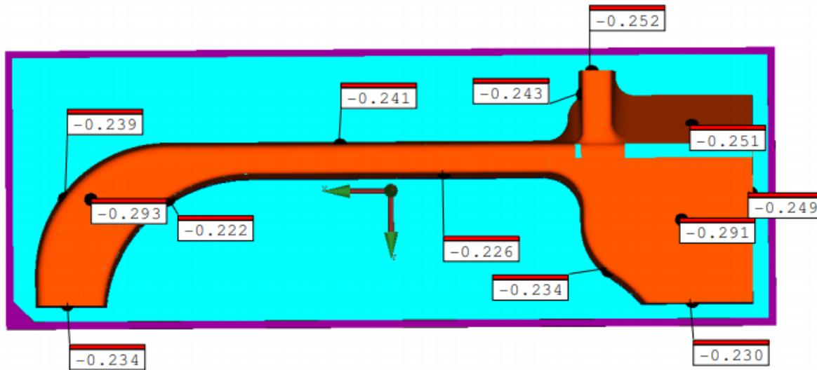
**Slika 35. Primjer mjernog izvještaja s mjerena EDM elektrode**
