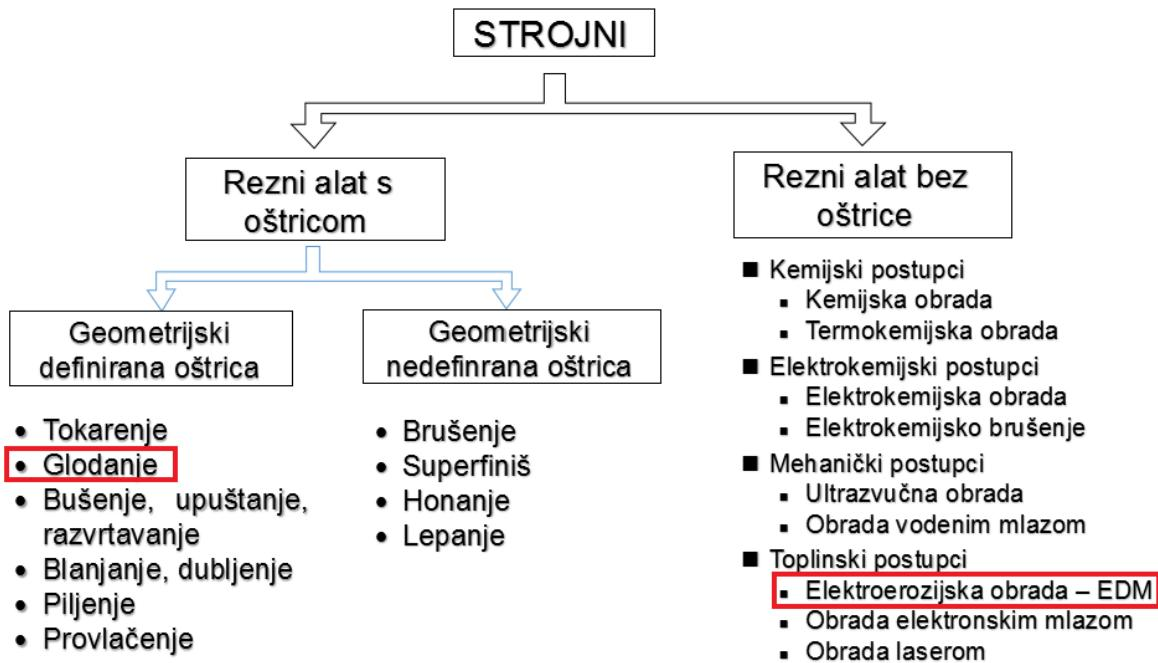
**Slika 43. Podjela strojnih postupaka obrade odvajanjem [26]**
