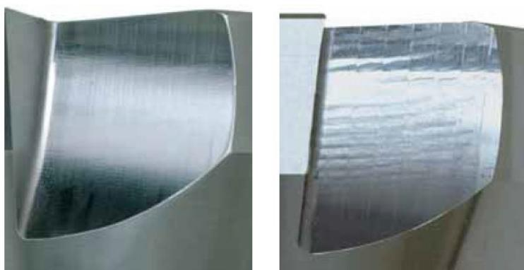
**Slika 17. Obrađena površina s VDP stezniem sustavom (lijevo) i bez (desno) [12]**
