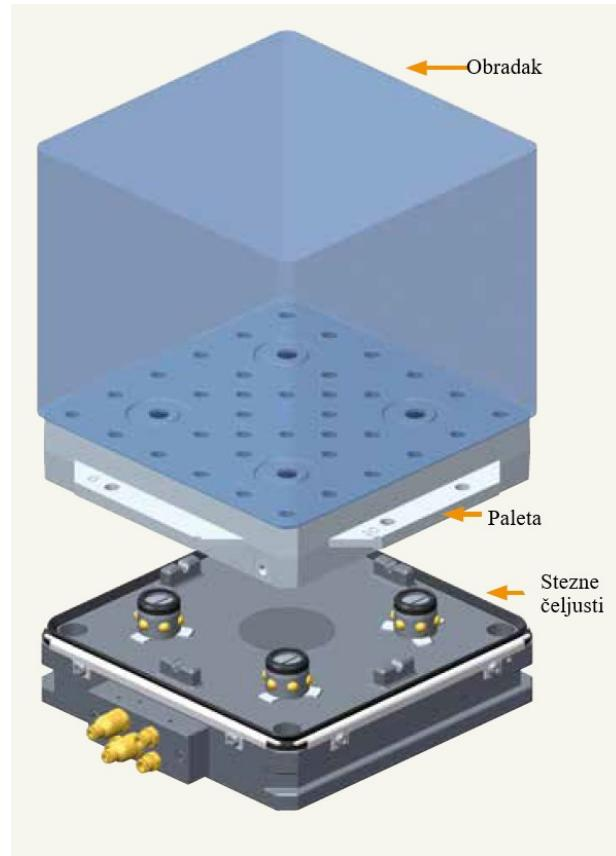
**Slika 14. Referentni sustav GPS 240- prikaz stezanja obratka [12]**
