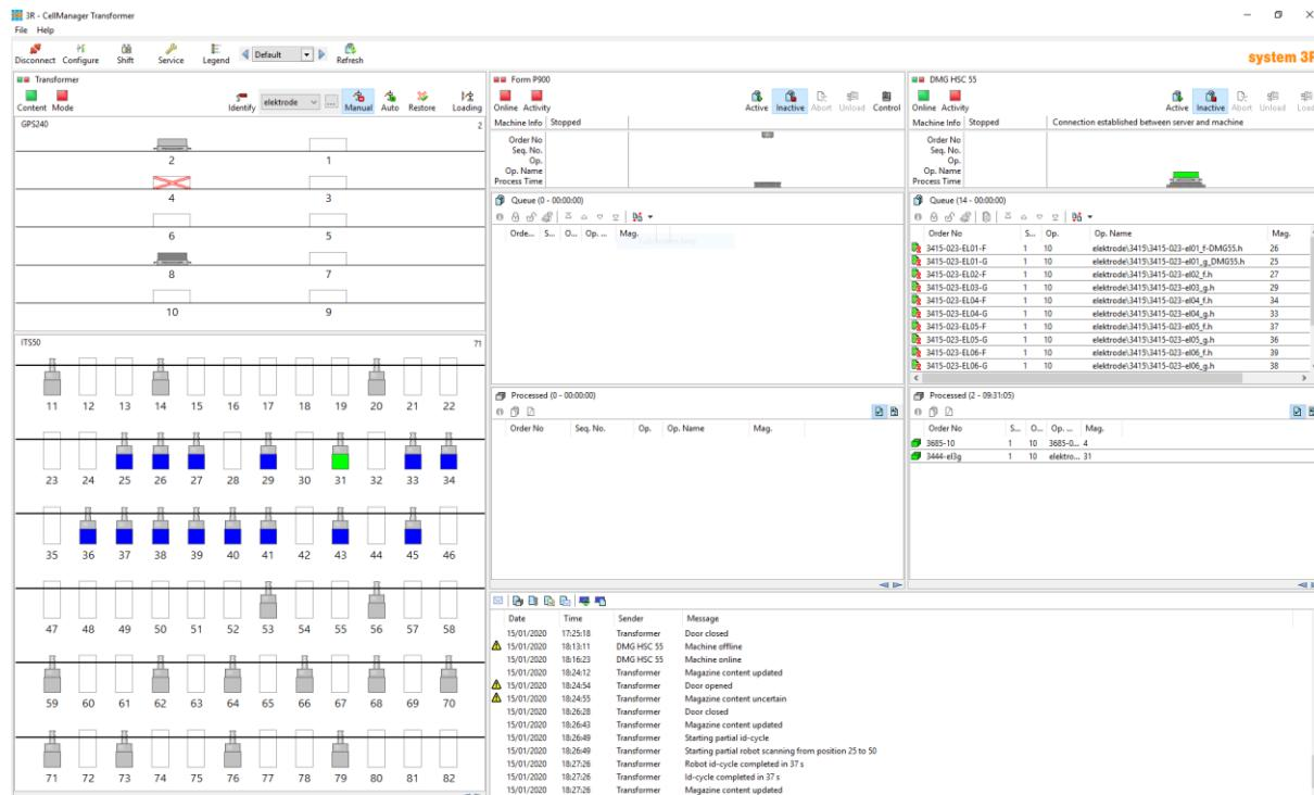
Slika 25. Softver za upravljanjem spremištem obradaka [12]
