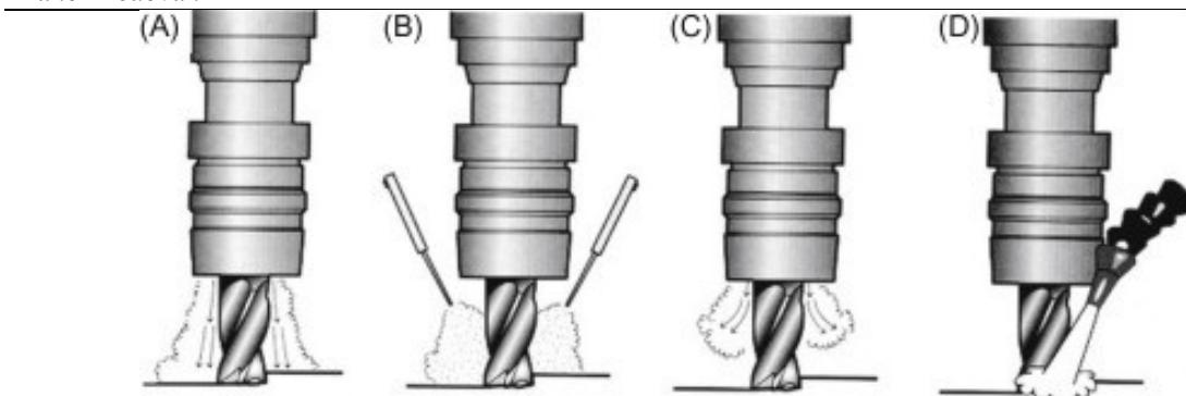
Slika 55. Način dovođenja SHIP-a [31]
