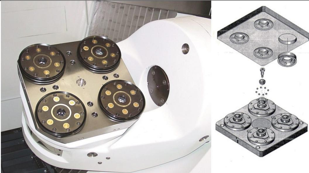
**Slika 9. Stezni sustav s definiranom nul-točkom [11],[12]**
