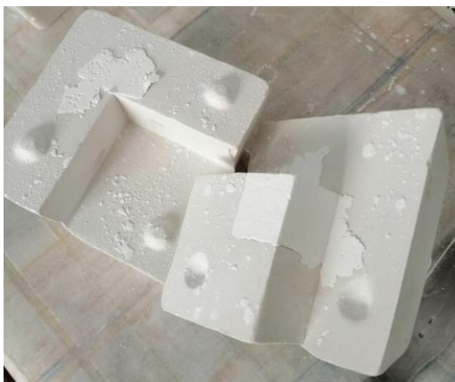
Slika 2. Otvaranje gipsanih kalupa nakon sušenja suspenzije
