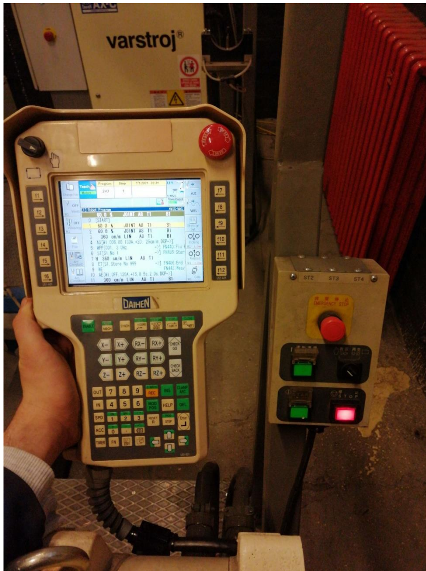
Slika 19. Privjesak za učenje i kontroler AX - C
