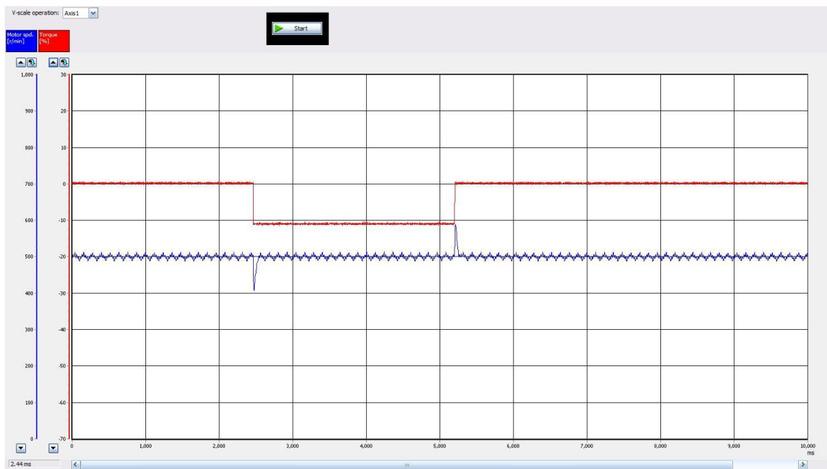
Slika 55. Mjerenje odziva pri 10% nazivnog momenta i 500 o/min
