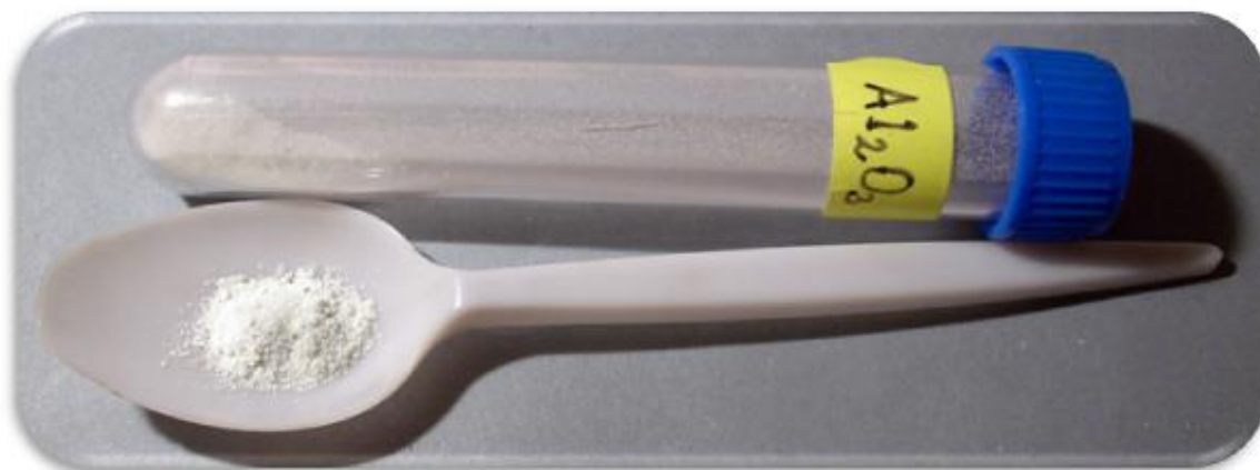
Slika 2.- Aluminijev oksid u praškastom obliku [11]
