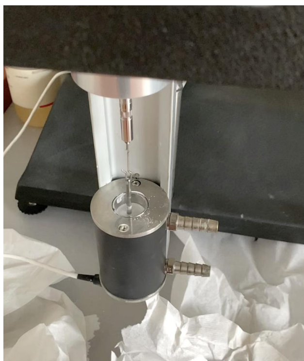
Slika 28. Cilindar sa suspenzijom i vretenom
