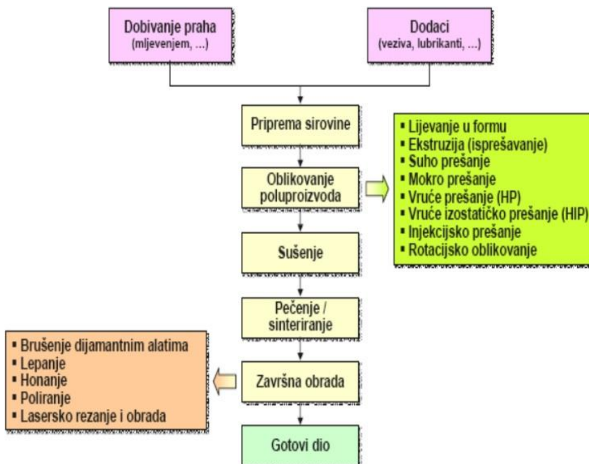
Slika 5 Proizvodni koraci keramike [7]
