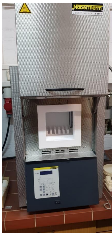
Slika 26. Električna peć za sinteriranje Nabertherm P310
