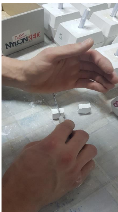
Slika 21. Rezanje uzoraka u zelenom stanju
