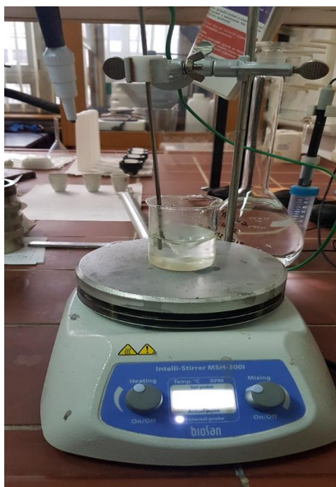
Slika 16. Grijača ploča s magnetskim poljem „Intelli-Stirrer MSH-300i“
