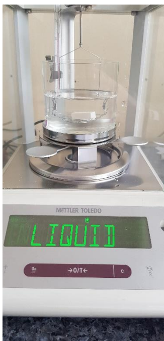
Slika 29. Mjerenje mase uzorka u mediju
