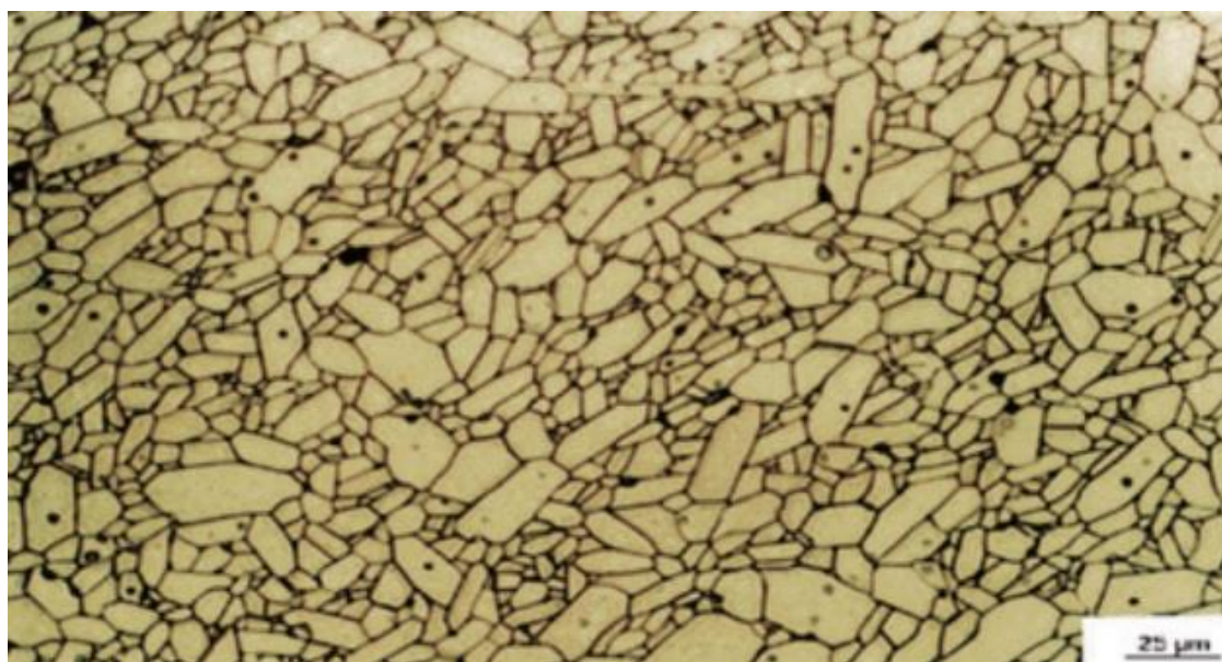
Slika 13. Mikrostruktura \text{Al}_2\text{O}_3 keramike nakon sinteriranja [10]
