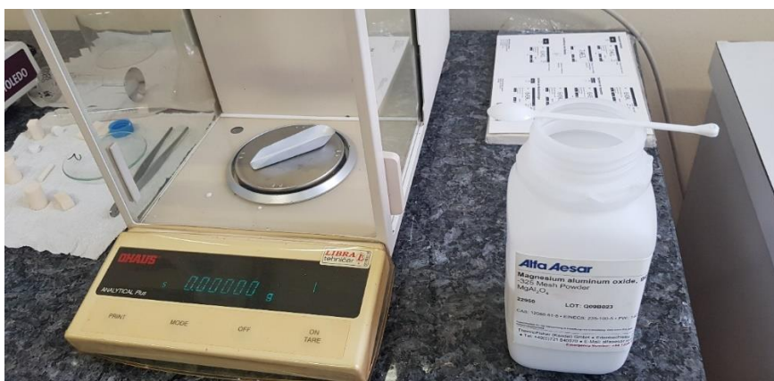
Slika 15. Analitička vaga „Ohaus ANALYTICAL Plus AP250D“
