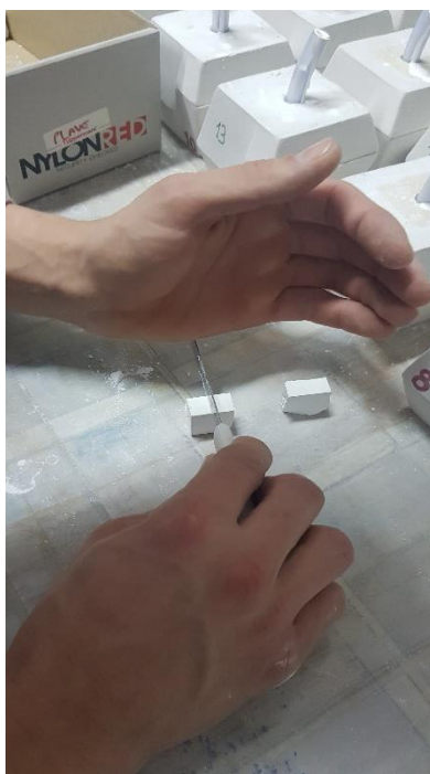
Slika 21. Rezanje uzoraka u zelenom stanju
