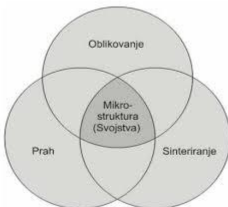
Slika 4. Utjecaji na mikrostrukturu [2]
