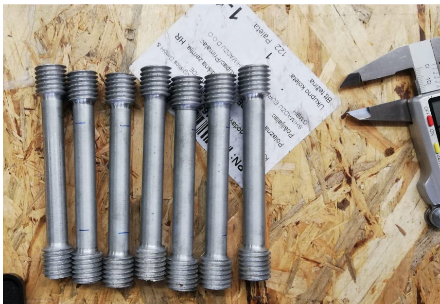
Slika 20. Epruvete za statičko vlačno ispitivanje
