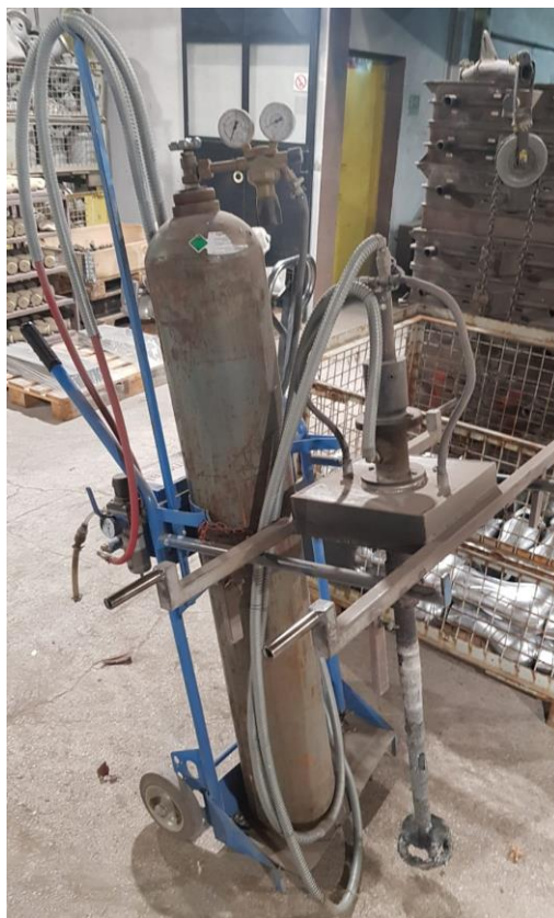
Slika 17. Uređaj za otplinjavanje
