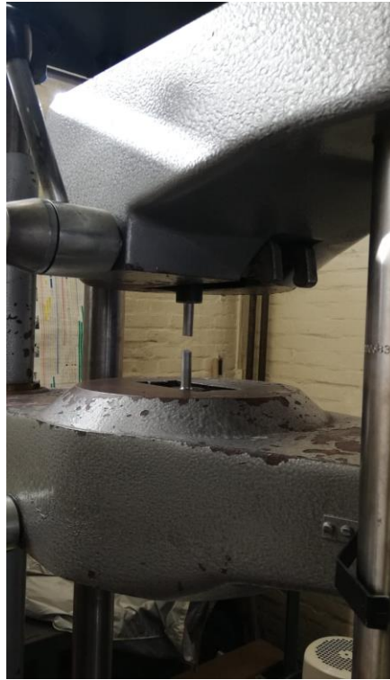
Slika 22. Epruveta stegnuta u čeljusti kidalice
