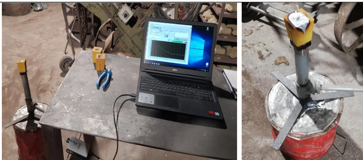
Slika 15. Prikaz uređaja za toplinsku analizu
