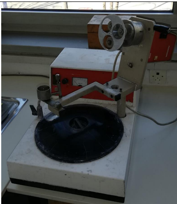
Slika 24. Uređaj za poliranje „Struers DAP – V“
