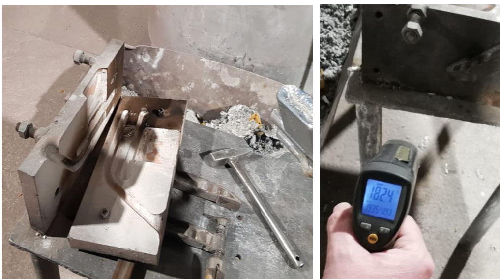
a) b) Slika 11. a) otvorena kokila, b) mjerenje temperature kokile
