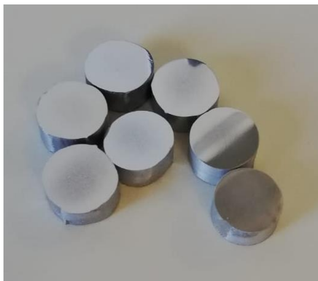
Slika 25. Uzorci za metalografsko ispitivanje
