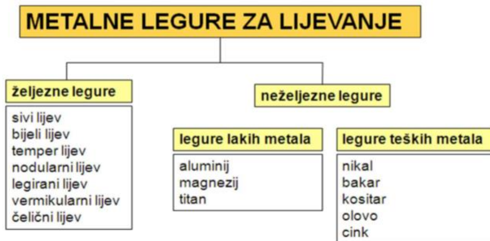
Slika 8. Podjela metalnih legura za lijevanje [2]
