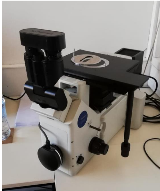
Slika 26. Svjetlosni mikroskop „Olympus GX 51“
