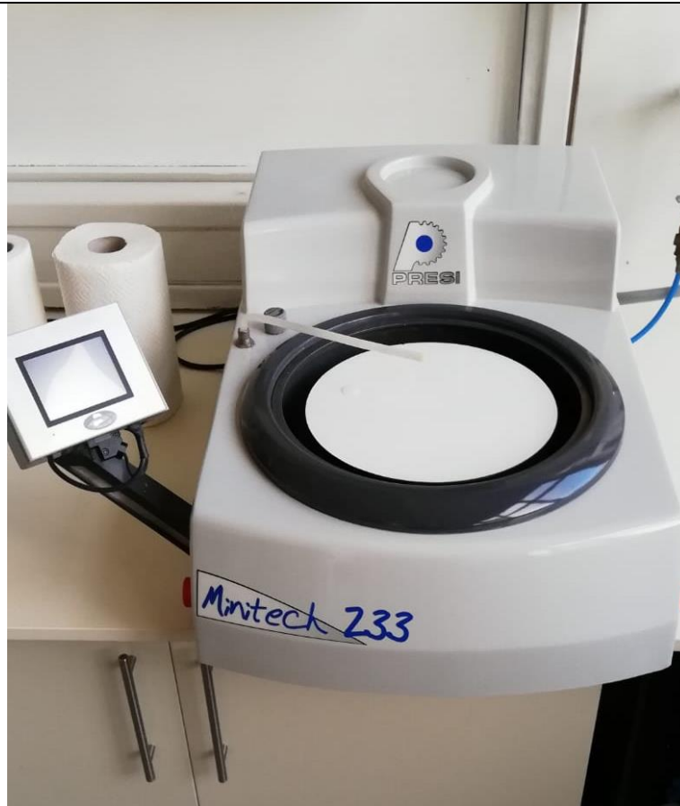
Slika 23. Uređaj za brušenje Minitech 233
