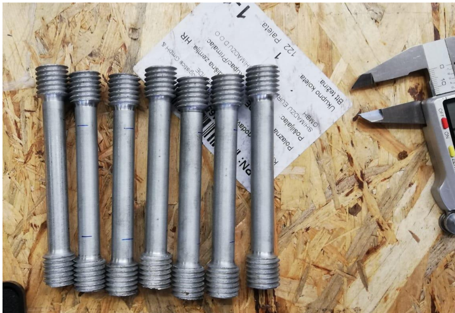
Slika 20. Epruvete za statičko vlačno ispitivanje
