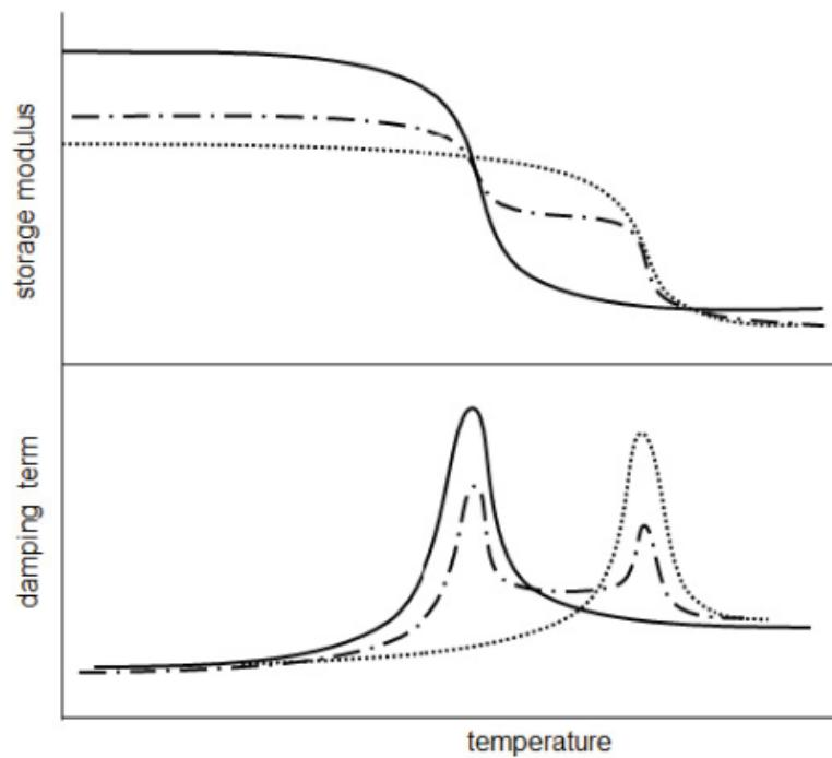
Slika 6.7. Prikaz DMA analize dvaju nekompatibilnih polimera [6]
