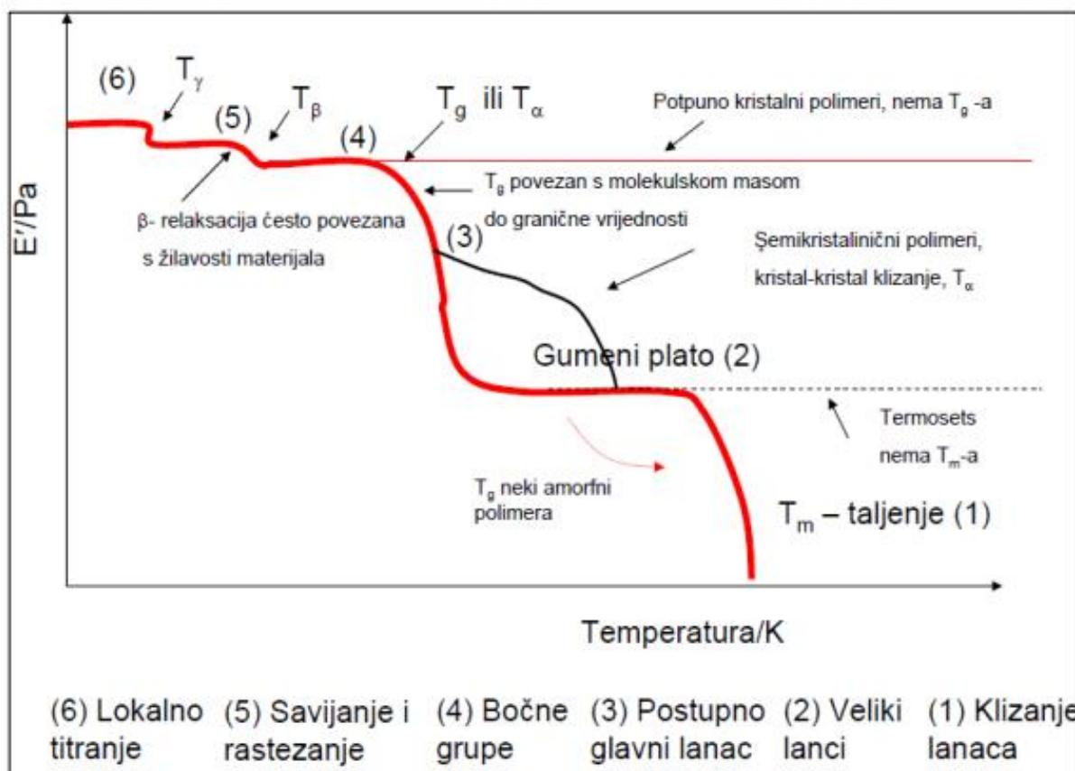
Slika 6.5. Promjene u strukturi dobivene DMA mjeranjem [15]
