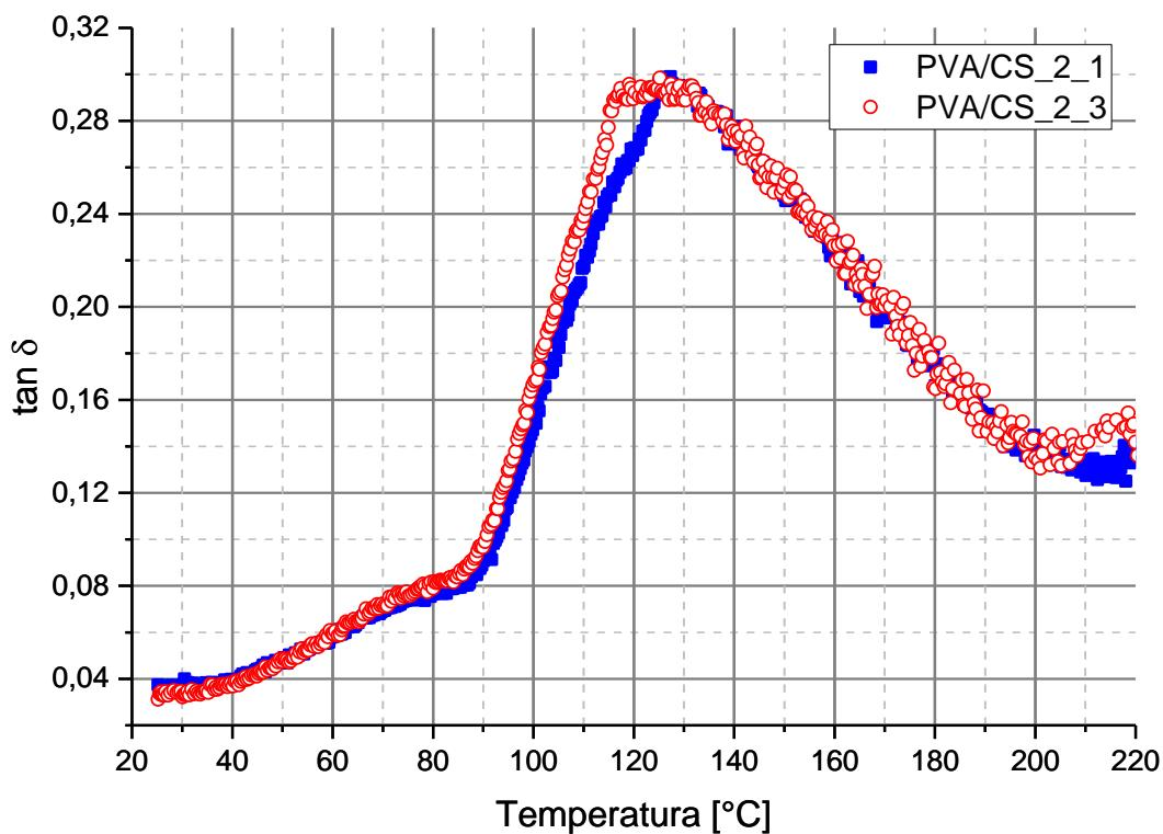
Slika 8.4. Ponovljivost ispitivanja na PVA/CS\_2 uzorku, nakon starenja
