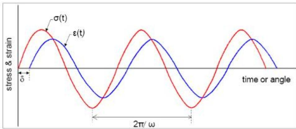
**Slika 6.1. Promjena naprezanja i istezanja s vremenom u viskoelastičnom materijalu [6]**
