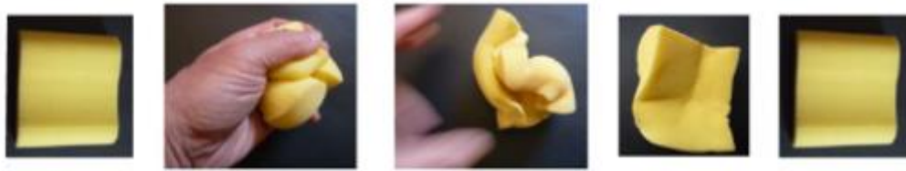
Slika 5.2. Viskoelastičnost memorijske pjene [6]
