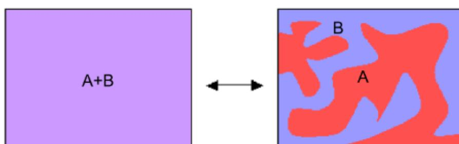
Slika 4.1. Mješljiva (lijevo) i nemješljiva (desno) polimerna mješavina [14]
