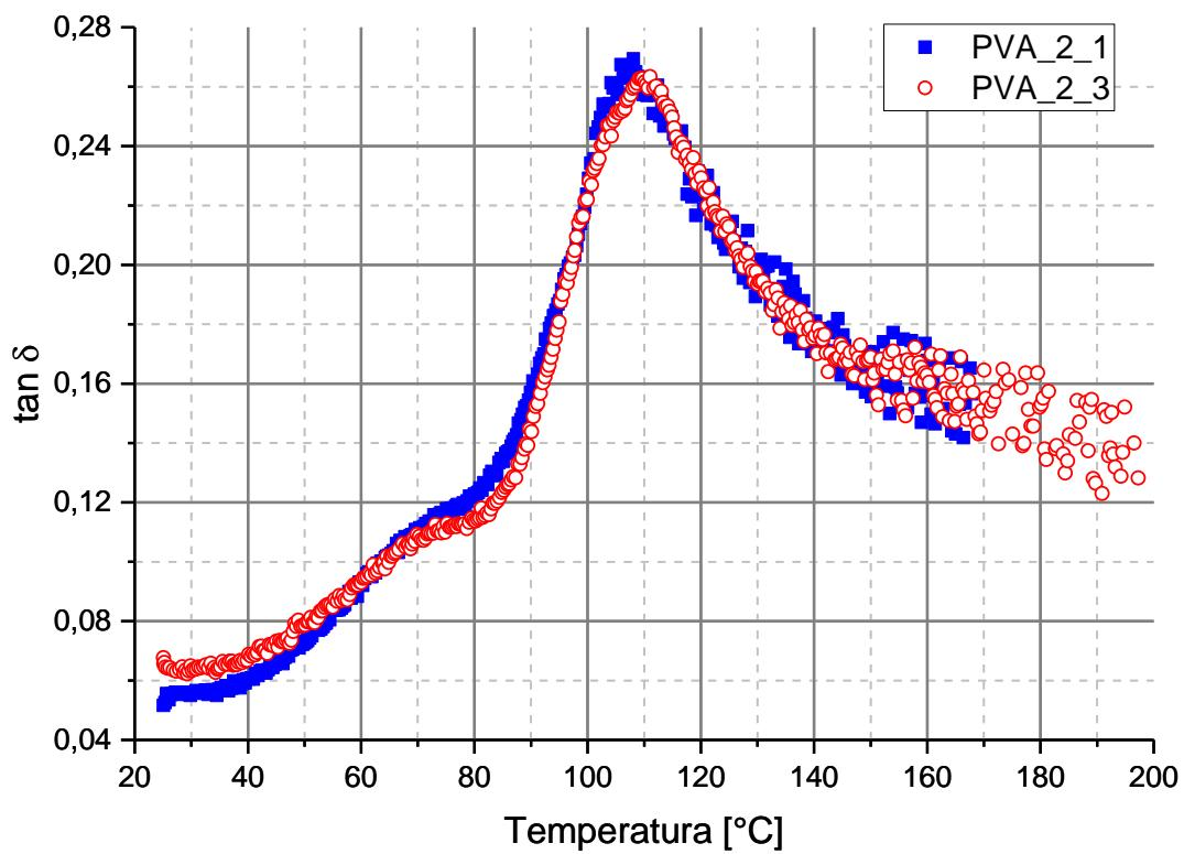
Slika 8.2. Ponovljivost ispitivanja na PVA\_2 uzorku, nakon starenja
