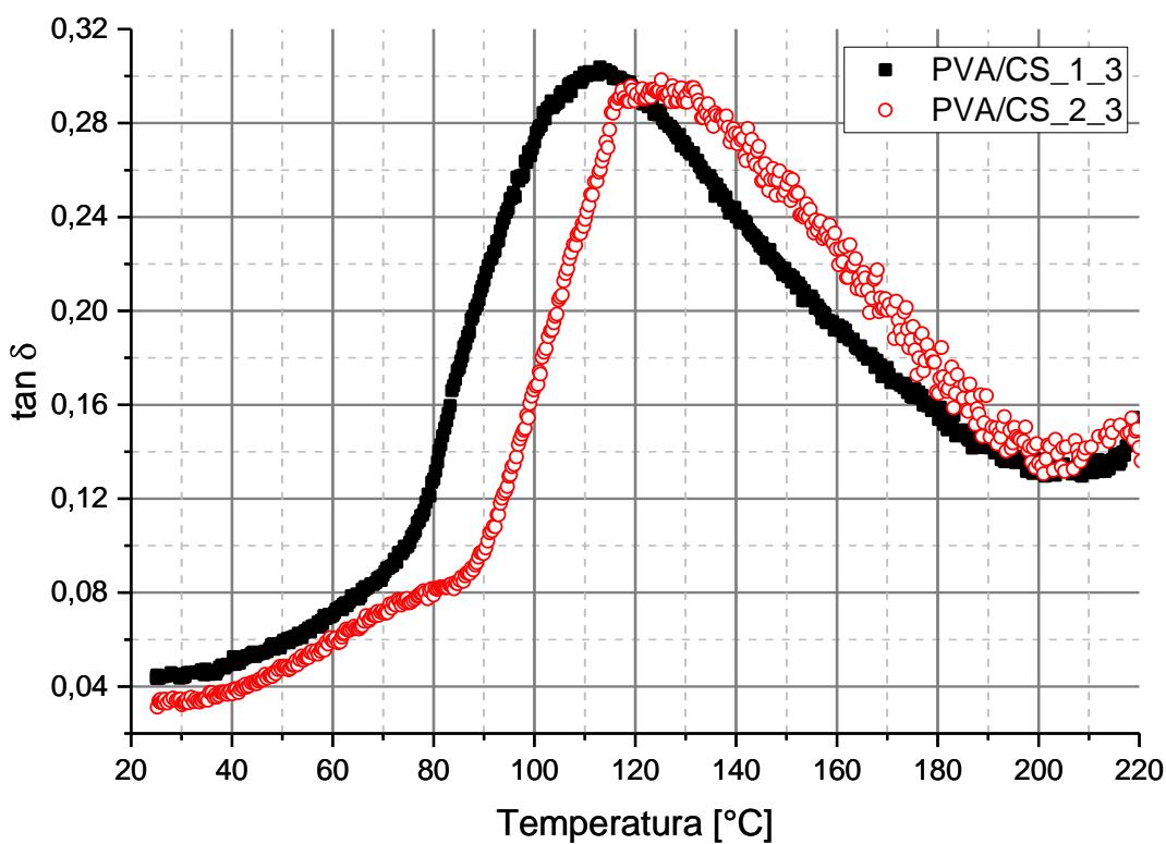
**Slika 8.7. Usporedni prikaz krivulja ovisnosti  $\tan \delta$  o temperaturi za PVA + 20% CS**
