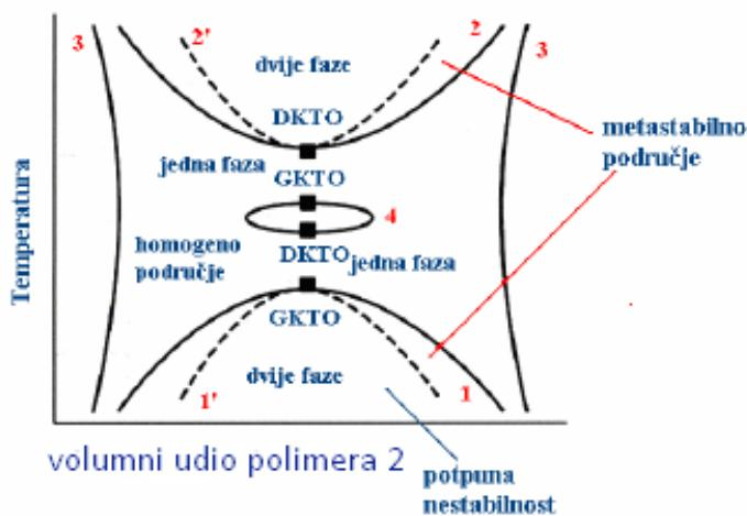
Slika 4.2. Shematski dijagram temperaturna-volumni udio polimera [15]
