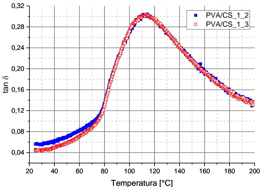
Slika 8.3. Ponovljivost ispitivanja na PVA/CS\_1 uzorku, svježe pripremljena folija
