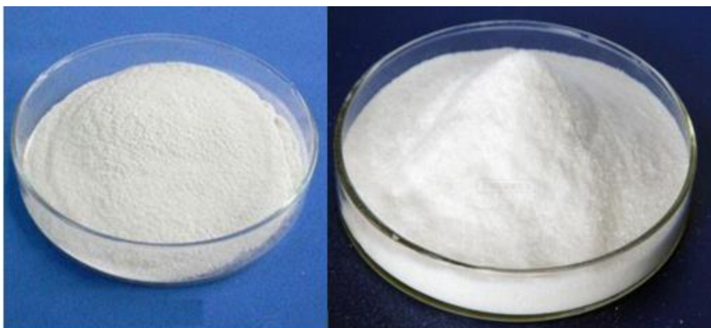
Slika 7.1. Poli(vinil-alkohol) (lijevo) i hitozan (desno) u praškastom obliku [21], [22]
