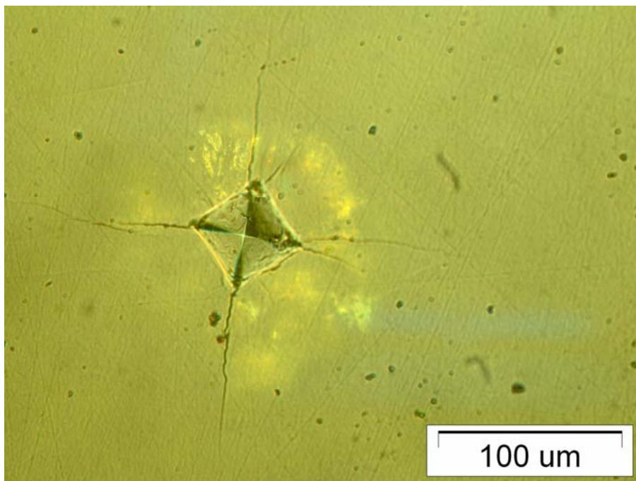
Slika 30 Otisak dijamantne piramide nakon mjerjenja tvrdoće metodom HV5
