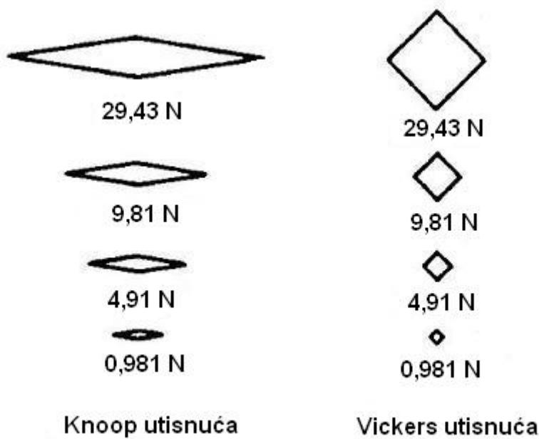
Slika 23 Shematski prikaz otiska kod metoda po Knoopu i Vickersu [11]
