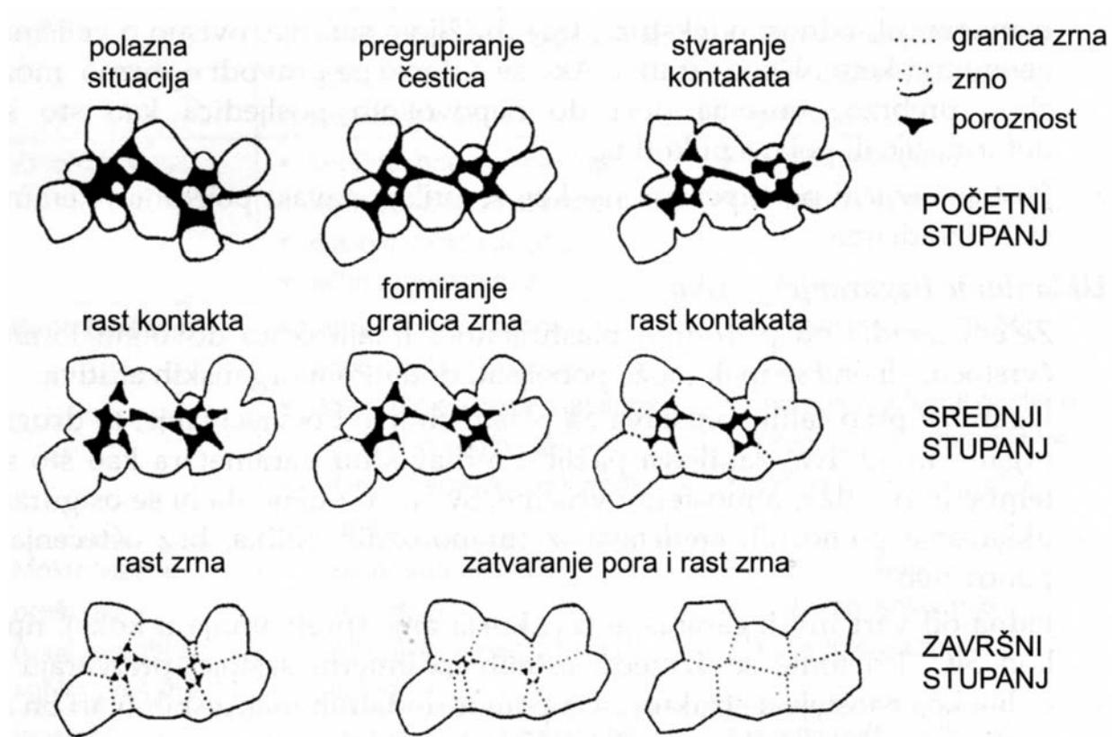
Slika 14 Rast zrna tijekom procesa sinteriranja [1]
