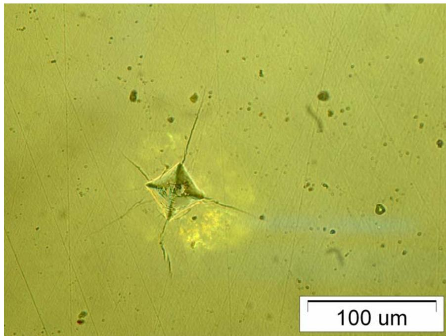
Slika 29 Otisak dijamantne piramide nakon mjerjenja tvrdoće metodom HV3
