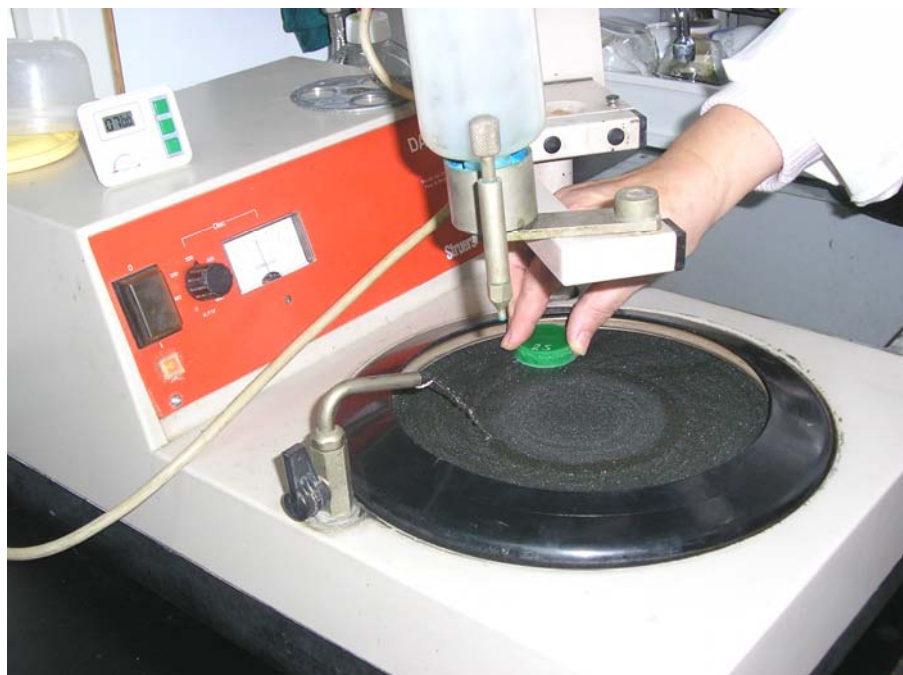
Slika 24 Uređaj za brušenje
