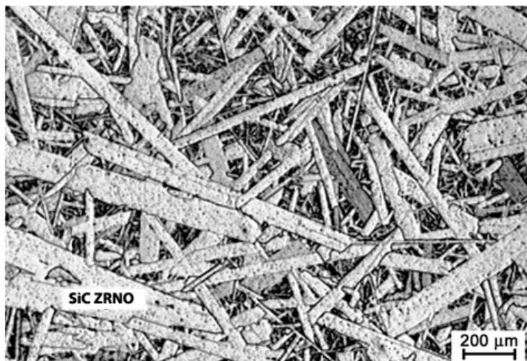
Slika 5 Mikrostruktura grubozrnatog SSIC [1]
