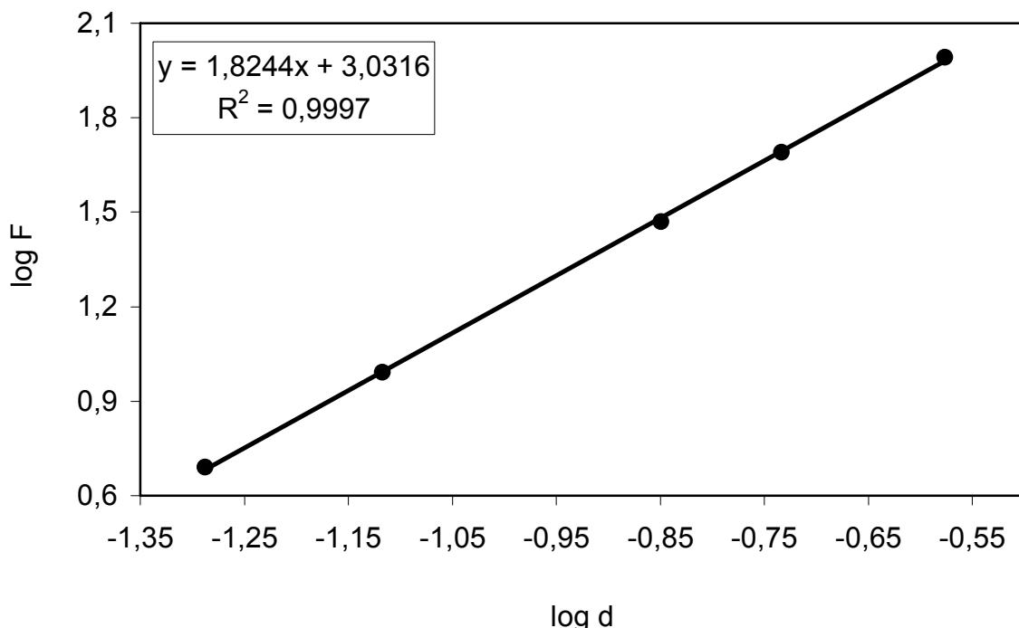
*Slika 42 Grafički prikaz ovisnosti  $\log F$  o  $\log d$  za SiC keramiku prema Meyerovom zakonu (metoda po Knoopu)*
