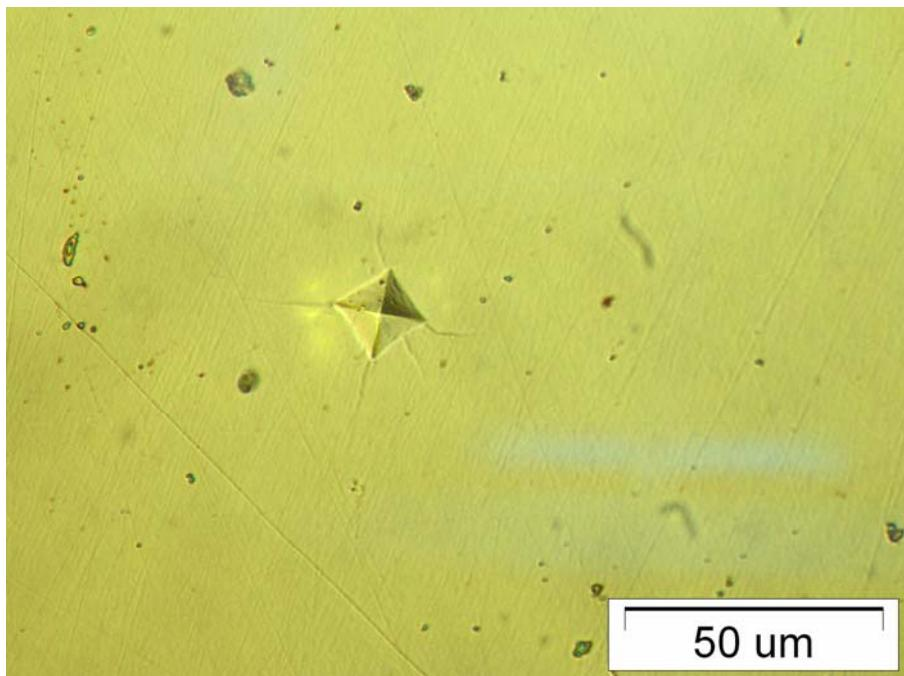
Slika 27 Otisak dijamantne piramide nakon mjerena tvrdoće metodom HV0,5
