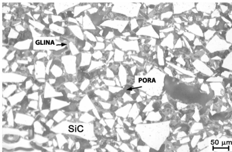
Slika 2 Mikrostruktura sitnozrnatog silicijeva karbida povezanog silikatima [1]
