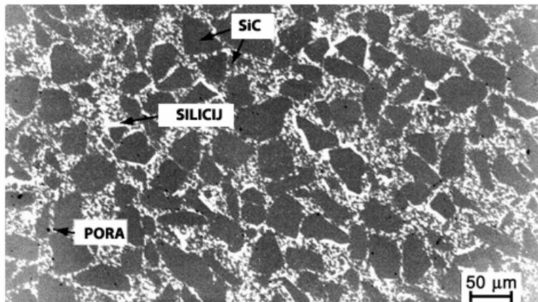
Slika 6 Mikrostruktura SISiC [1]
