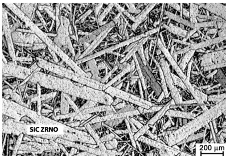
Slika 5 Mikrostruktura grubozrnatog SSiC [1]
