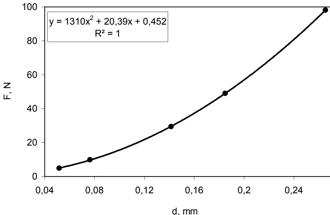
Slika 44 Grafički prikaz ovisnosti  $F$  o  $d$  za SiC keramiku prema modificiranom modelu otpornosti razmjernom svojstvima uzorka (metoda po Knoopu)
