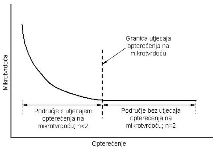
Slika 19 Shematski prikaz utjecaja opterećenja na tvrdoću [16]
