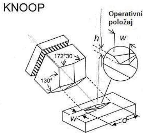
Slika 22 Shematski prikaz Knoopovog penetratora i otiska [11]
