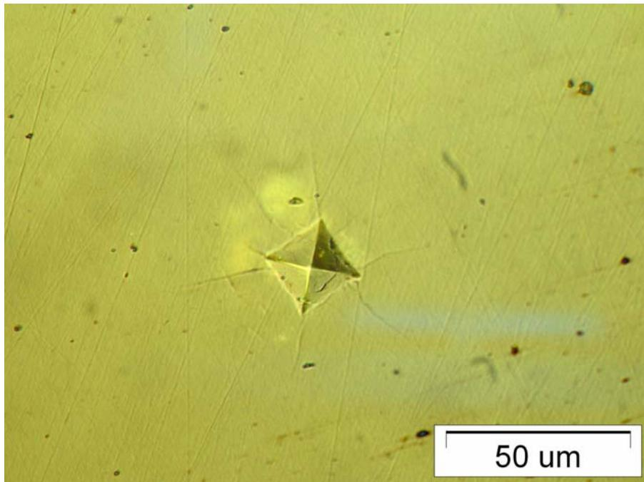
Slika 28 Otisak dijamantne piramide nakon mjerjenja tvrdoće metodom HV1
