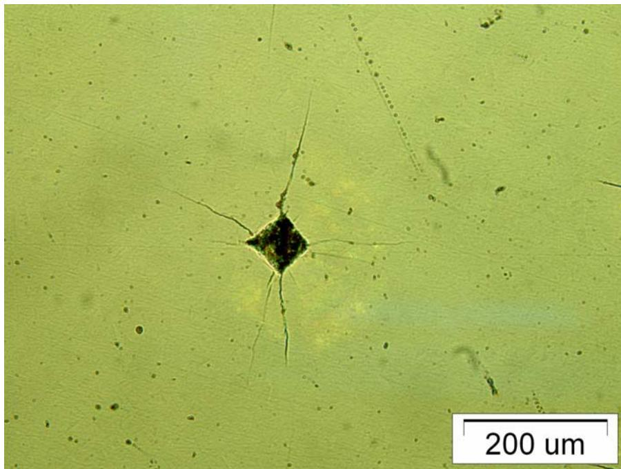
Slika 31 Otisak dijamantne piramide nakon mjerjenja tvrdoće metodom HV10
