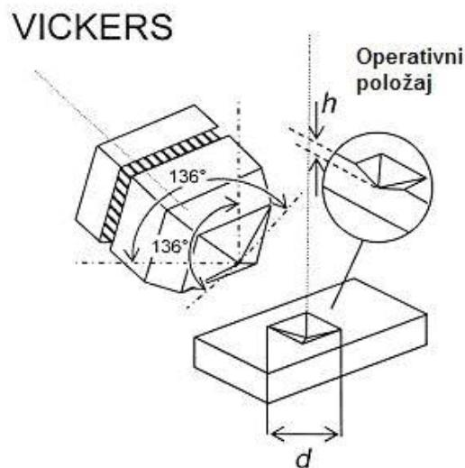
Slika 20 Shematski prikaz Vickersovog penetratora i otiska [11]
