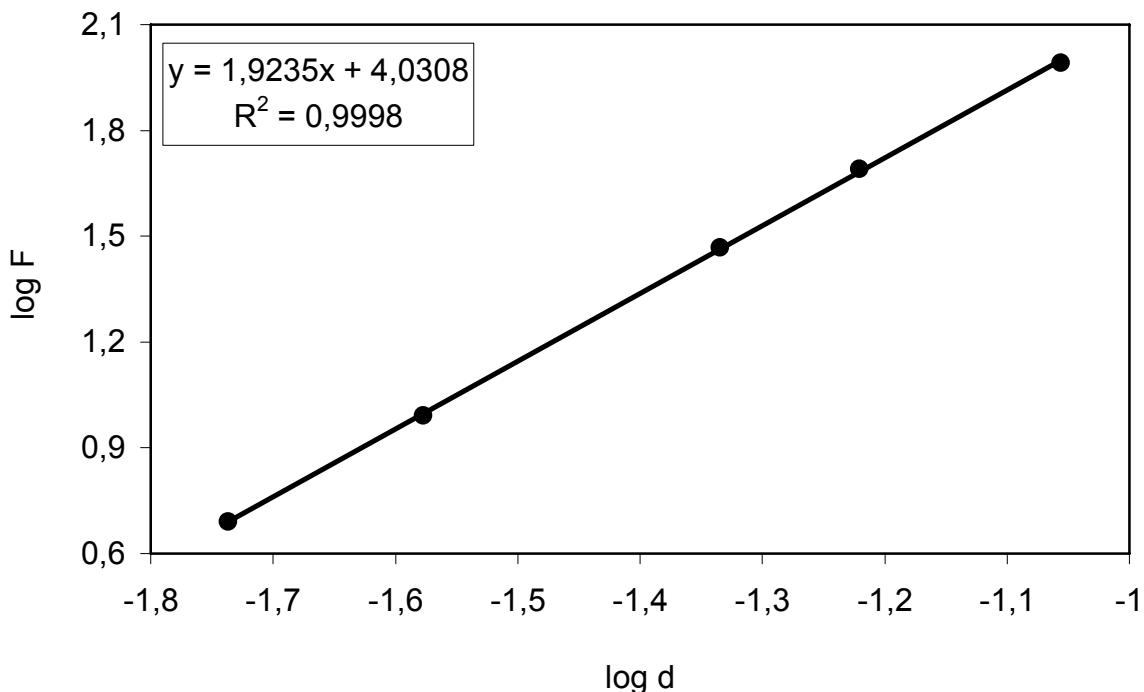
Slika 33 Grafički prikaz ovisnosti  $\log F$  o  $\log d$  za  $\text{SiC}$  keramiku prema Meyerovom zakonu (metoda po Vickersu)
