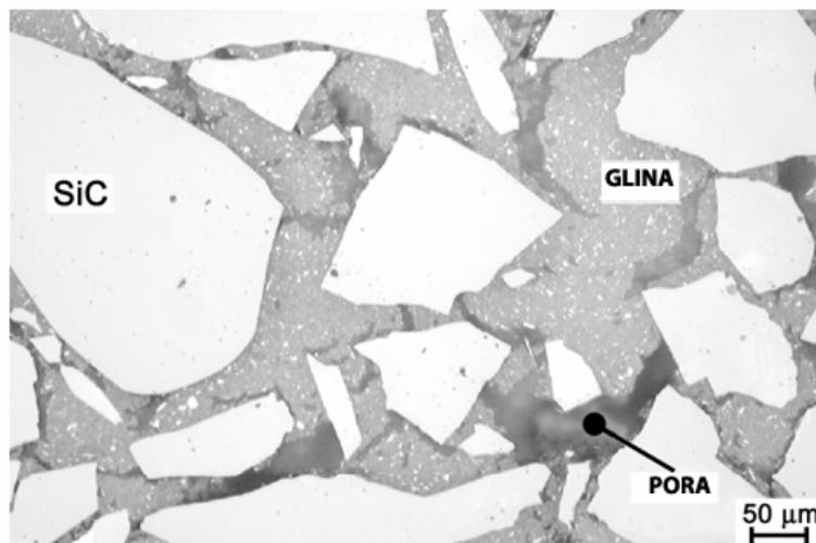
Slika 1 Mikrostruktura grubozrnatog silicijeva karbida povezanog silikatima [1]
