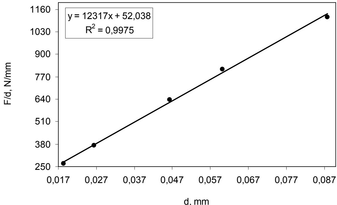
*Slika 34 Grafički prikaz ovisnosti  $F/d$  o  $d$  za SiC keramiku prema modelu otpornosti razmernom svojstvima uzorka (metoda po Vickersu)*
