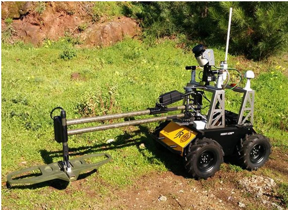
**Slika 1. Robot za detekciju mina**
