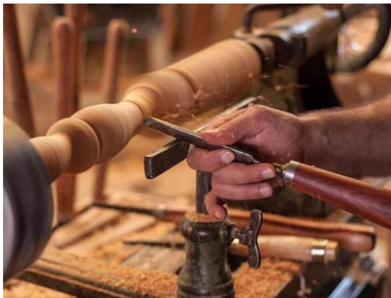
Slika 3. Obrada drva na tokarskom stroju
