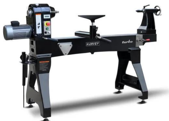
Slika 7. Tokarilica sa varijabilnom brzinom vrtnje motora
