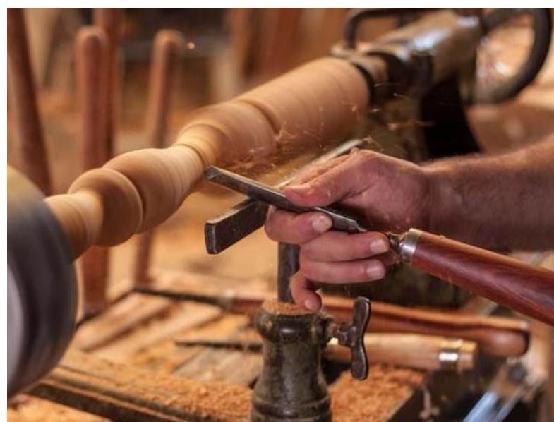
Slika 3. Obrada drva na tokarskom stroju
