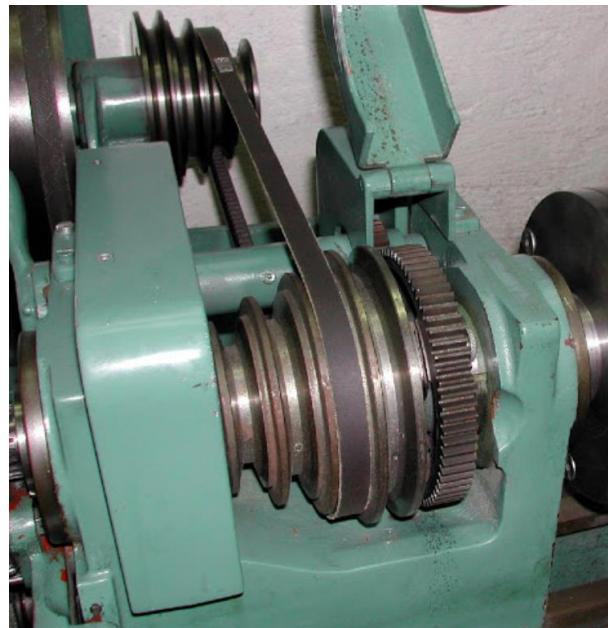
**Slika 6. Tokarski stroj s prijenosom putem klinastog remena**
