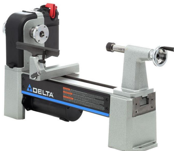
Slika 4. Mala tokarilica sa motorom ispod stroja
