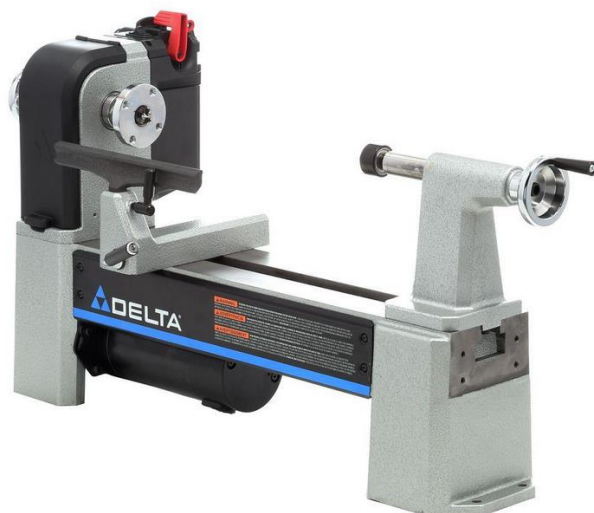
Slika 4. Mala tokarilica sa motorom ispod stroja
