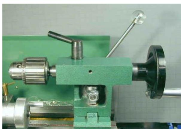
**Slika 12. Pomični oslonac s nastavkom za bušenje**
