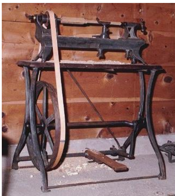
Slika 1. „Wilkinson“ tokarski stroj pokretan nogom, 19. st.
