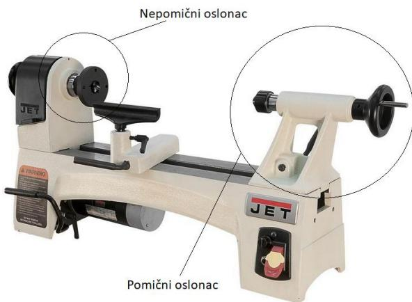
**Slika 9. Nepomični i pomični oslonac na tokarskom stroju**
