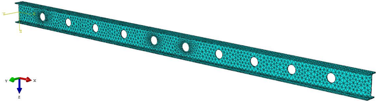
Slika 40. Diskretizirani numerički model s 14594 C3D10 konačnih elemenata za D/h = 0,4
