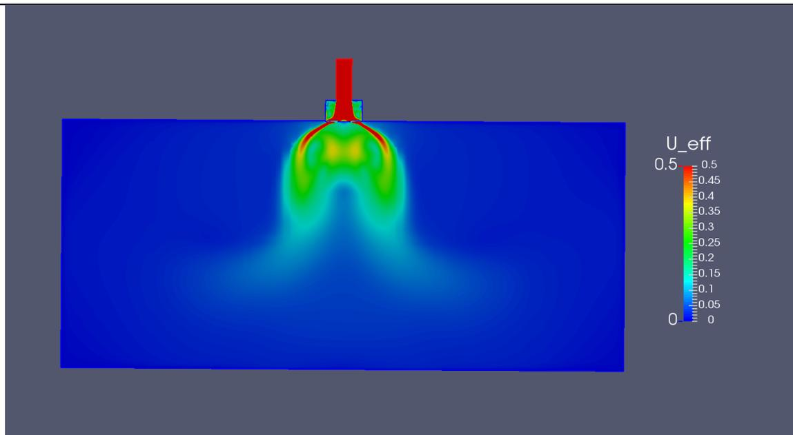
Slika 21. Prikaz polja brzina po presjeku prostorije (1000. iteracija)
