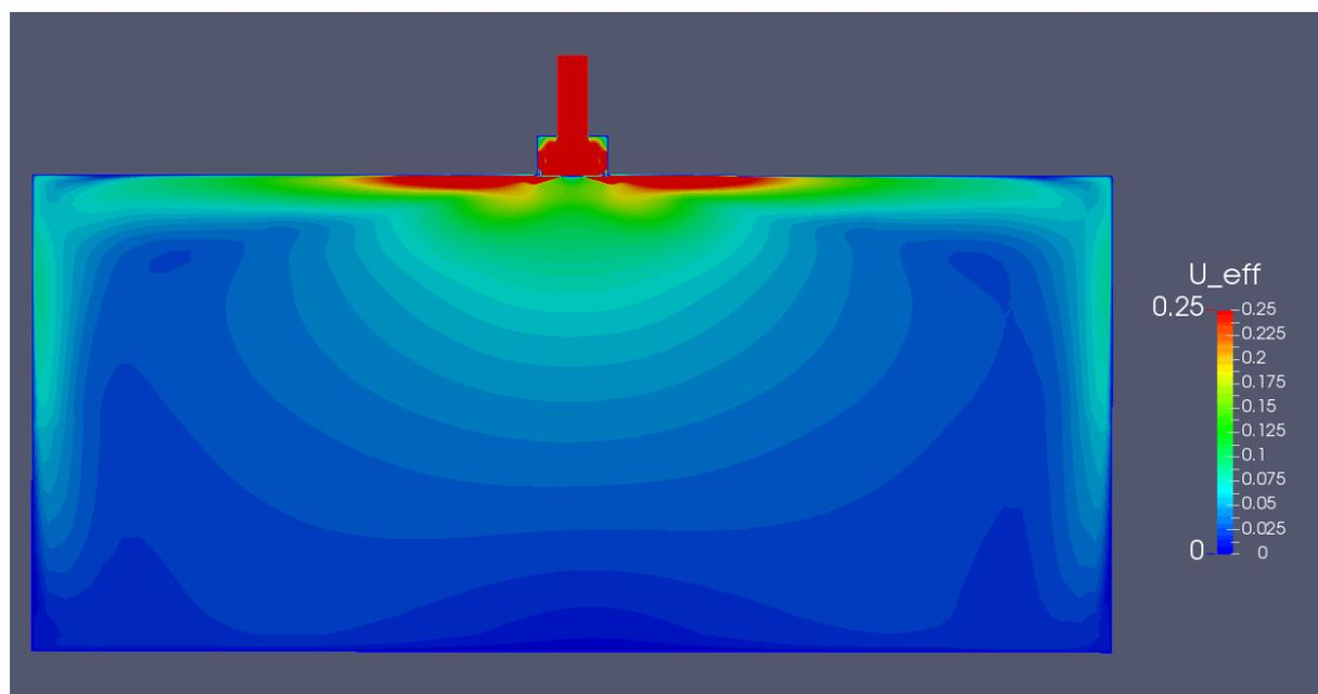
Slika 26. Prikaz polja brzina po presjeku prostorije (400. iteracija)
