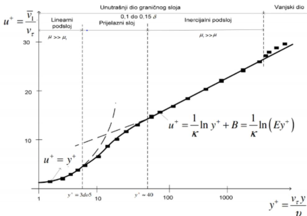
**Slika 8. Profil bezdimenzijske brzine unutar graničnog sloja [4]**
