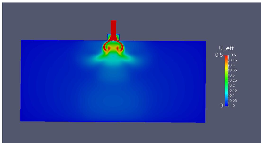
Slika 20. Prikaz polja brzina po presjeku prostorije (400. iteracija)
