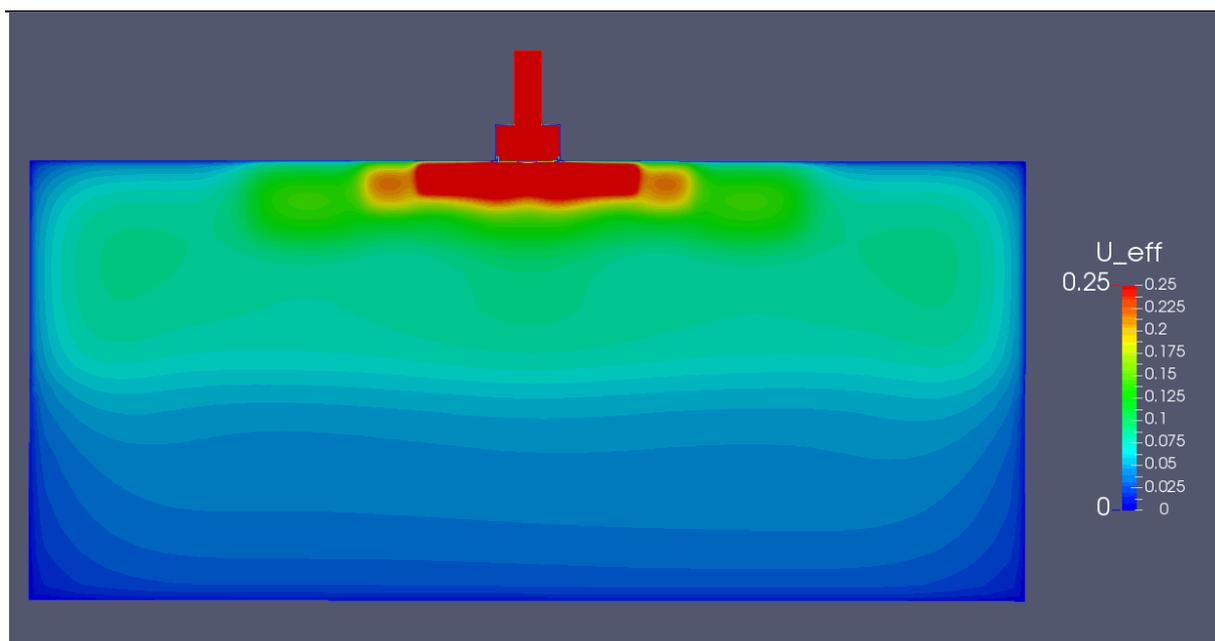
Slika 25. Prikaz polja brzina po presjeku prostorije (50. iteracija)
