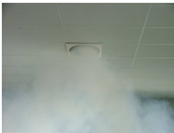
Slika 24. Eksperimentalno mjerenje, difuzor bez prstena [2]
