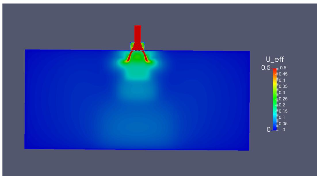
Slika 19. Prikaz brzina po presjeku prostorije (300. iteracija)
