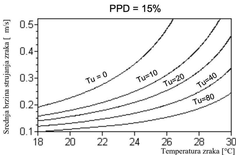
Slika 7. Utjecaj intenziteta turbulencija na PPD [1]
