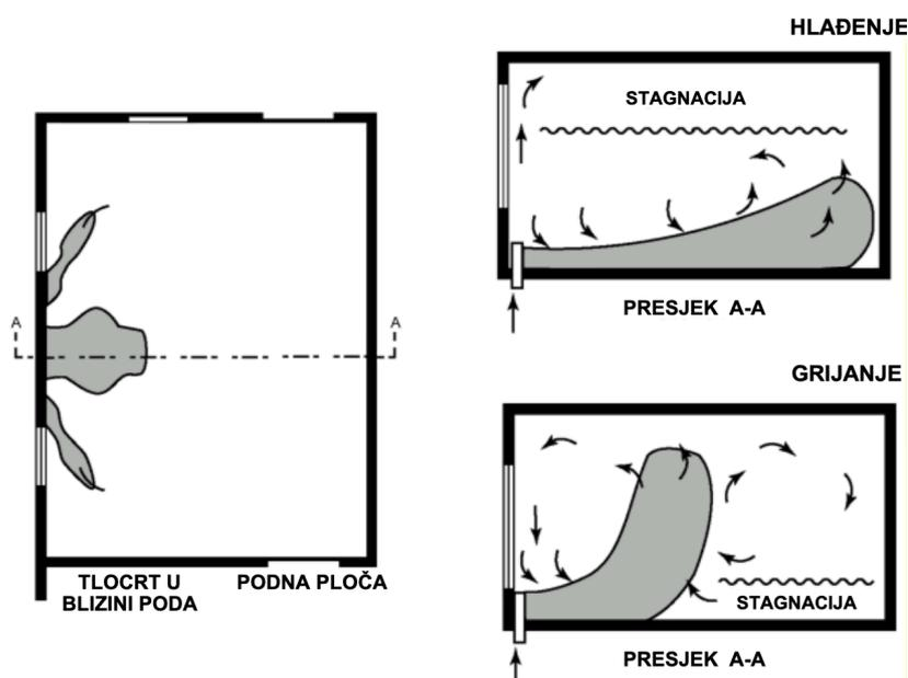
Slika 4. Primjer strujanja zraka istrujnog otvora grupe D [1]
