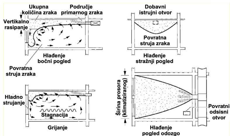
Slika 1. Primjer strujanja zraka istrajnih otvora grupe A [1]
