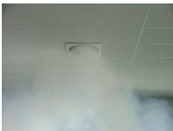
**Slika 24. Eksperimentalno mjerenje, difuzor bez prstena [2]**
