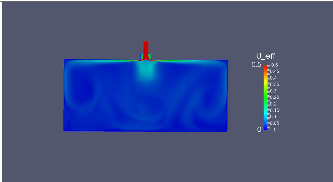
**Slika 23. Prikaz polja brzina po presjeku prostorije (2400. iteracija)**
