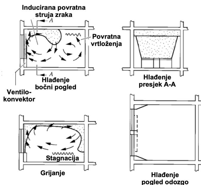
Slika 3. Primjer strujanja zraka istrujnog otvora grupe C [1]
