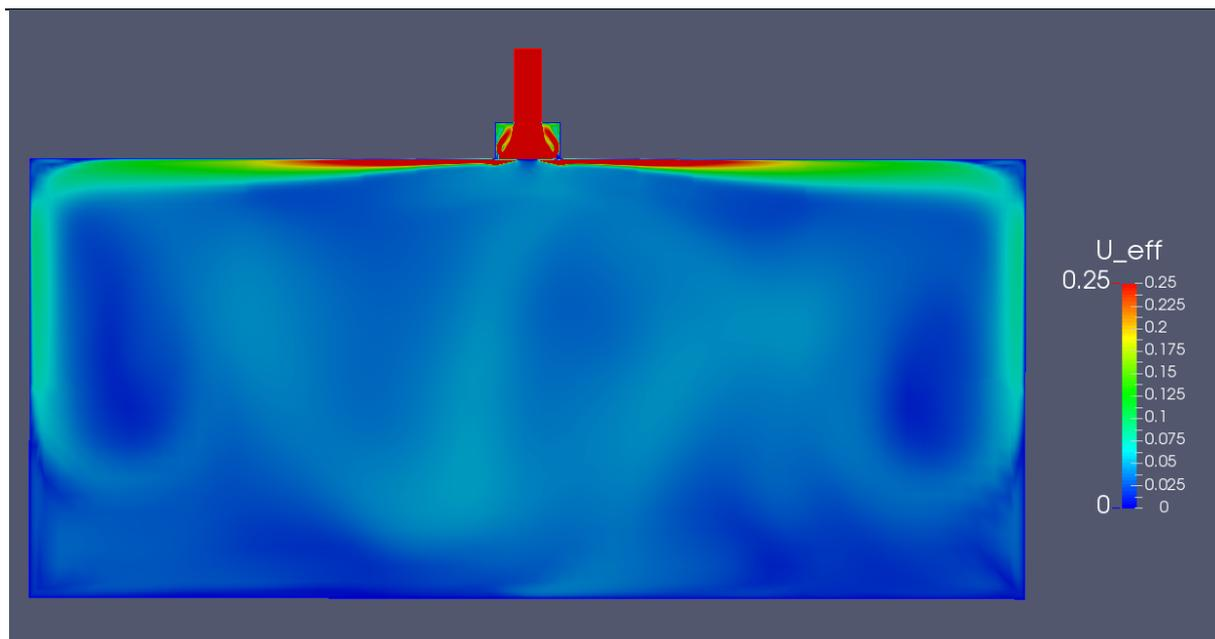
**Slika 27. Prikaz polja brzina po presjeku prostorije (2000. iteracija)**
