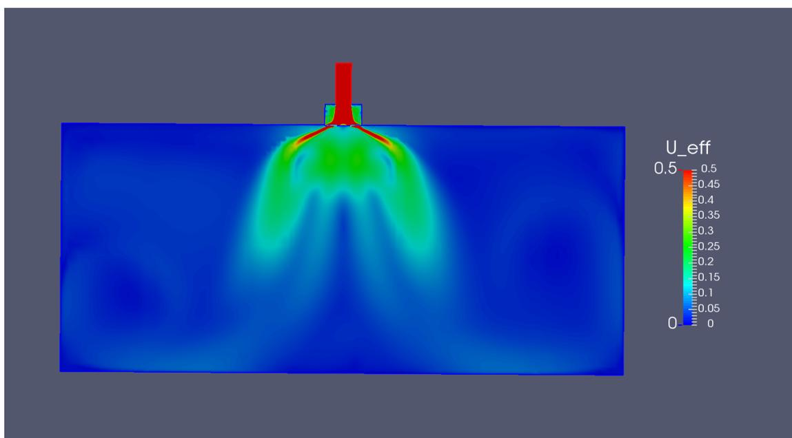
Slika 22. Prikaz polja brzina po presjeku prostorije (1500. iteracija)
