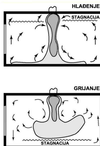
Slika 5. Primjer strujanja zraka istrujnog otvora grupe E [1]
