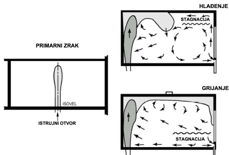
Slika 2. Primjer strujanja zraka istrujnih otvora grupe B [1]
