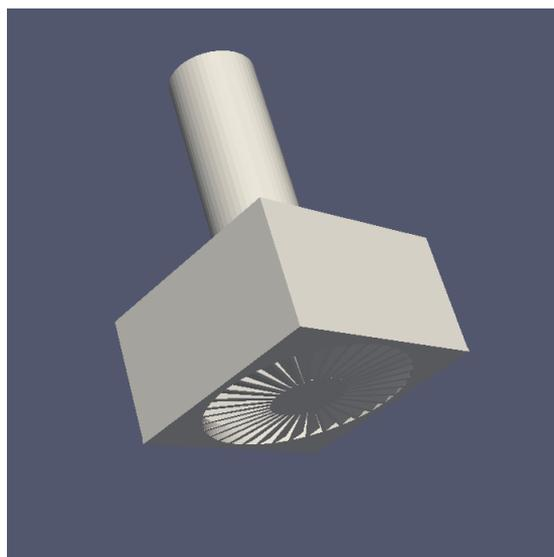
**Slika 10. Difuzor s vrtložnim anemostatom**
