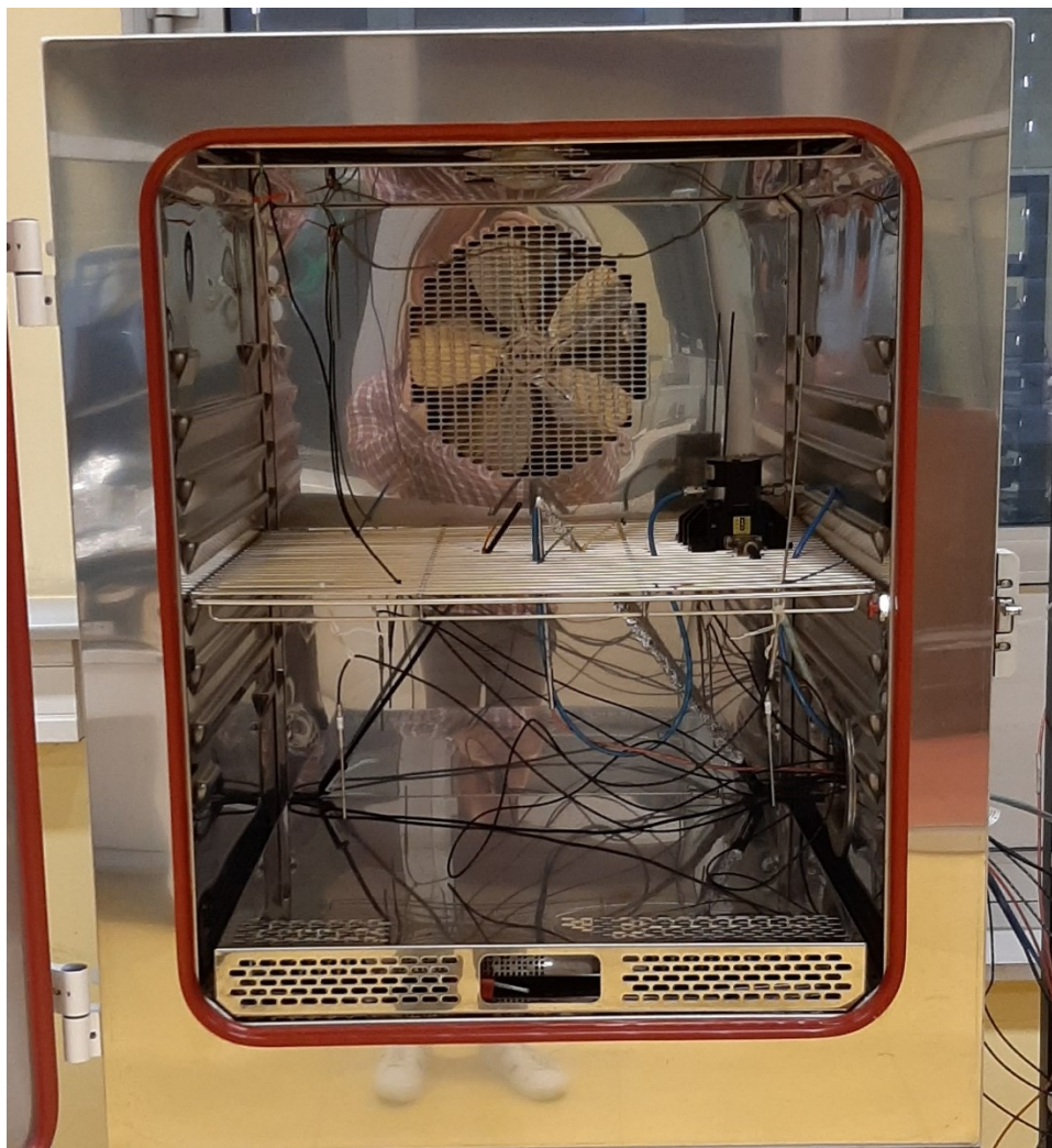
Slika 9 Mjerne lokacije termometara i higrometra
