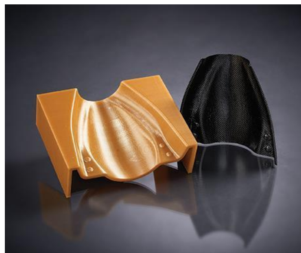
Slika 6.2 Kalupi načinjeni postupkom FDM: a) Kalup sa šupljom unutrašnjosti; b) školjkasti kalup [13]
