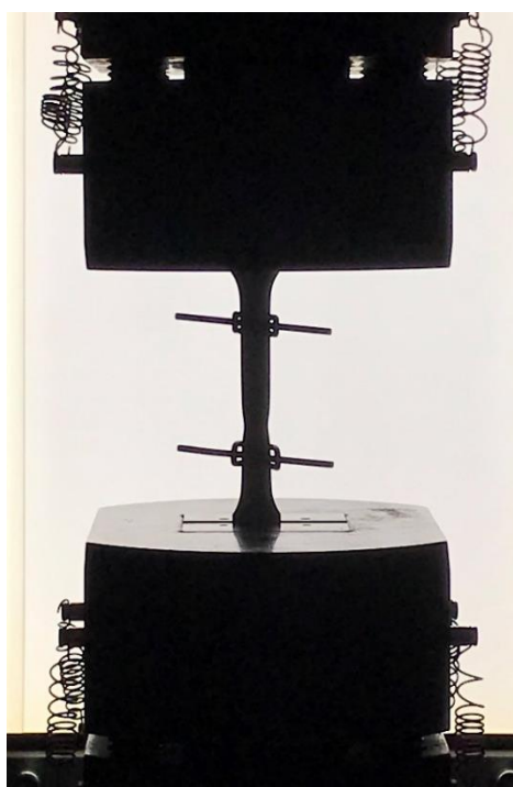
Slika 19. a) Eksperimentalni postav za provedbu statičkog vlačnog testa i b) epruveta s postavljenim markerima za mjerenje pomaka
