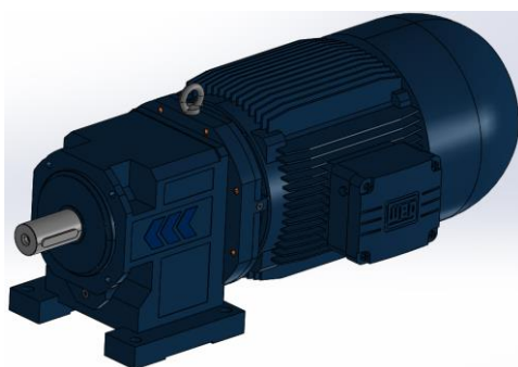
Slika 93. 3D model elektromotora s reduktorom i kočnicom
