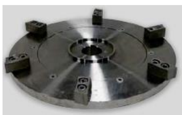
Slika 13. Rotor s čekićima
