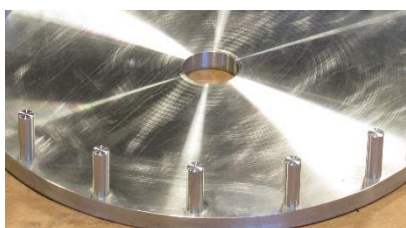
Slika 14. Rotor s zaticima
