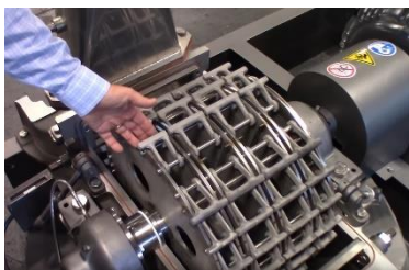
Slika 21. Rotor s zglobno vezanim čekićima (veće površine)
