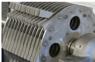
Slika 22. Rotor s zglobno vezanim čekićima (manje površine)
