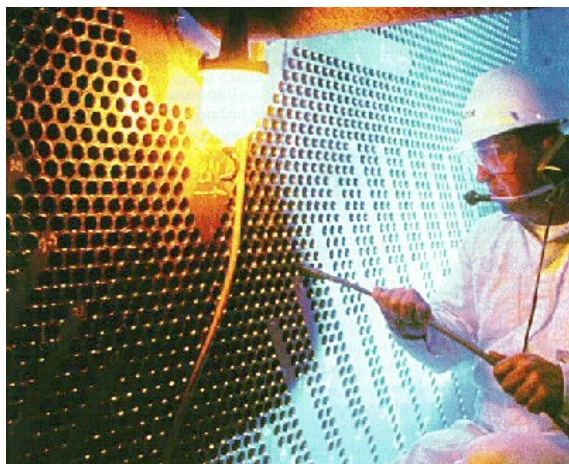
Slika 7. Ručno ispitivanje cijevne stijene [10]
