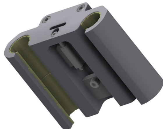
Slika 56. Kućište kliznog ležaja – donji pogled
