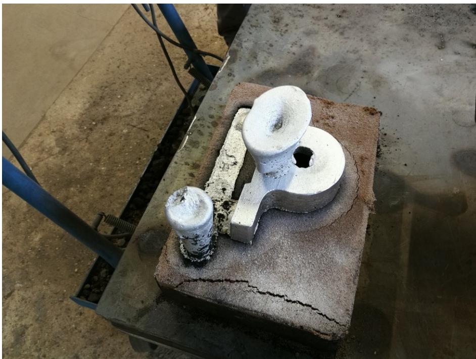
Slika 55. Odljevak i uljevni sustav
