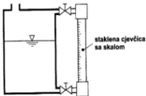
Slika 2. Sustav za mjerenje dubine pomoću staklene cjevčice[3]
