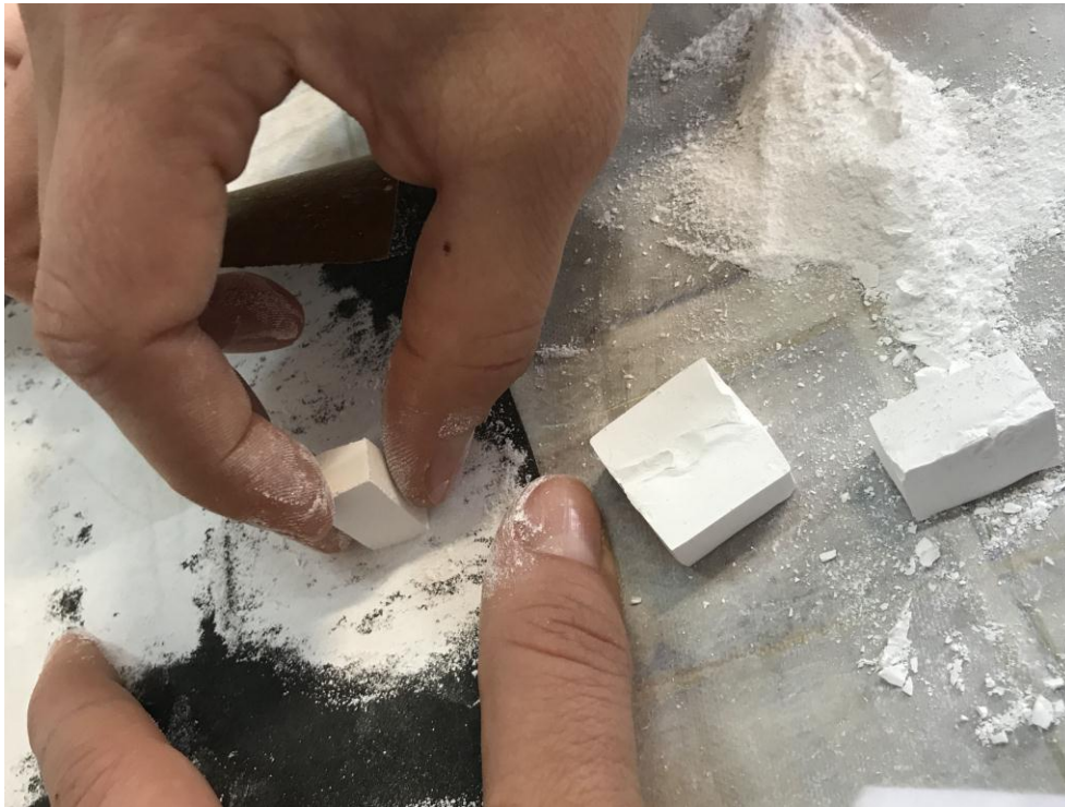
Slika 16. Brušenje sirovaca (zelena obrada)
