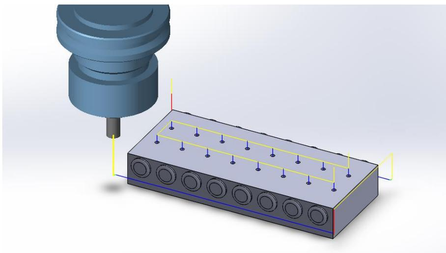
**Slika 39. Bušenje i glodanje svornjaka – putanja alata – CAM**
