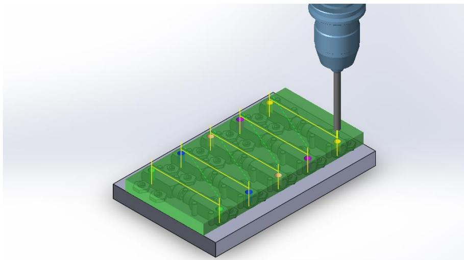
**Slika 22. Bušenje provrta za svornjak – putanja alata – CAM**
