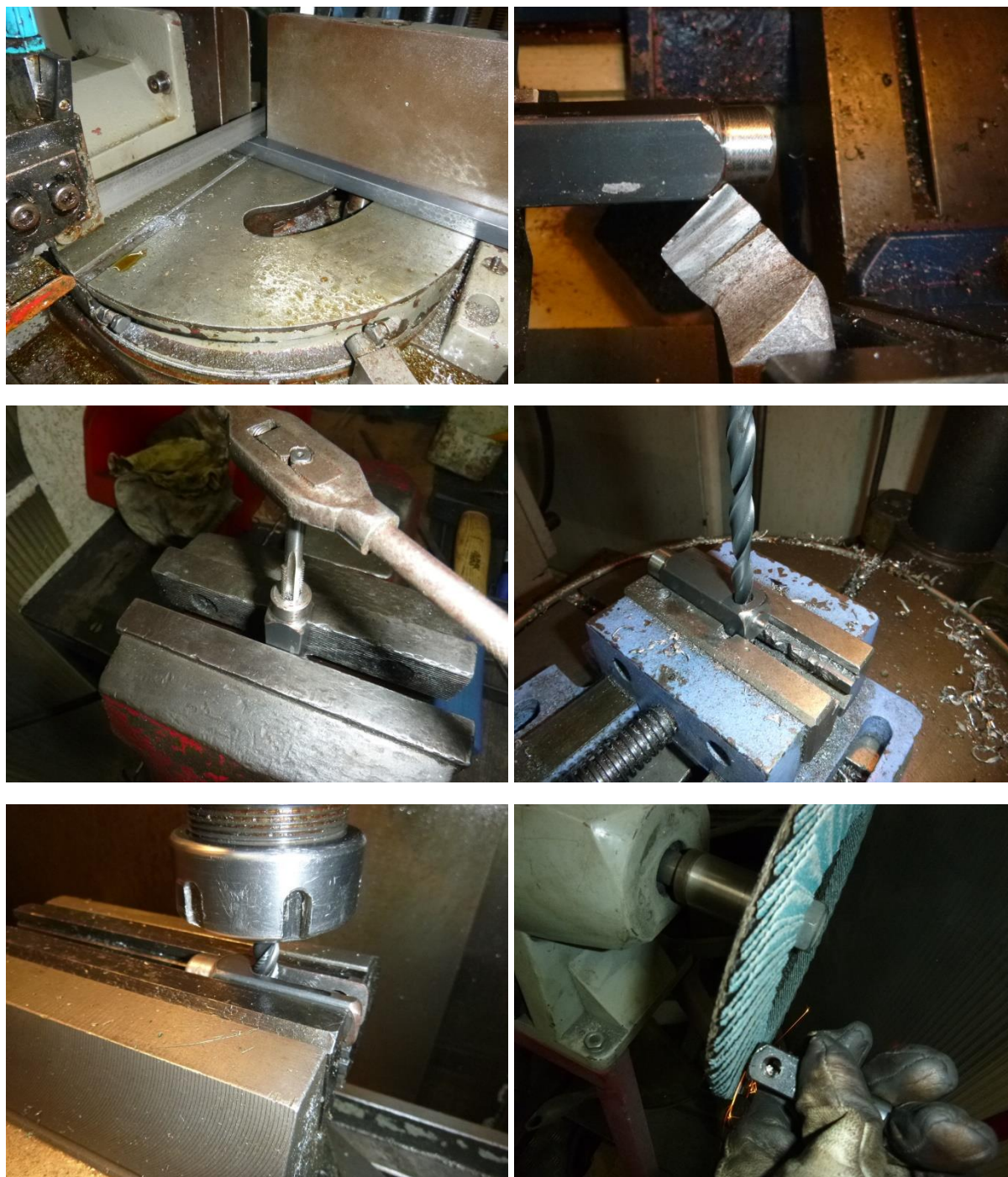
Slika 3. Prikaz postojećeg načina izrade vilice
