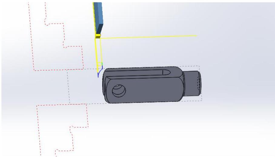
**Slika 12. Tokarenje stražnjeg zaobljenja – putanja alata – CAM**
