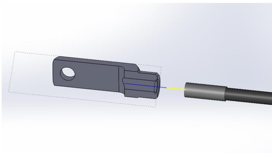
**Slika 11. Urezivanje navoja – putanja alata – CAM**
