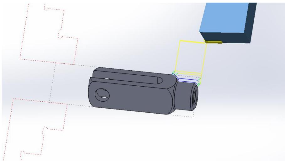
**Slika 7. Tokarenje vrata vilice – putanja alata – CAM**
