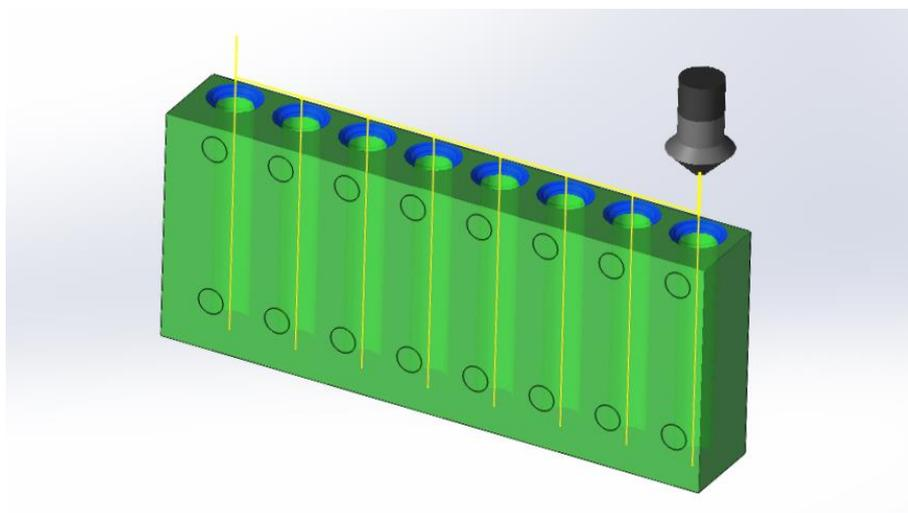
**Slika 41. Bušenje i upuštanje provrta za pozicioniranje svornjaka**
