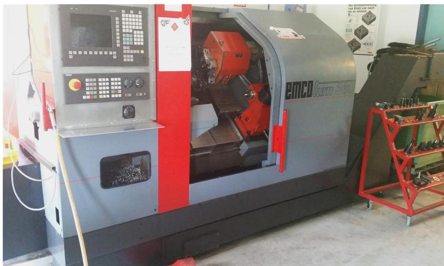
**Slika 15. CNC tokarski stroj, EMCO Turn 360**
