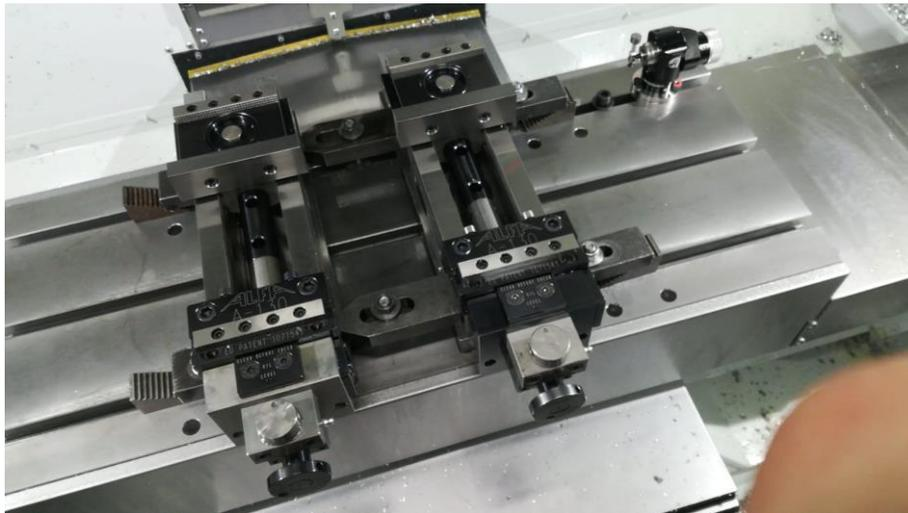
**Slika 17. Stezna naprava s podesivim hidrauličnim načinom stezanja**
