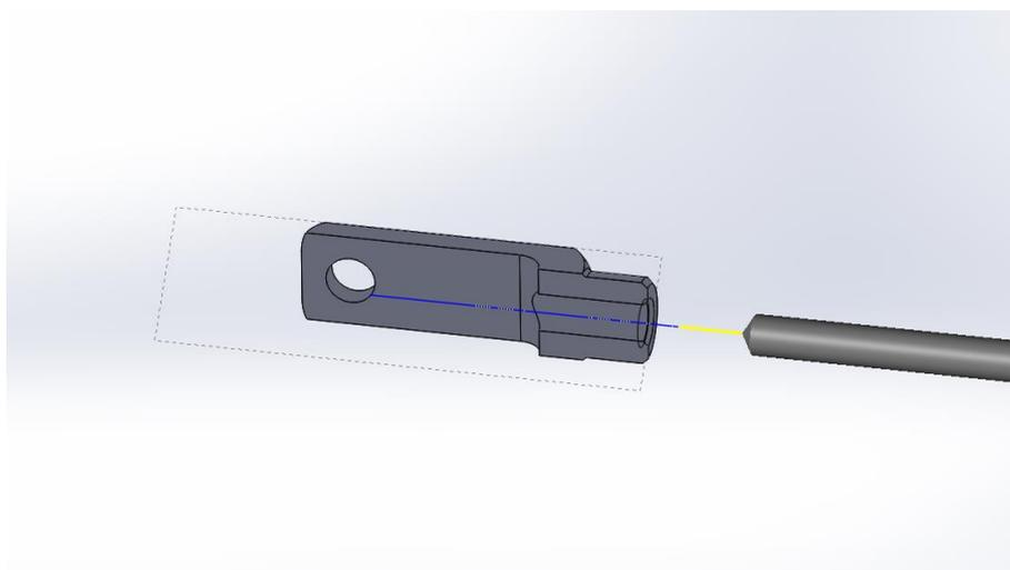
Slika 8. Bušenje – putanja alata – CAM
