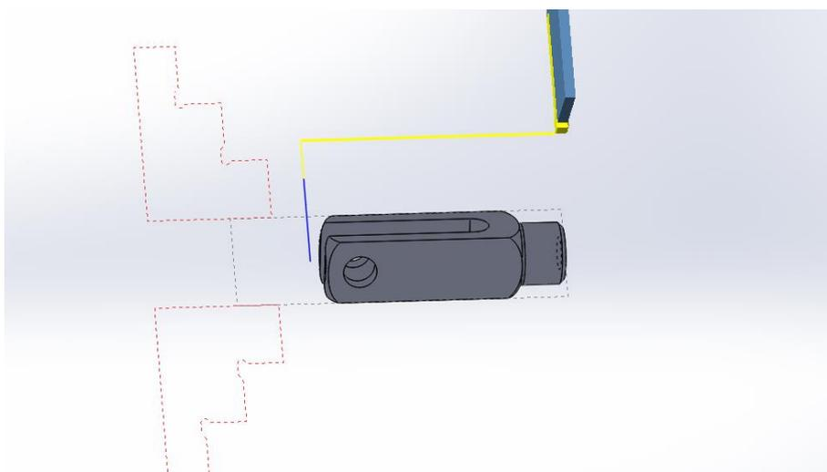
**Slika 13. Odrezivanje – putanja alata – CAM**
