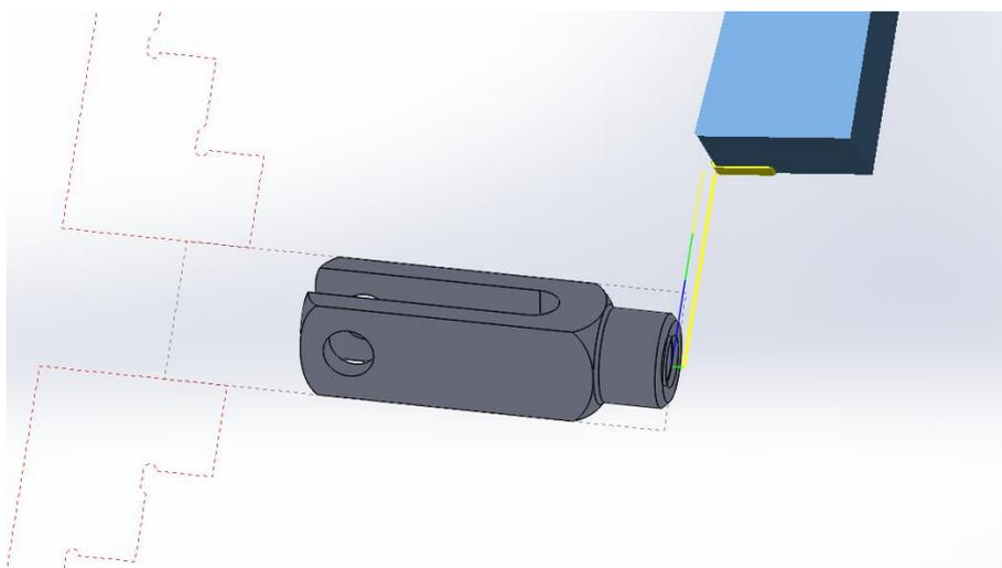
Slika 5. Čeono tokarenje – putanja alata – CAM
