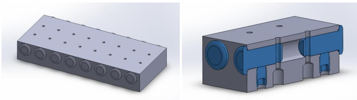
Slika 38. Pomoćna stezna naprava za bušenje svornjaka
