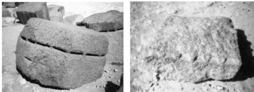
Slika 3.4. Cijepanje granitnog kamena uz pomoć tlaka bubrenja [4]
