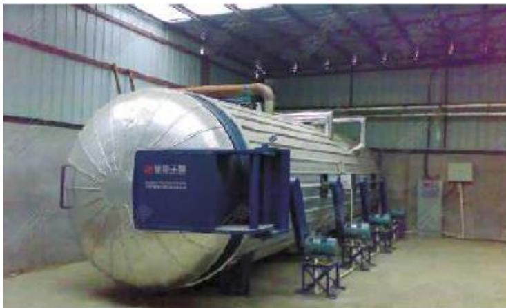
Slika 4.1. Komora za toplinsko modificiranje drva [21]
