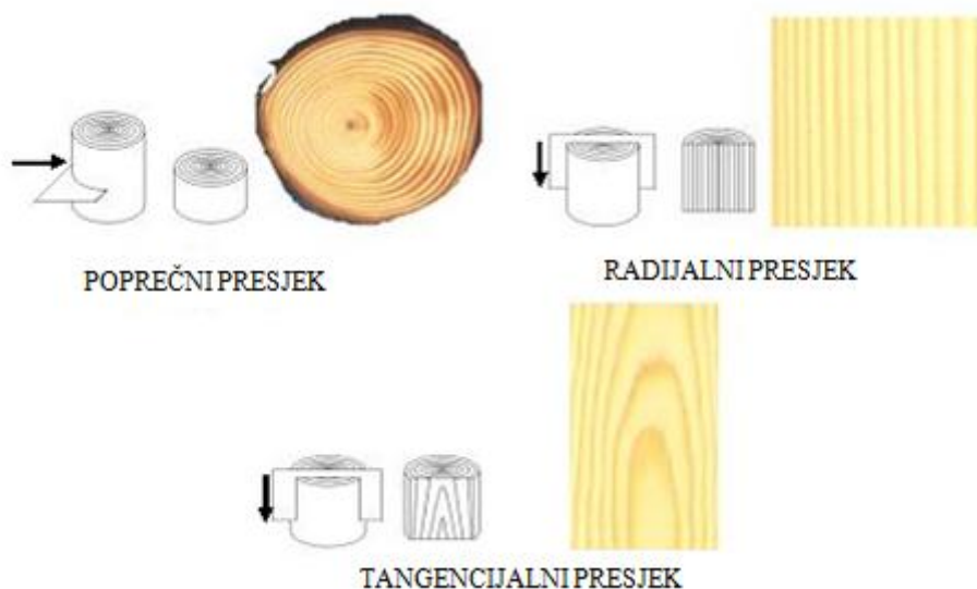
Slika 2.3. Makroskopski presjeci drva: a) poprečni, b) radijalni i c) tangencijalni [10]
