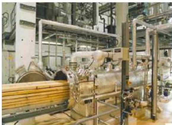
Slika 4.4. Komora za kemijsku modifikaciju drva [21]
