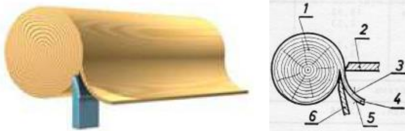
Slika 6.10. Način dobivanja ljuštenog furnira: 1) trupac, 2) pritisna greda, 3) pritisnuta strana, 4) list furnira, 5) otpuštena strana, 6) nož [30]
