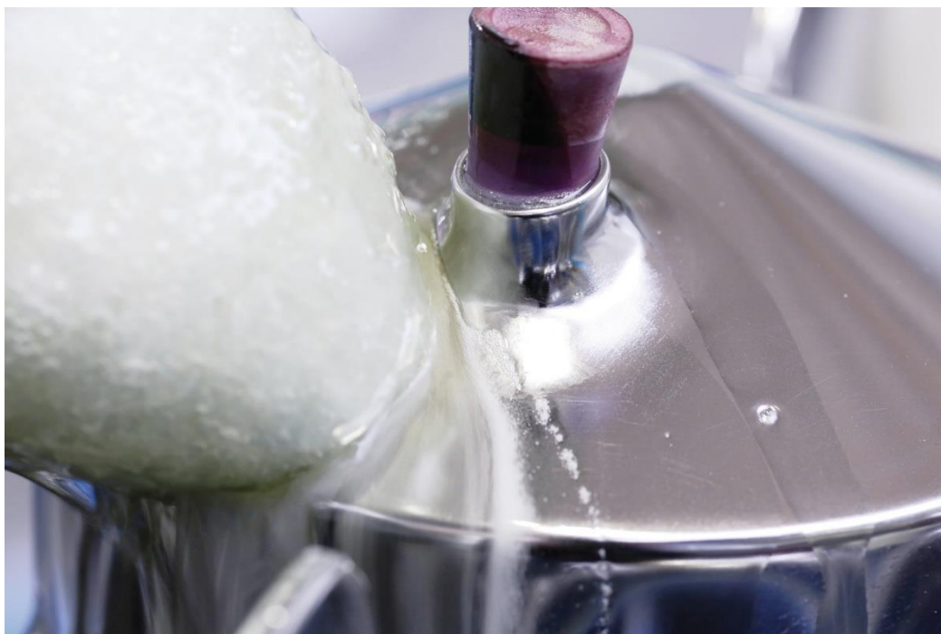
Slika 17. Elektropoliranje tamponskim postupkom [16]
