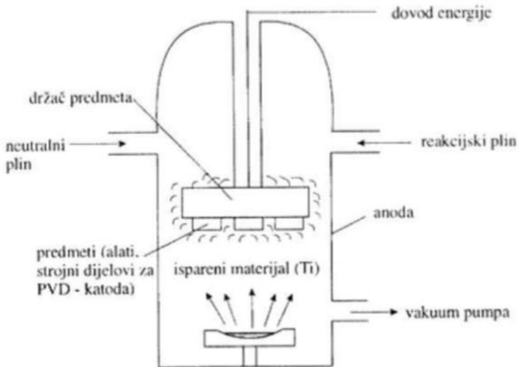
Slika 4.3. Shematski prikaz uređaja PVD postupkom [11]
