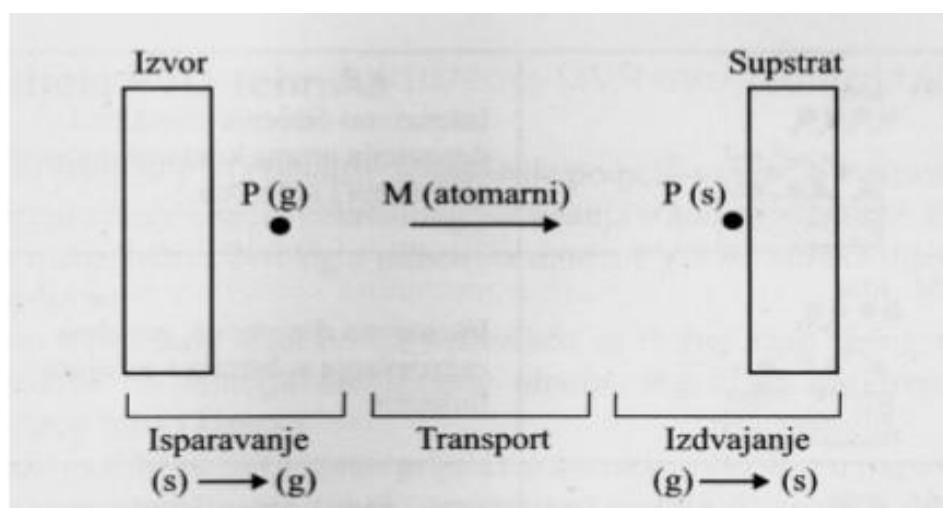
Slika 4.4. Shematski prikaz fizikalnog trošenja iz parne faze [10]
