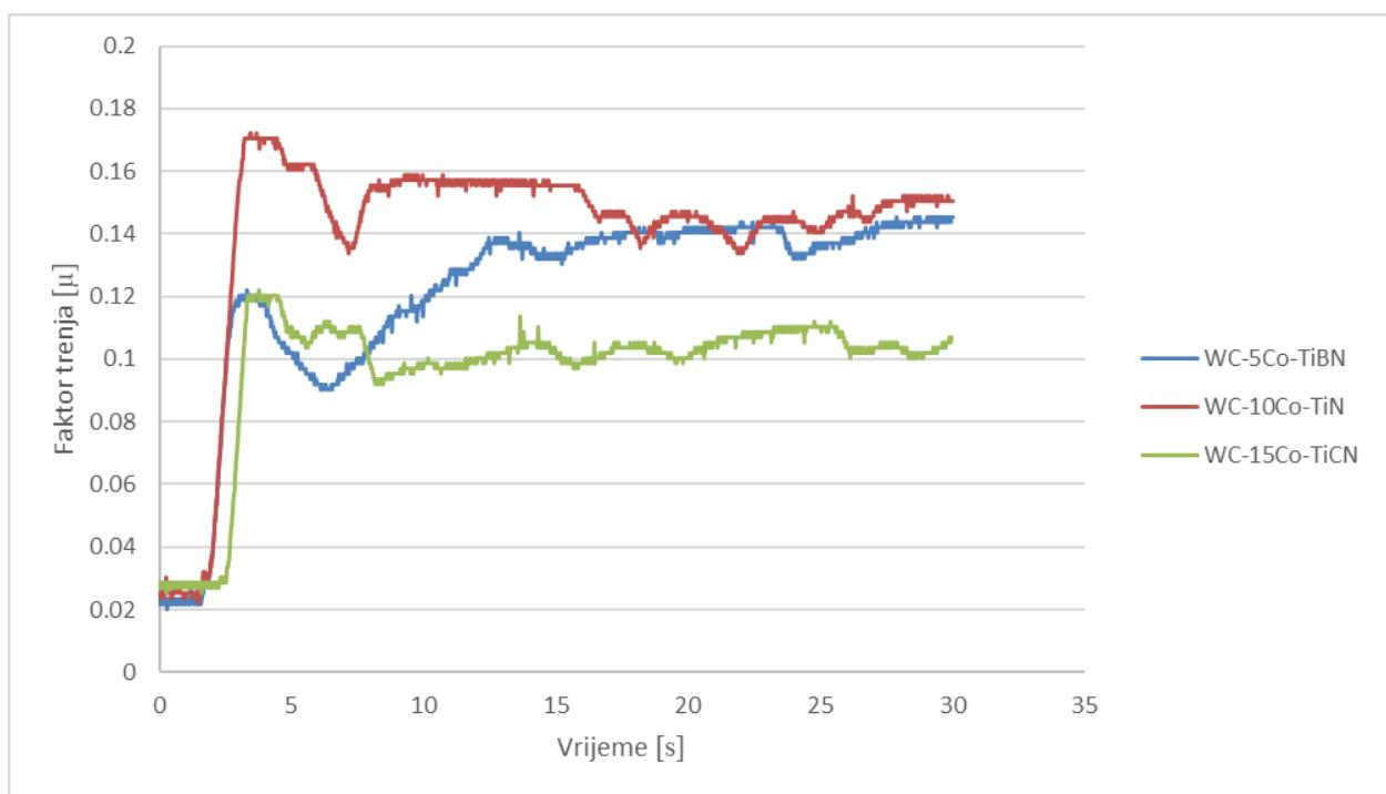
Slika 5.10. Usporedba faktora trenja za sva tri uzorka
