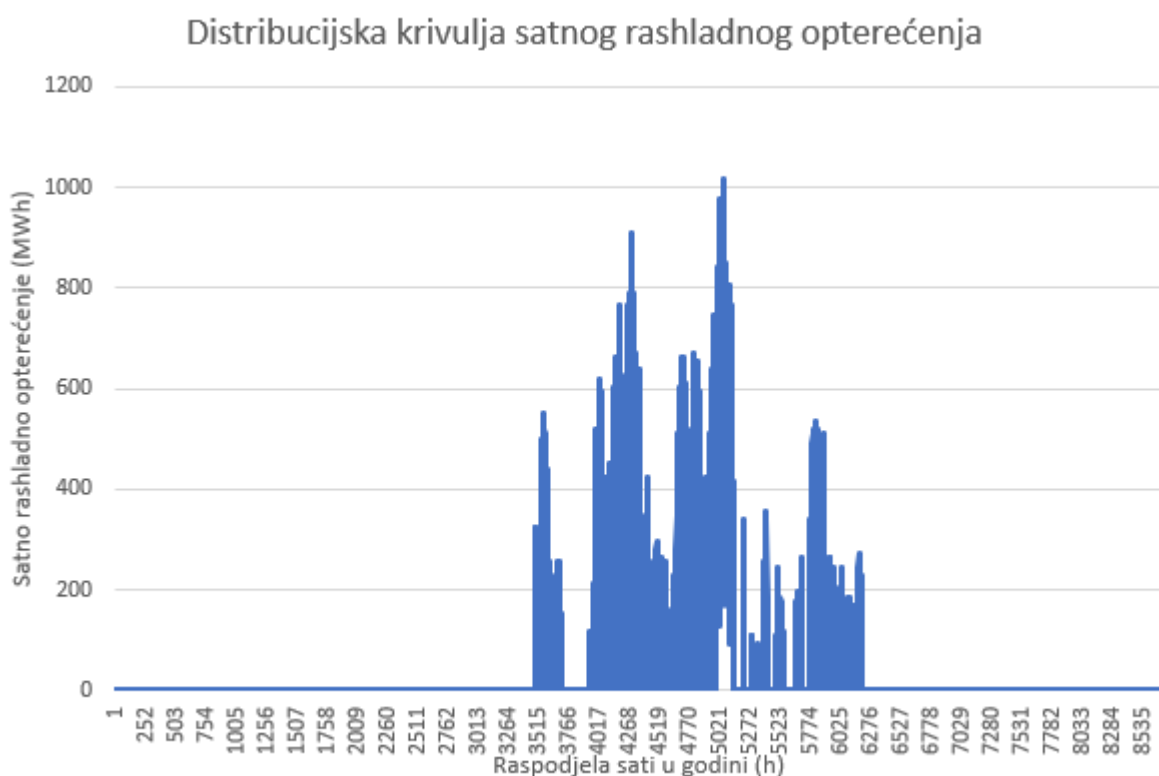
Slika 7. Satna distribucijska krivulja rashladnog opterećenja [28]
