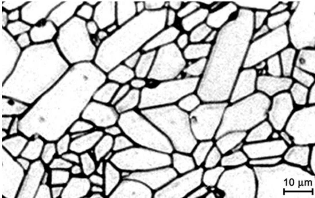
Slika 5. Mikrostruktura aluminij-oksidge keramike (99,7%) [1]
