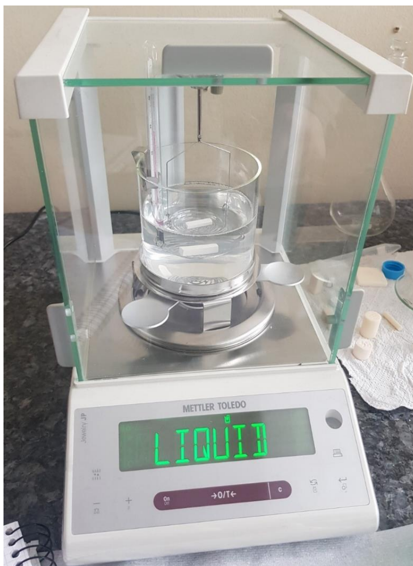
Slika 24. Uređaj za mjerenje gustoće uzoraka- METTLER TOLEDO
