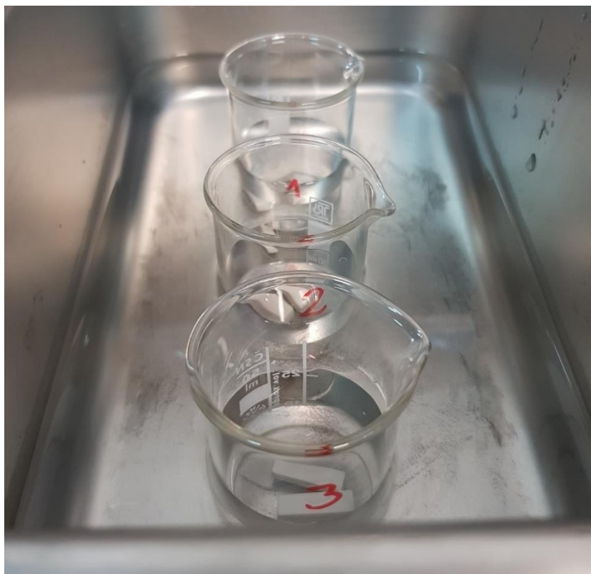
Slika 20. Čišćenje uzoraka u ultrazvučnom čistaču
