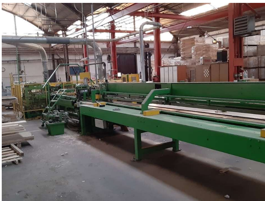
Slika 6-8 Stroj za izradu dužinskih lamela s cink-spojem
