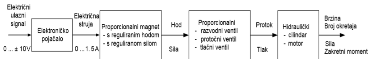
Slika 2. Otvoreni upravljački krug proporcionalnog hidrauličkog sustava [3]
