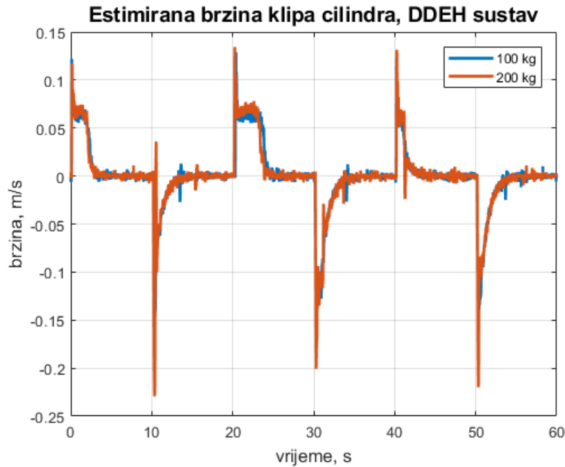
Slika 20. Estimirana brzina klipa cilindra za DDEH sustav
