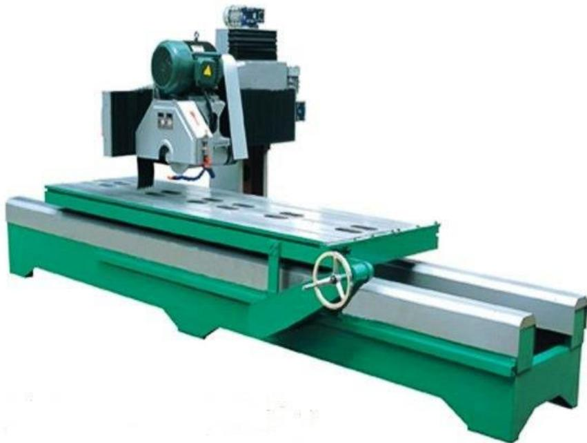
Slika 4. Konzolni stroj za rezanje kamena [7]
