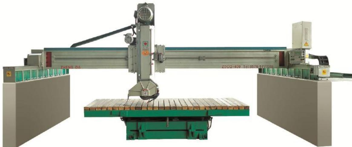
**Slika 5. Portalni stroj za rezanje kamena [7]**
