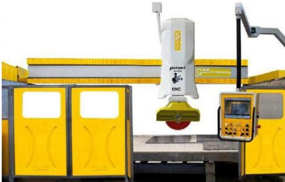
**Slika 6. Numerički upravljeni portalni stroj za rezanje kamenja [7]**
