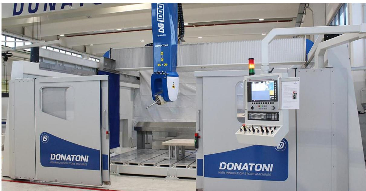
Slika 8. Više osni obradni centar za glodanje kamena [8]
