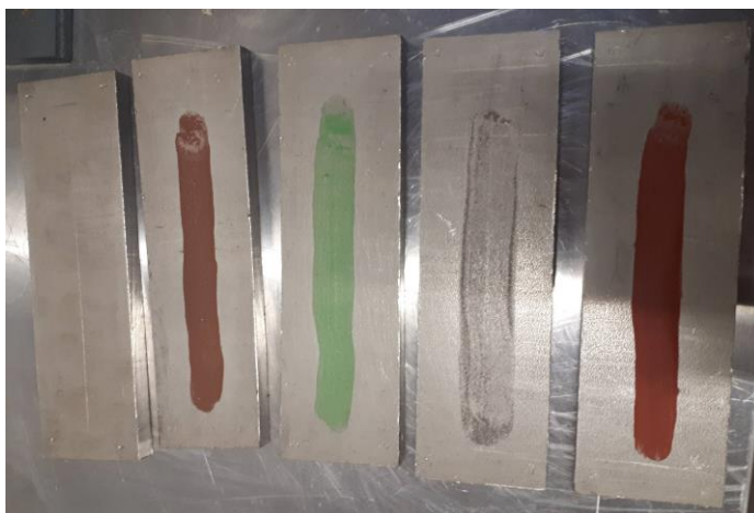
Slika 21. Pripremljeni uzorci s nanešenim aktivacijskim premazima
