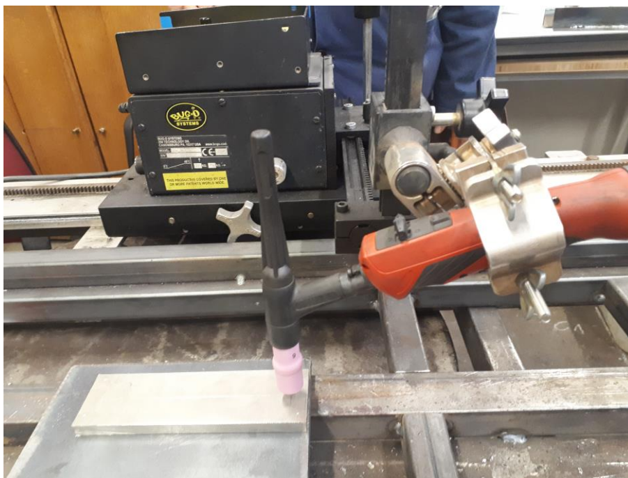
Slika 24. Priprema za navarivanje uzorka 1
