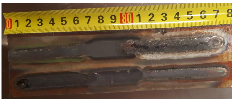
Slika 23. Probni navareni uzorak
