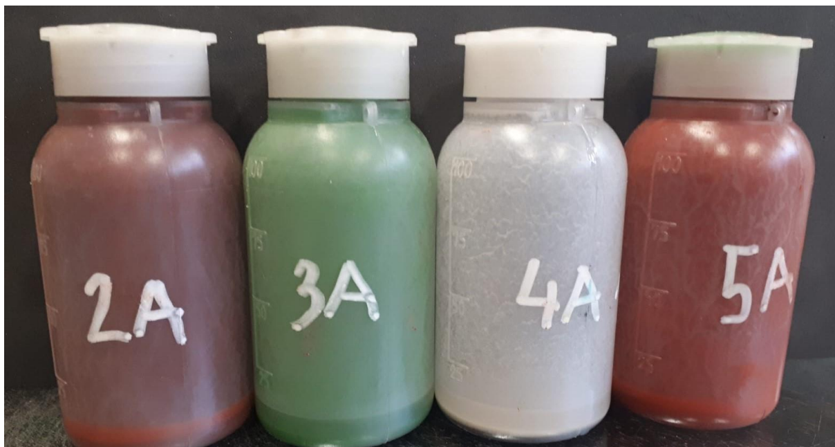
Slika 17. Pripremljeni aktivacijski –TIG premazi
