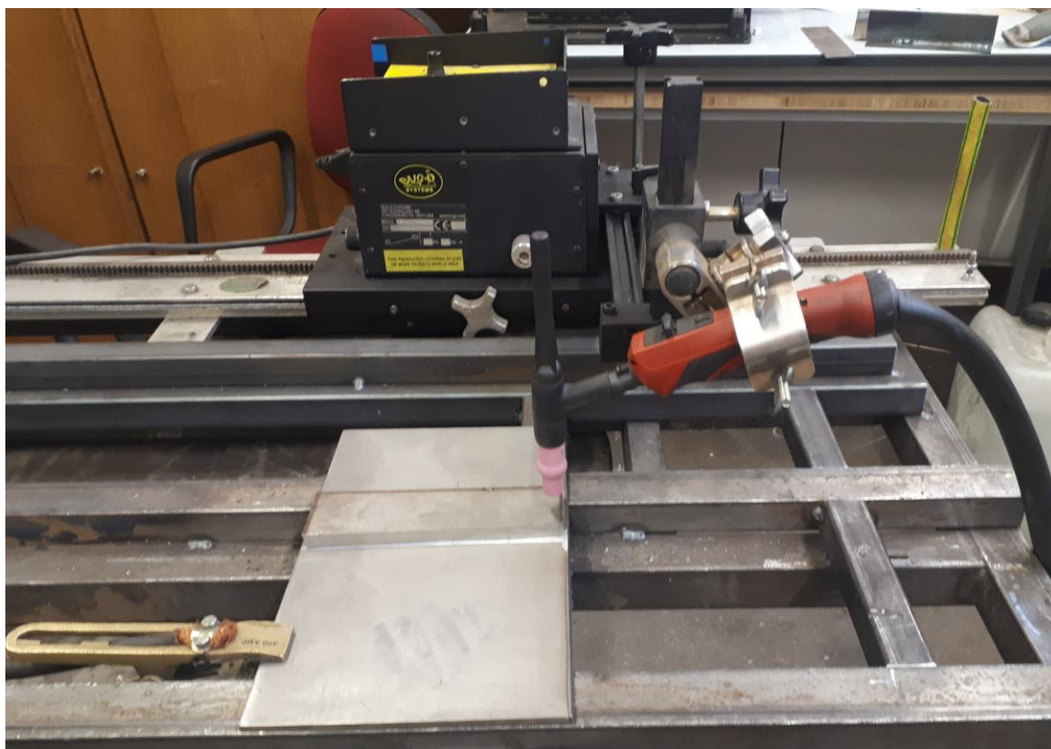
Slika 19. „Bugo Systems“, uređaj za automatiziranje postupka zavarivanja
