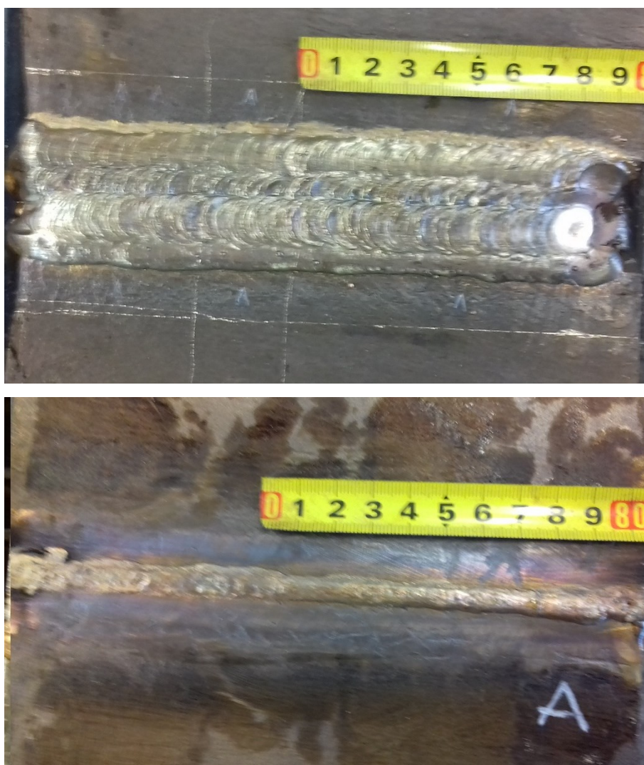
Slika 23. Lice i korijen zavara uzorka A
