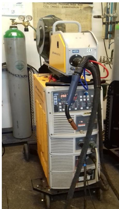
**Slika 20.** Izvor struje za zavarivanje *VARSTROJ Welbee 500L*
