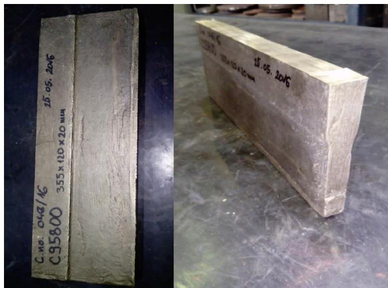
Slika 12. Osnovni materijal – odljevak CuAl10Fe5Ni5
