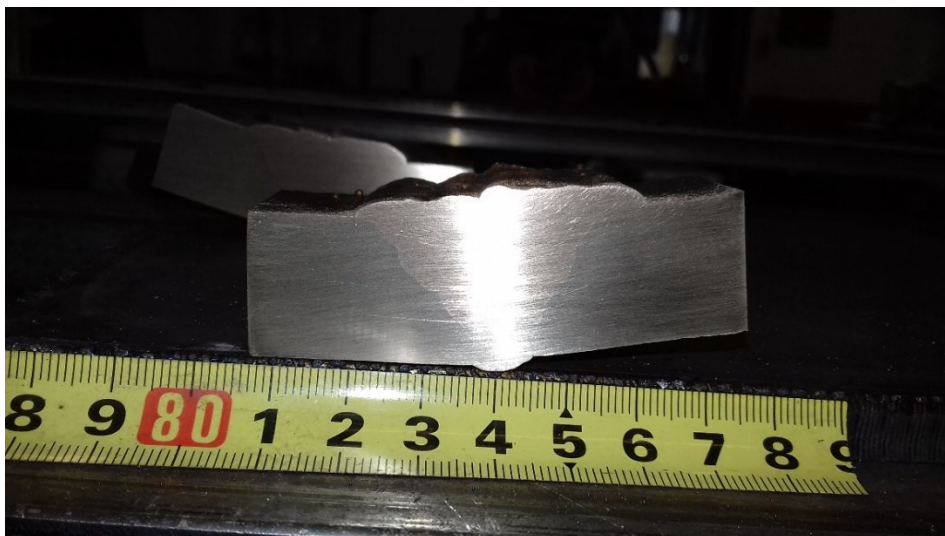
Slika 27. Makroizbrusci nakon brušenja i čišćenja
