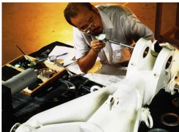
Slika 4. Servisni popravak stajnog trapa putničkog zrakoplova - ležajne čahure izrađene od Ni-Al bronce [5]
