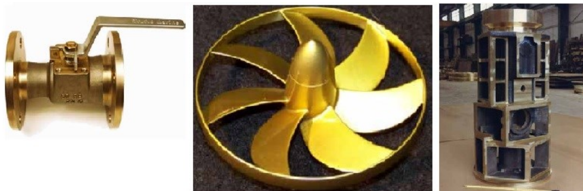
Slika 6. Brodski elementi: zaporni ventil; propeler podmornice i kućiše periskopa [5]
