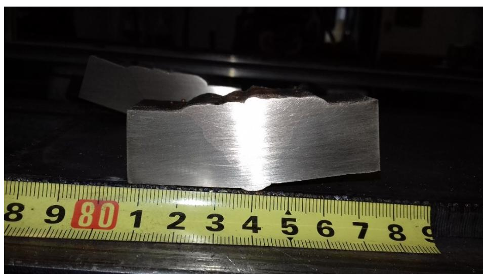
Slika 27. Makroizbrusci nakon brušenja i čišćenja
