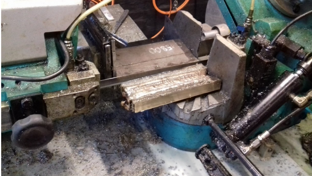
Slika 26. Rezanje ploča na tračnoj pili
