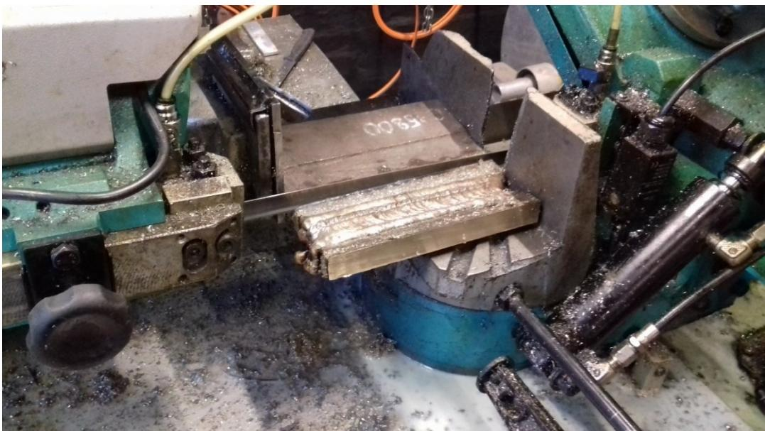
Slika 26. Rezanje ploča na tračnoj pili
