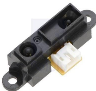
Slika 4. Senzor pomaka Sharp GP2Y0A41SK0F
