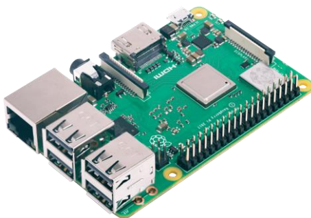
Slika 9. Raspberry PI 3B+
