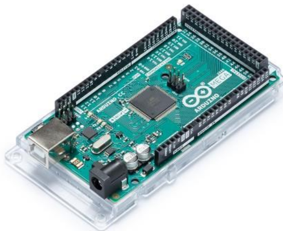
Slika 5. Mikrokontroler Arduino MEGA
