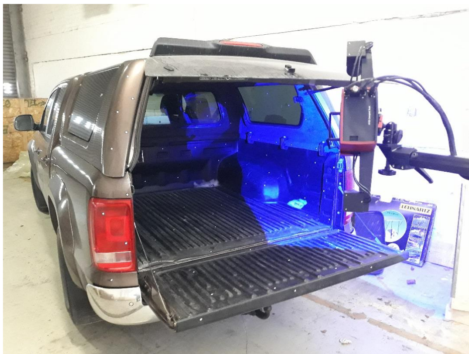
Slika 10. Postupak mjerenja 3D skenerom
