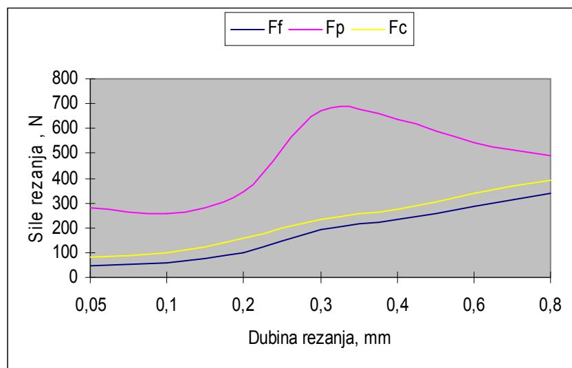
Slika 58. Sile rezanja u ovisnosti o dubini rezanja [30]
