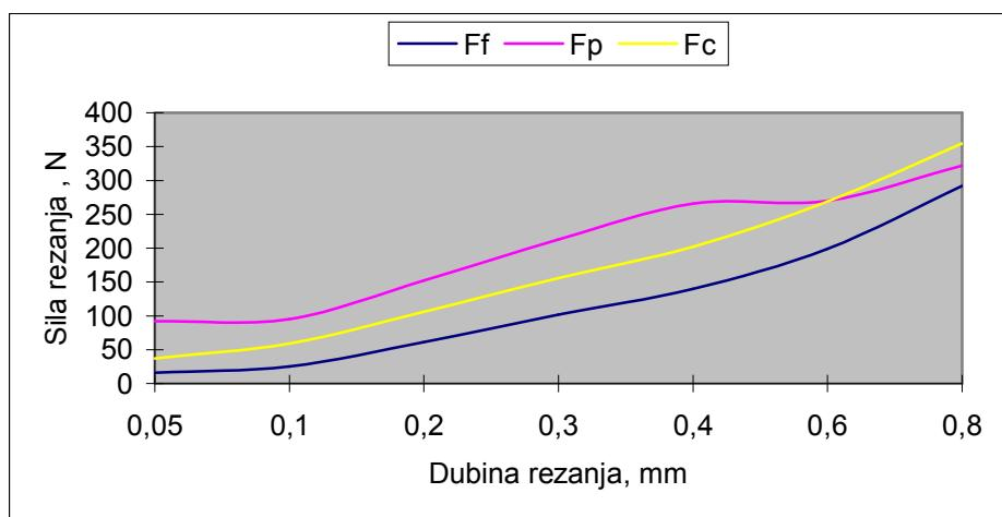
Slika 66. Sile rezanja u Pokusu B za 1.mjerene
