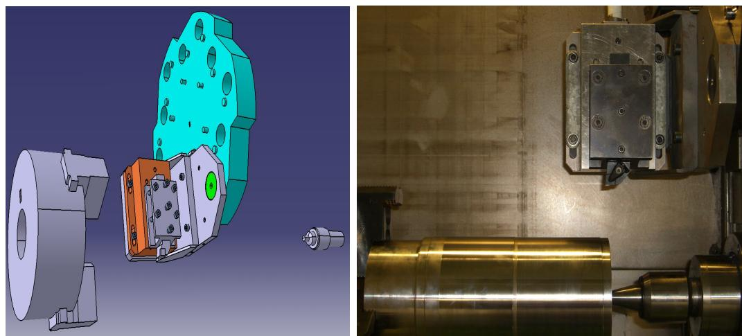
Slika 61. Sklop naprave i uređaja za mjerjenje sila rezanja
