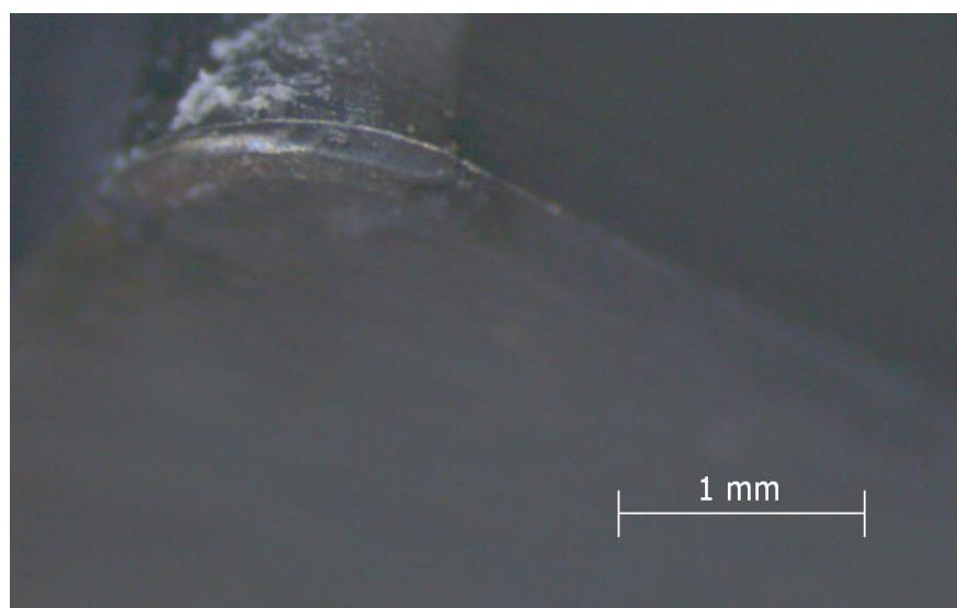
Slika 68. Izgled prve rezne oštice nakon prva tri mjerena
