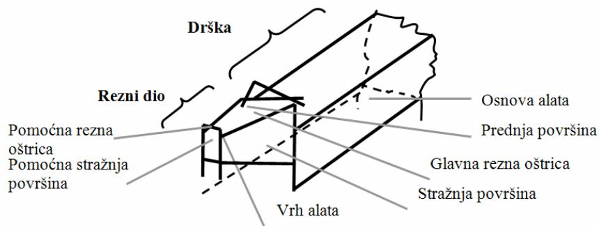
Slika 3. Osnovni elementi alata za rezanje [4]
