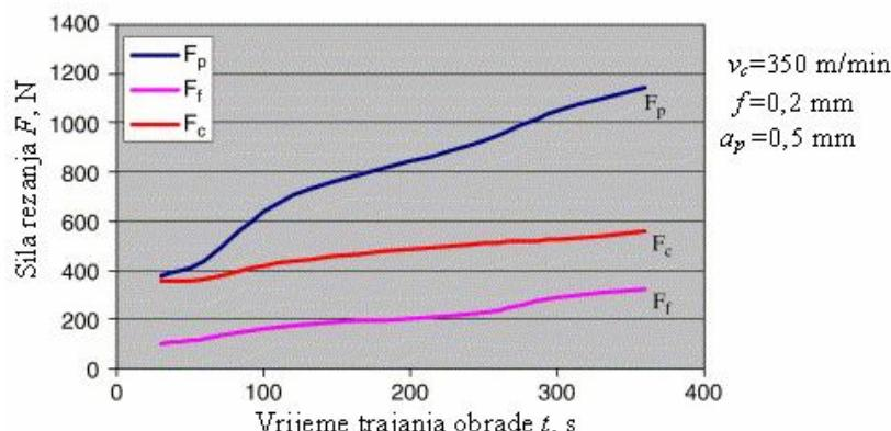
Slika 28. Utjecaj trošenja alata na sile rezanja pri obradi CBN pločicom sa TiN prevlakom [2]
