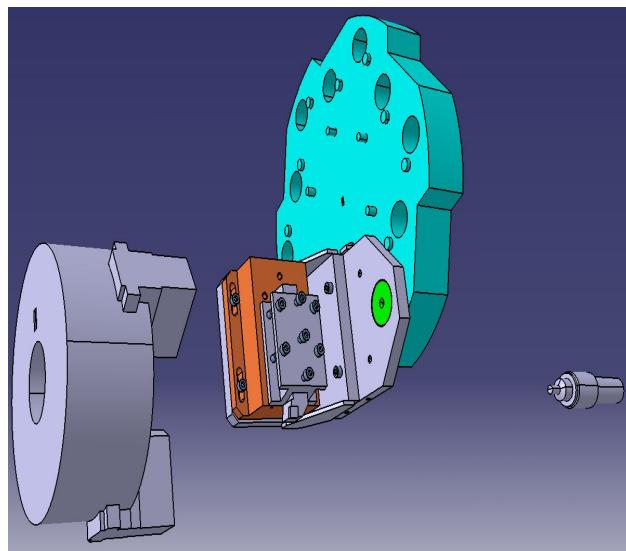
Slika 56. Izvedeni sklop za mjerjenje sila tokarenja.
