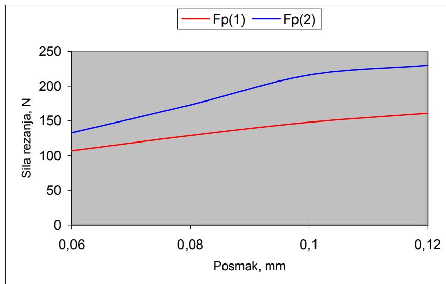
Slika 71. Ovisnost natražne sile rezanja  $F_p$  o posmaku za 1.i 2.mjerjenje
