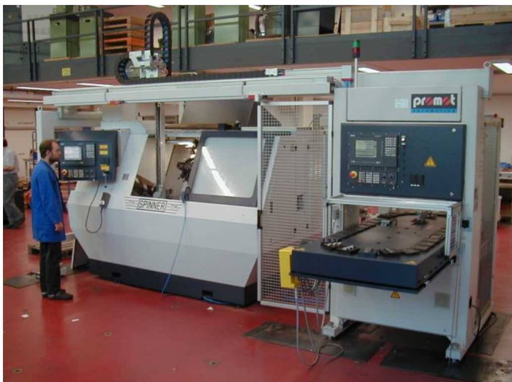
Slika 49. Horizontalna obradna ćelija proizvođača Spinner [27]
