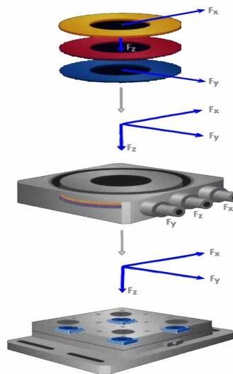
Slika 52. Senzori za mjerjenje sile [28]
