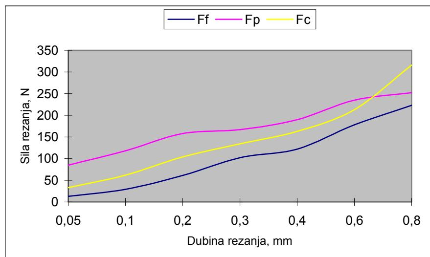
Slika 65. Sile rezanja u Pokusu B za 2.mjerjenje
