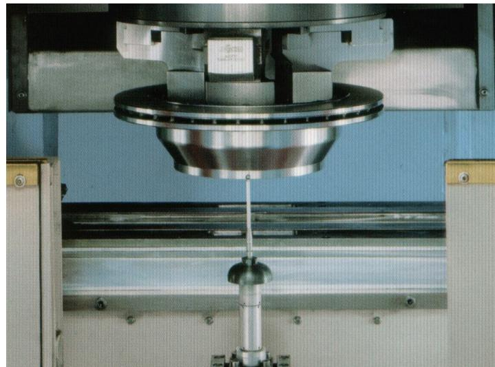
Slika 48. Mjerenje izradaka na TOĆ-u
