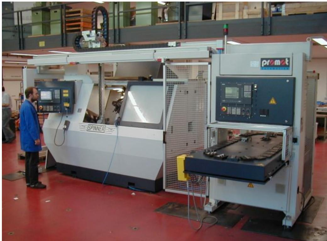
Slika 49. Horizontalna obradna ćelija proizvođača Spinner [27]
