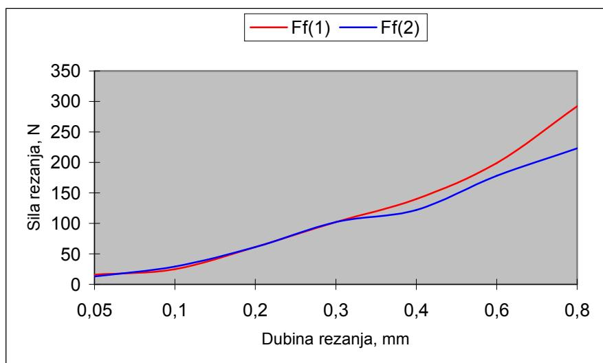
Slika 75. Ovisnost posmične sile rezanja  $F_f$  o dubini rezanja za 1. i 2.mjerjenje
