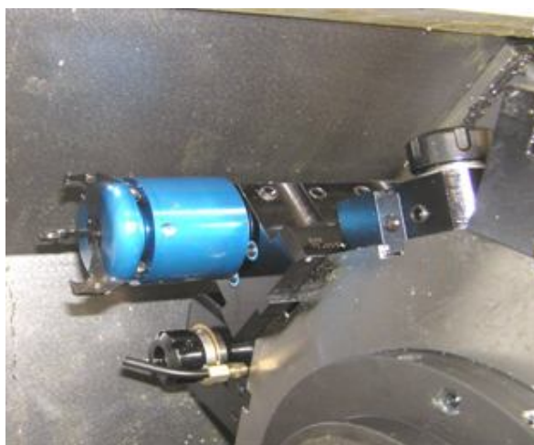
Slika 37. Uređaj za izvlačenja šipkastog materijala [21]
