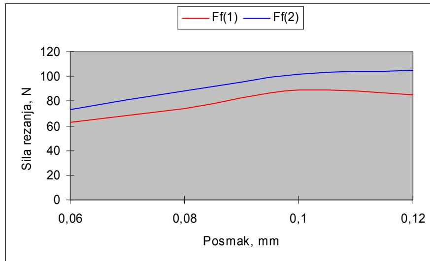
Slika 72. Ovisnost posmične sile rezanja  $F_f$  o posmaku za 1. i 2.mjerenje
