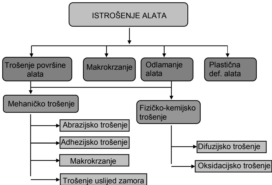
Slika 12. Prikaz osnovnih oblika trošenja [5]
