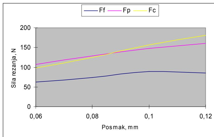
Slika 62. Sile rezanja u Pokusu A za 1. mjerjenje
