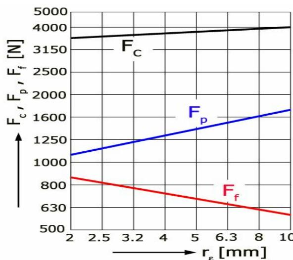
Slika 19. Utjecaj zaobljenja vrha alata  $r_\varepsilon$  na sile rezanja [14]
