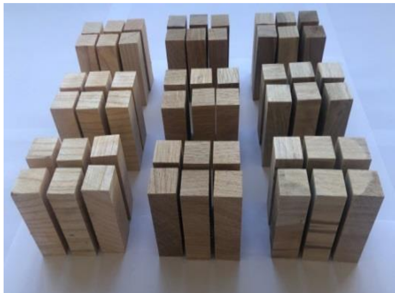
Slika 4.2 Ispitni uzorci triju vrsta drva – jasen, hrast, orah
