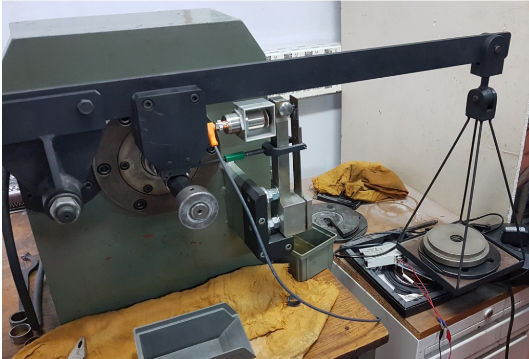
Slika 22 Uređaj za ispitivanje adhezijskog trošenja
