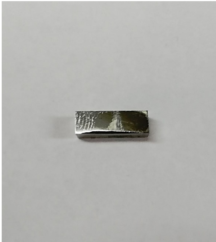
Slika 19 Izrezani uzorka WC-15Co
