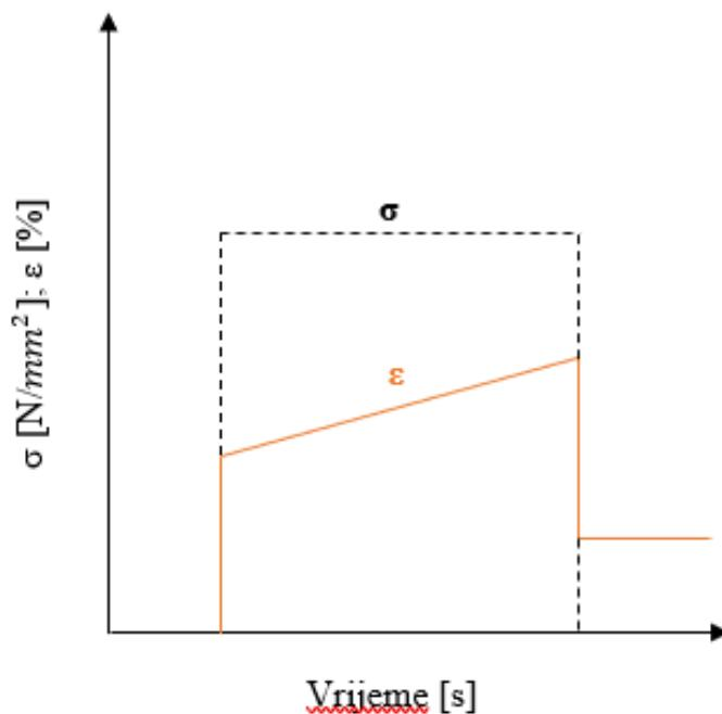
**Slika 4. Maxwellov model; odziv istezanja za  $\sigma = \text{konst.}$**
