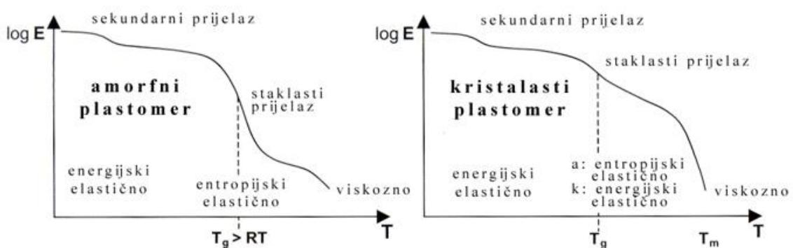
**Slika 3. Krivulja koja prikazuje elastična svojstva amorfног (lijevo) i kristalastog (desno) plastomera [12]**
