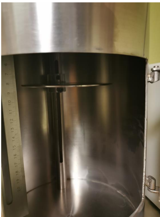
Slika 13. Unutrašnjost uređaja za UV zračenje; skala udaljenosti od lampe
