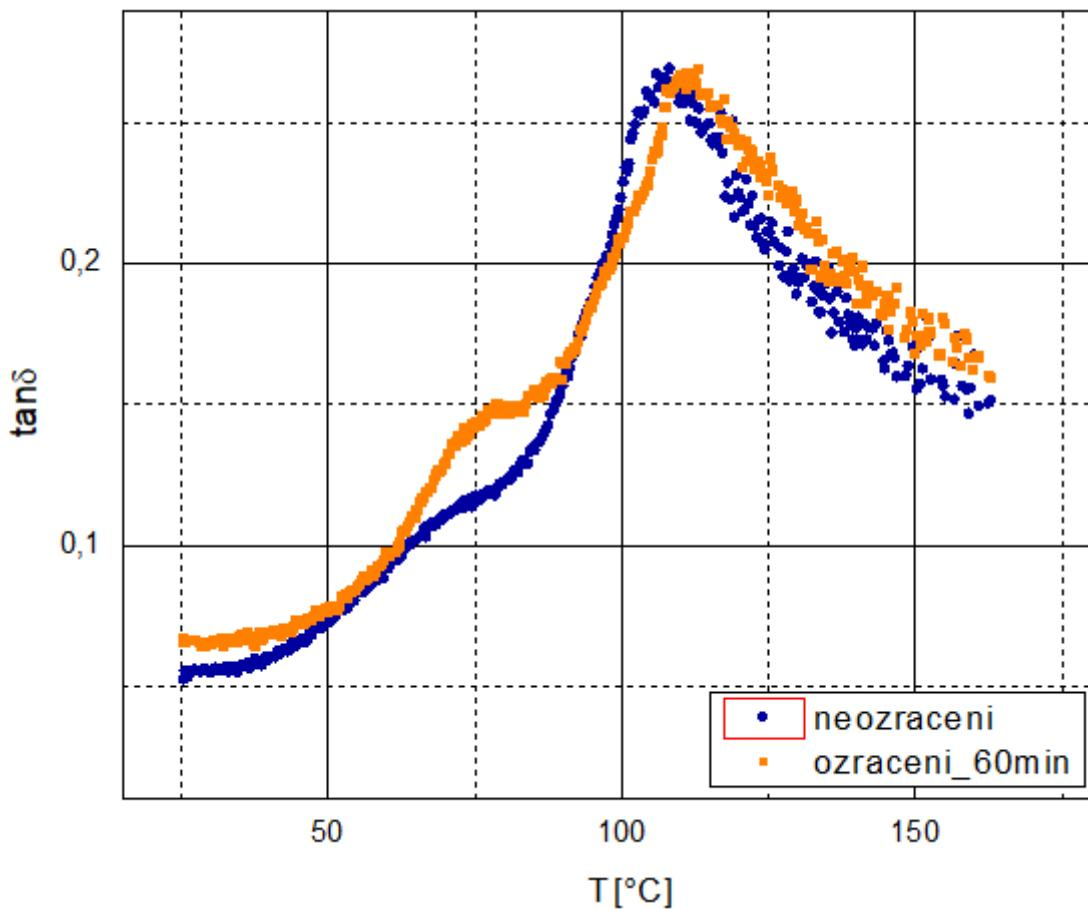
**Slika 24. Mehanički spektri neozračene PVA folije i 60 minuta zračene PVA folije**
