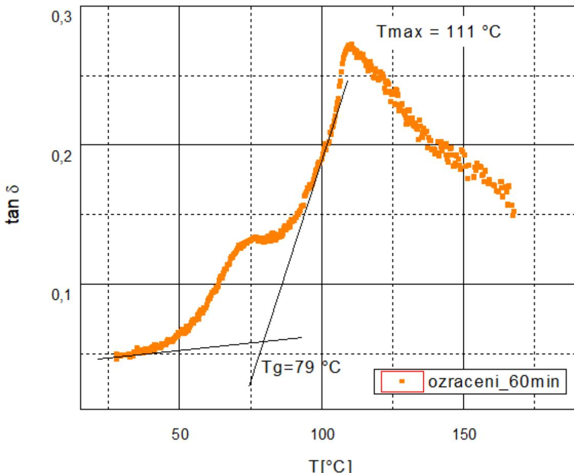
**Slika 22. Mehanički spektar PVA folije zračene 60 minuta**
