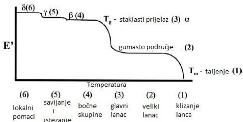
**Slika 7. Idealni spektar DMA (krivulja ovisnosti modula pohrane  $E'$  o temperaturi);
