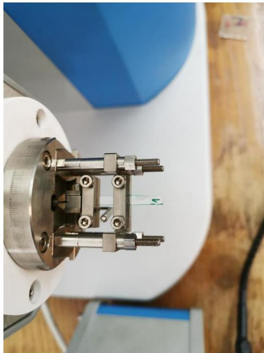
Slika 17. Prihvati folije (uzorak 1) u čeljustima DMA uređaja
