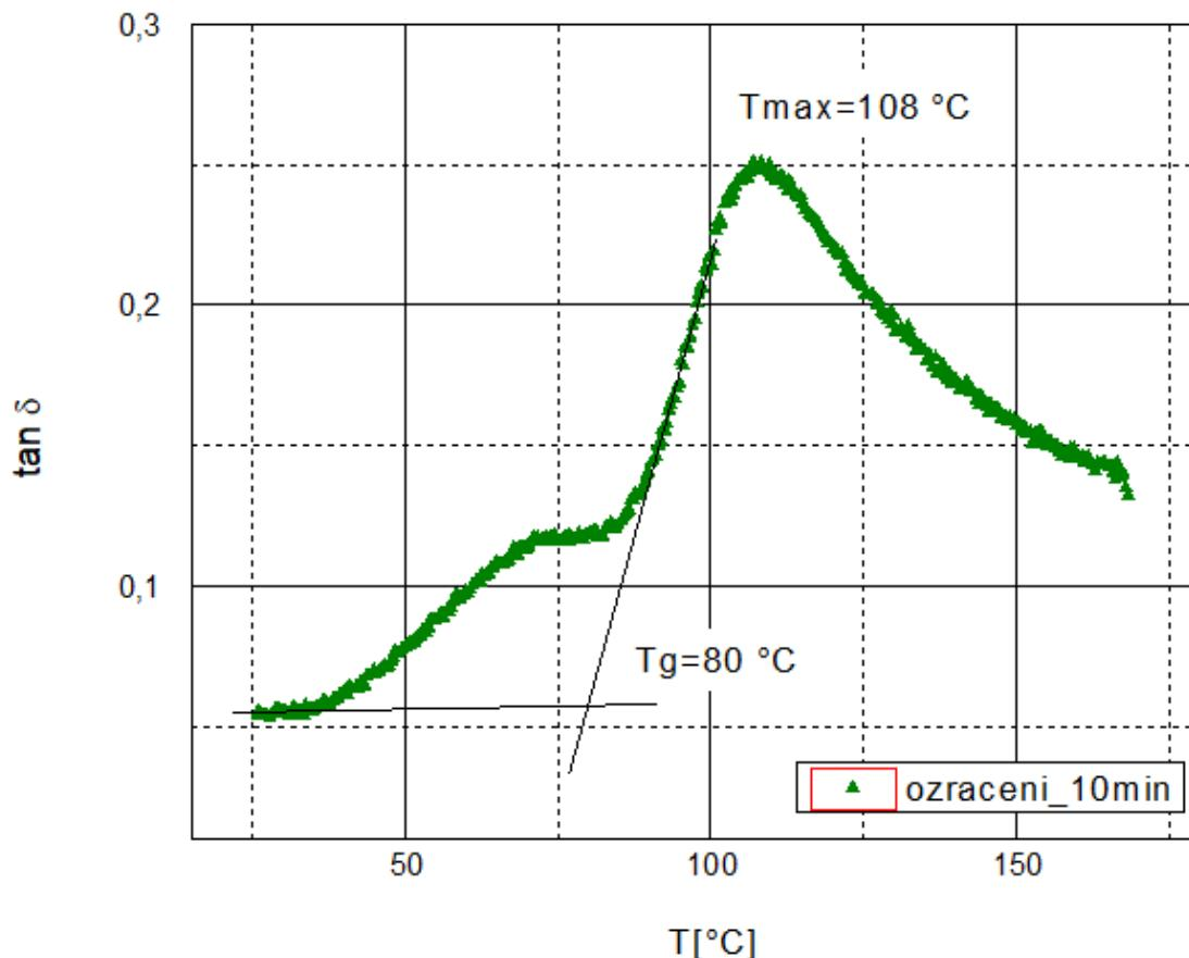
**Slika 20. Mehanički spektar PVA folije zračene 10 minuta**
