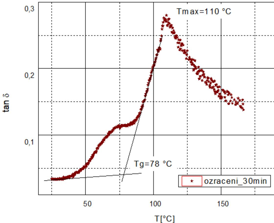
**Slika 21. Mehanički spektar PVA folije zračene 30 minuta**
