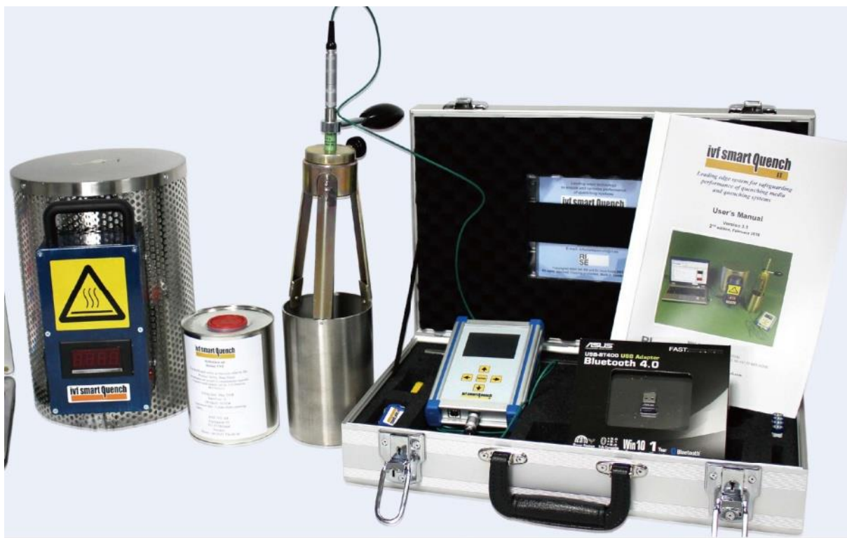
Slika 11. IVF Smart Quench sustav za mjerenje pri ispitivanju krivulja ohlađivanja prema normi ISO 9950 [10]
