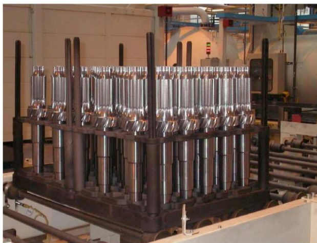
Slika 8. Šarža prijenosnih osovina kamiona [9]
