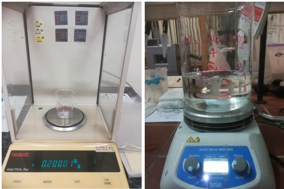
Slika 19. Vaga „Ohaus, Analytical plus“ (lijevo), Uređaj za miješanje (desno)
