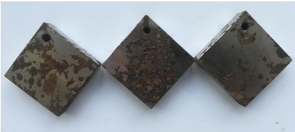
Slika 35. Uzorci nakon ispitivanja u kiseloj kiši
