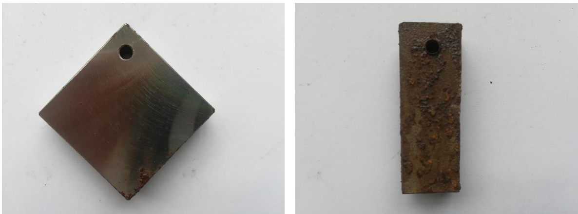
Slika 39. Uzorak ispitan u morskoj atmosferi bez uranjanja (lijevo), nepoglodan uzorak ispitan u morskoj vodi (desno)
