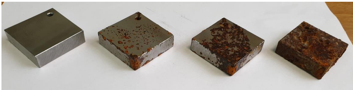
Slika 42. 1-Početni uzorak, 2-Uzorak ispitan u destiliranoj vodi, 3-Uzorak ispitan u kiseloj kiši, 4-Uzorak ispitan u morskoj vodi
