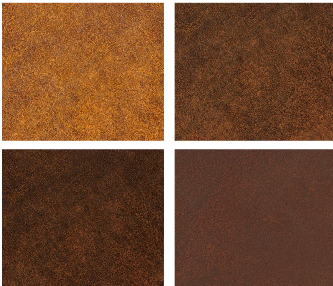
Slika 4. Izgled površine Corten čelika nakon 2 mjeseca (gore lijevo), nakon 4 – 6 mjeseci (gore desno), nakon 12 – 18 mjeseci (dolje lijevo), nakon posebnog tretmana površine „Anti-washout“ (dolje desno) [14]
